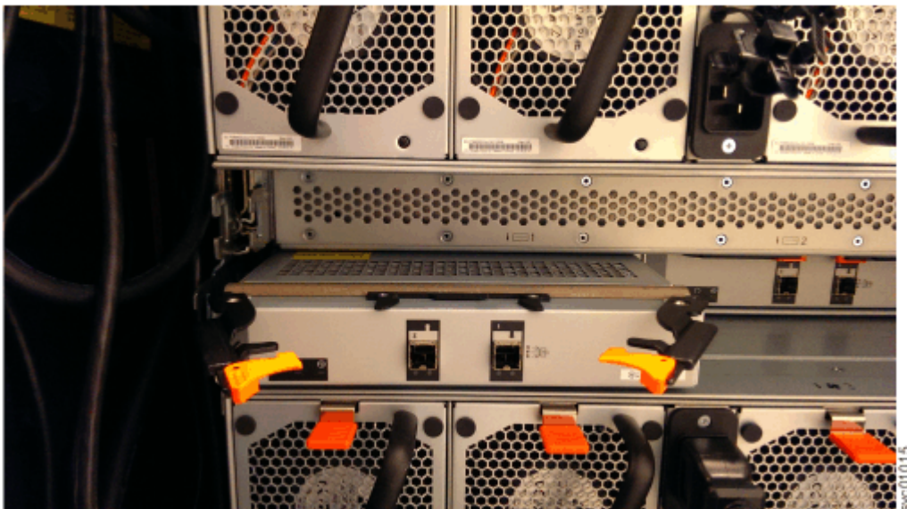
Figura 119. Removendo a caixa de expansão
