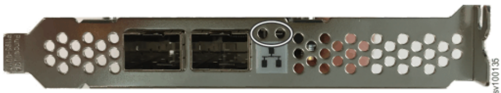
Figura 12. LEDs e portas Ethernet de 25 Gbps do adaptador da interface do host (iWARP)
