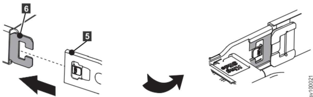
Figura 30. Instalar o outro membro externo
