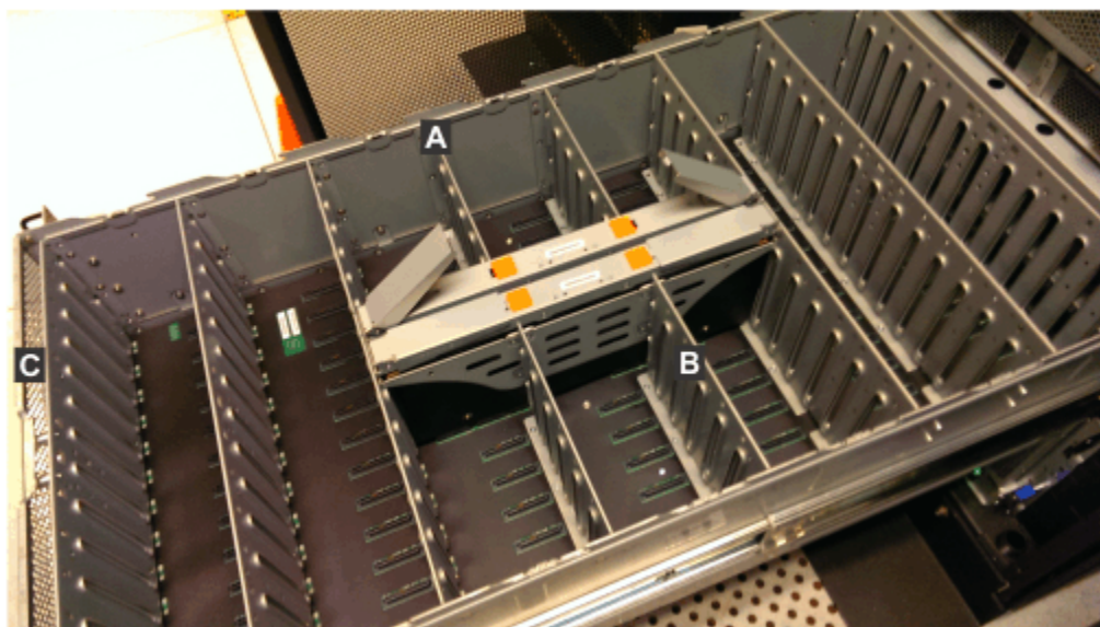
Figura 86. Local dos módulos do expansor secundário
