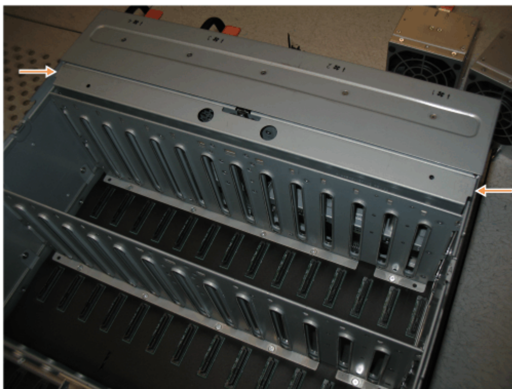
Figura 124. Local da tampa da FIB
