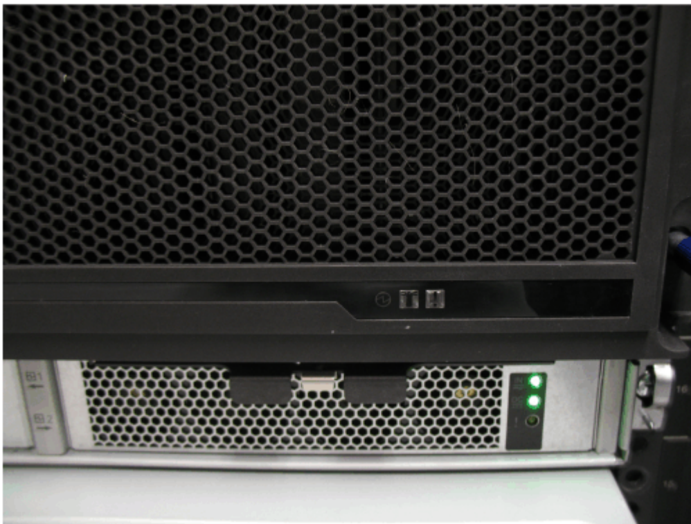
Figura 97. Fachadas removidas das PSUs
