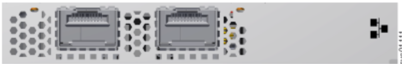
Figura 11. LEDs e portas Ethernet de 25 Gbps do adaptador da interface do host (RoCE)
