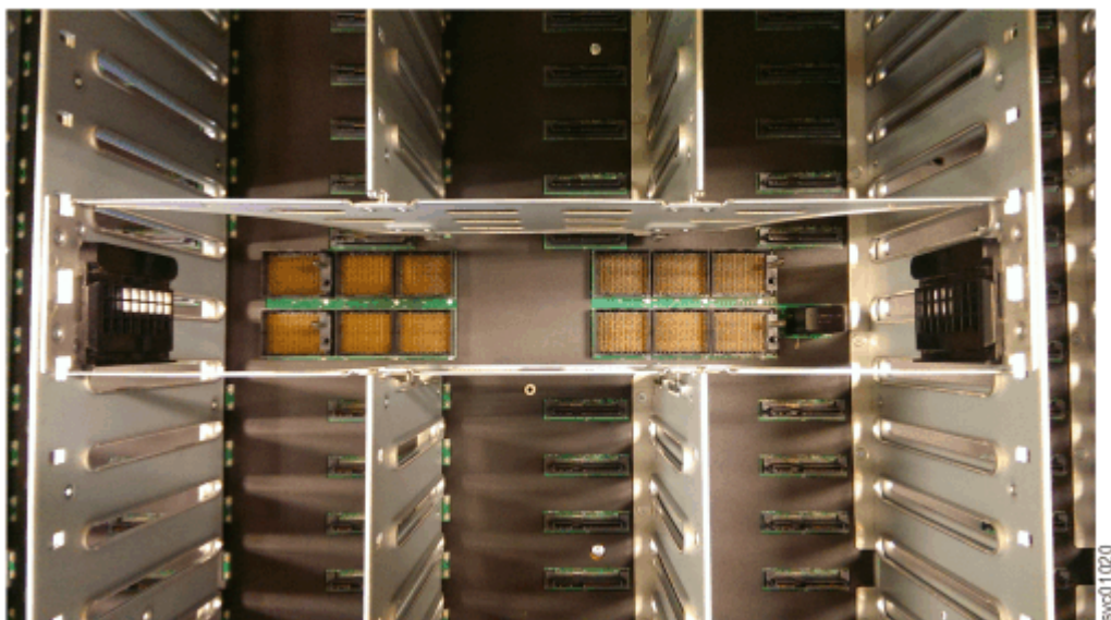
Figura 116. Conectores do módulo do expensor secundário
