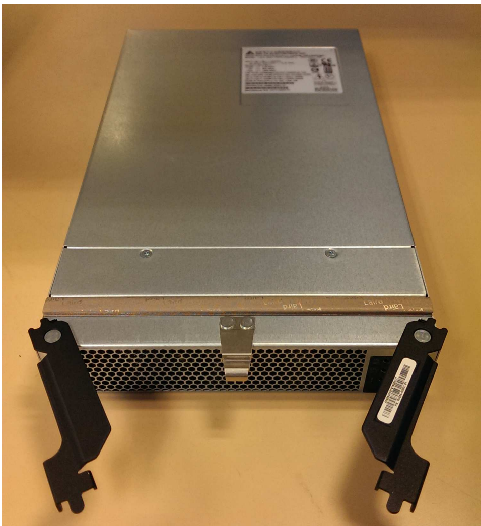
Abbildung 82. Installation des Netzteils vorbereiten
