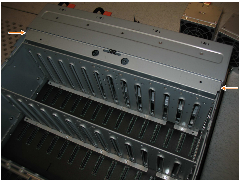
Abbildung 113. Position der Abdeckung der Lüfterschnittstellenplatine
