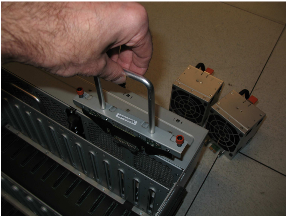
Abbildung 93. Neue Lüfterschnittstellenplatine in Chassis einsetzen
