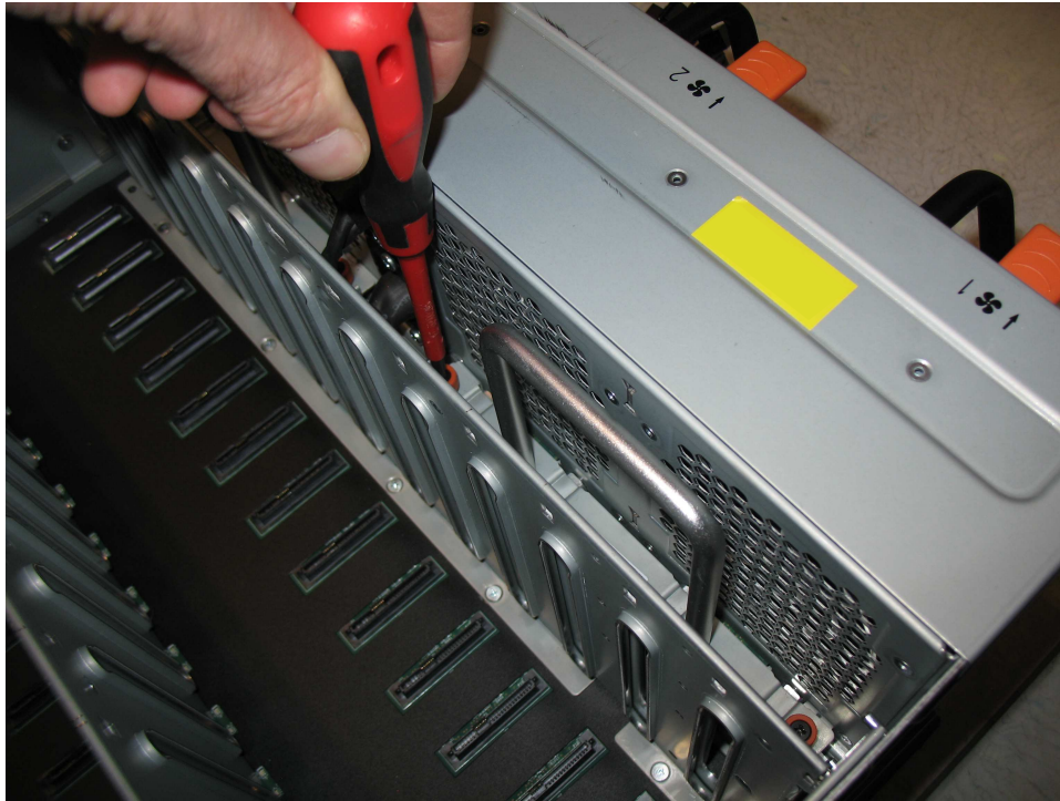
Abbildung 94. Lüfterschnittstellenplatine an Laufwerkplatine befestigen
