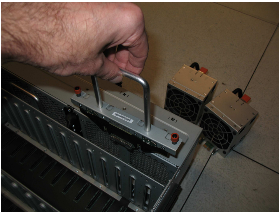
Figure 115. Retirez la FIB du châssis
