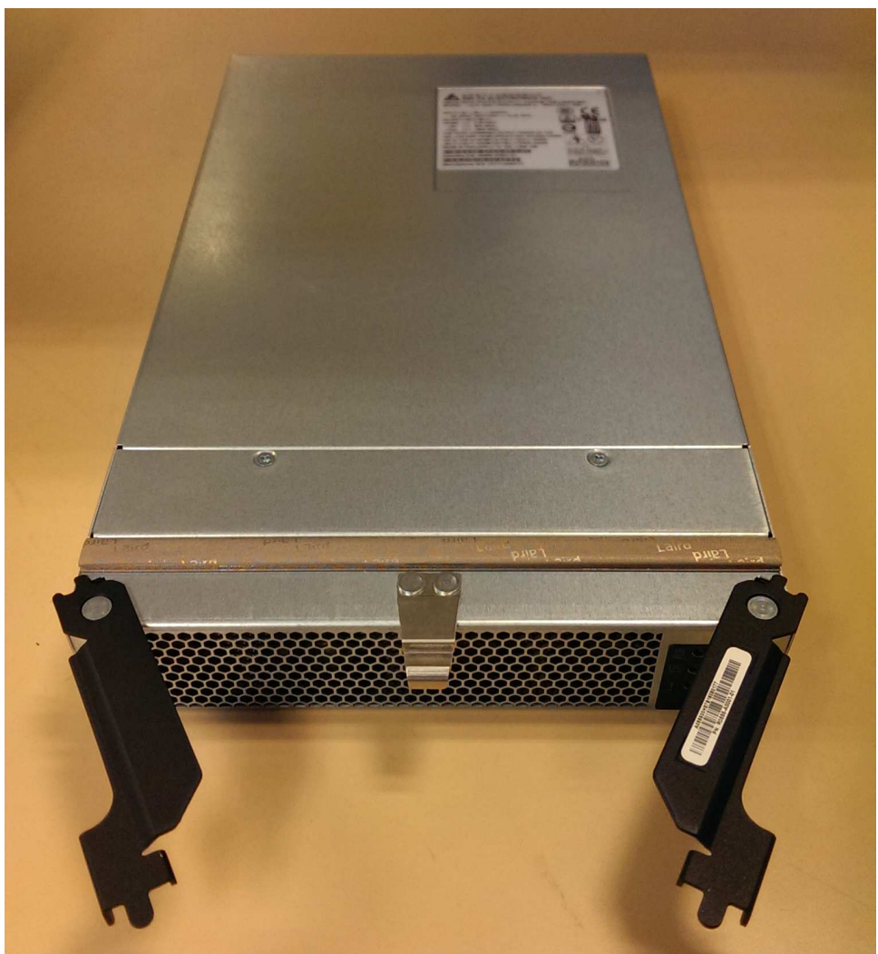
Figure 82. Préparation de l'installation de l'alimentation électrique
