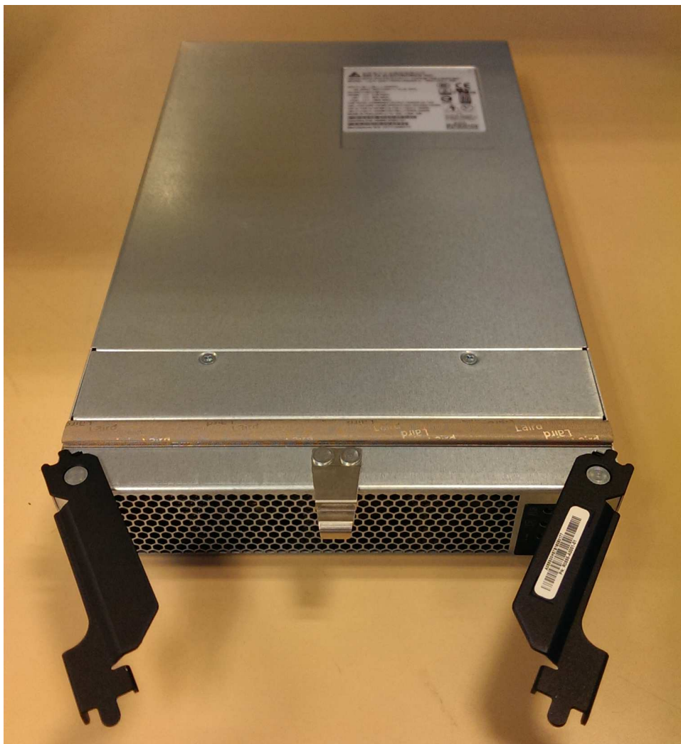
Figure 98. Alimentation électrique retirée
