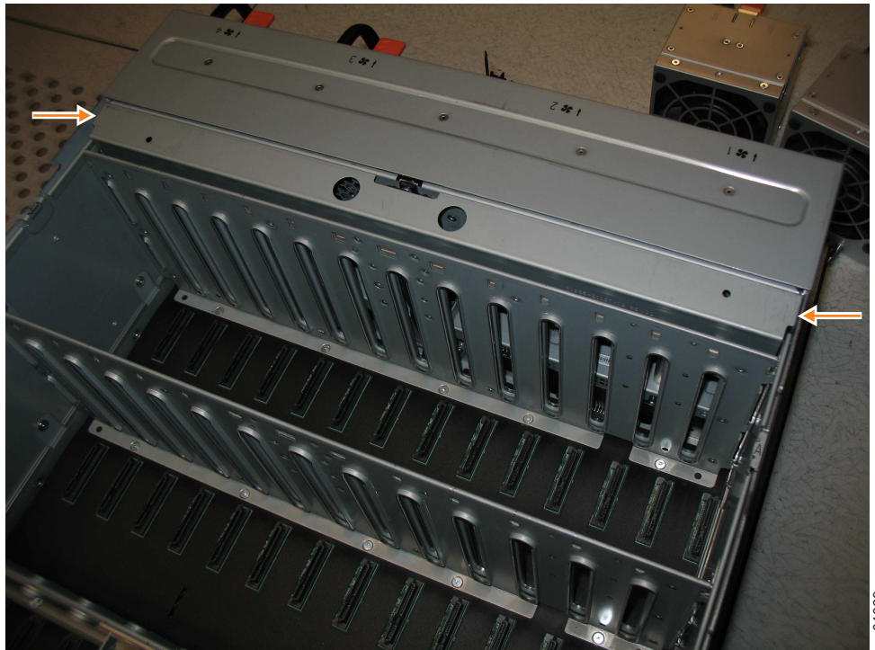
Figure 113. Emplacement du capot de la FIB
