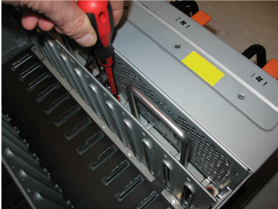
Figure 94. Fixation de la FIB sur la carte mère de l'unité
