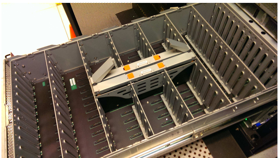
Figure 102. Emplacement des modules d'extension secondaires
