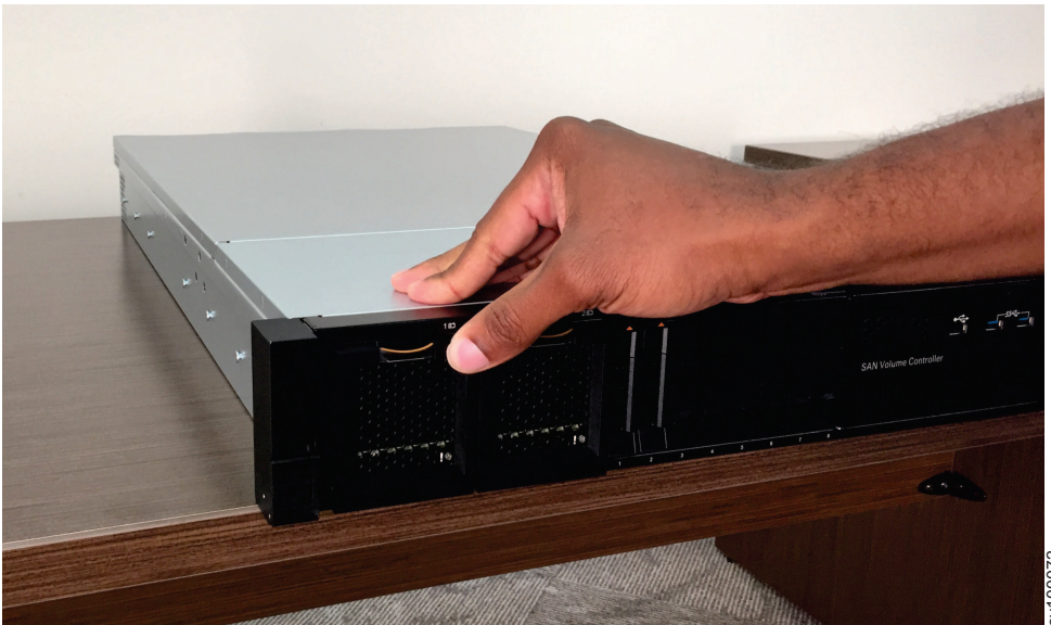
図 180. バッテリーのリリース・ハンドルを閉じる
