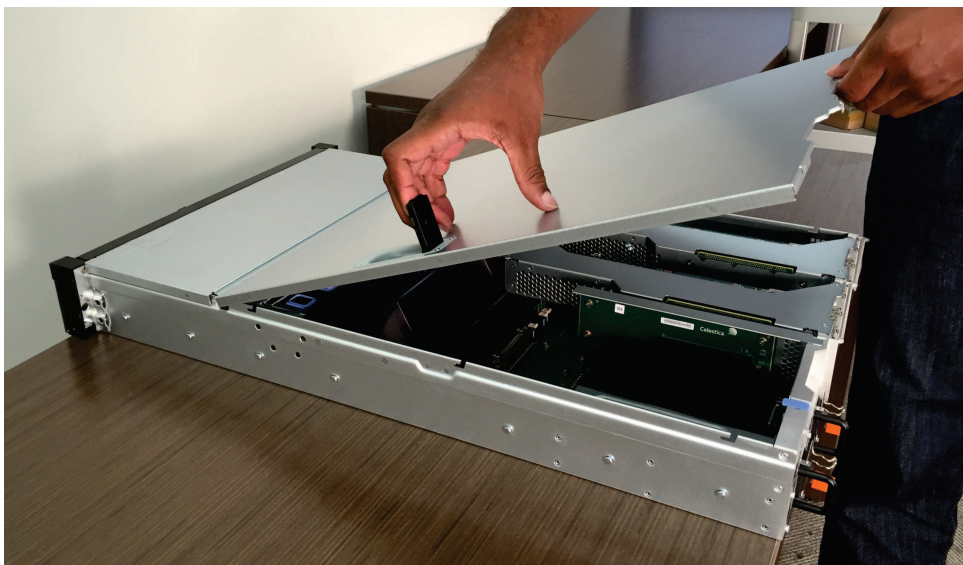
図 73. 2145-SV1 背面カバーの取り外し
