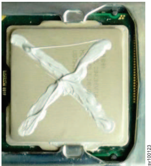
図 300. 2145-SV1 マイクロプロセッサへの熱伝導グリースの塗布
