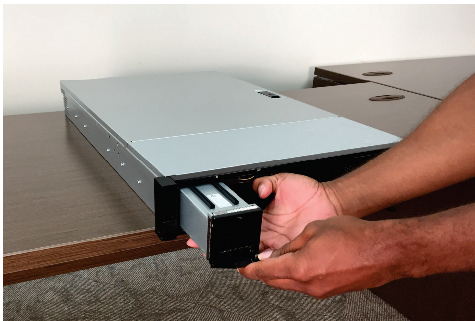
図 179. 2145-SV1 ノードのバッテリーの交換
