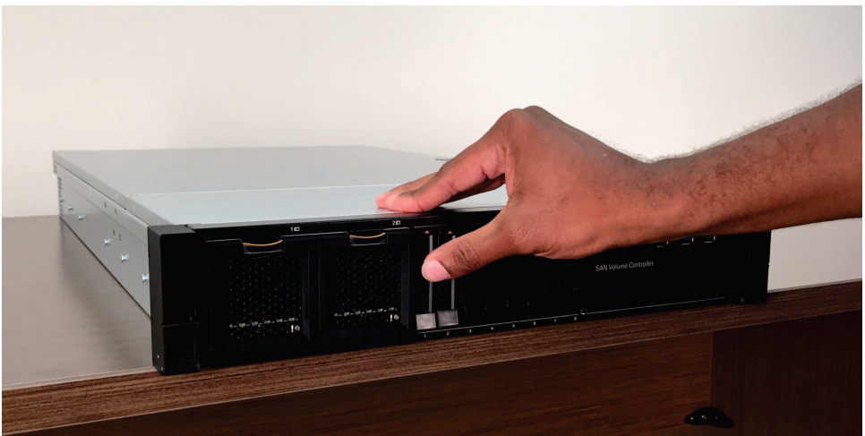
図 129. 2145-SV1 ブート・ドライブのリリース・ハンドルを閉じる
