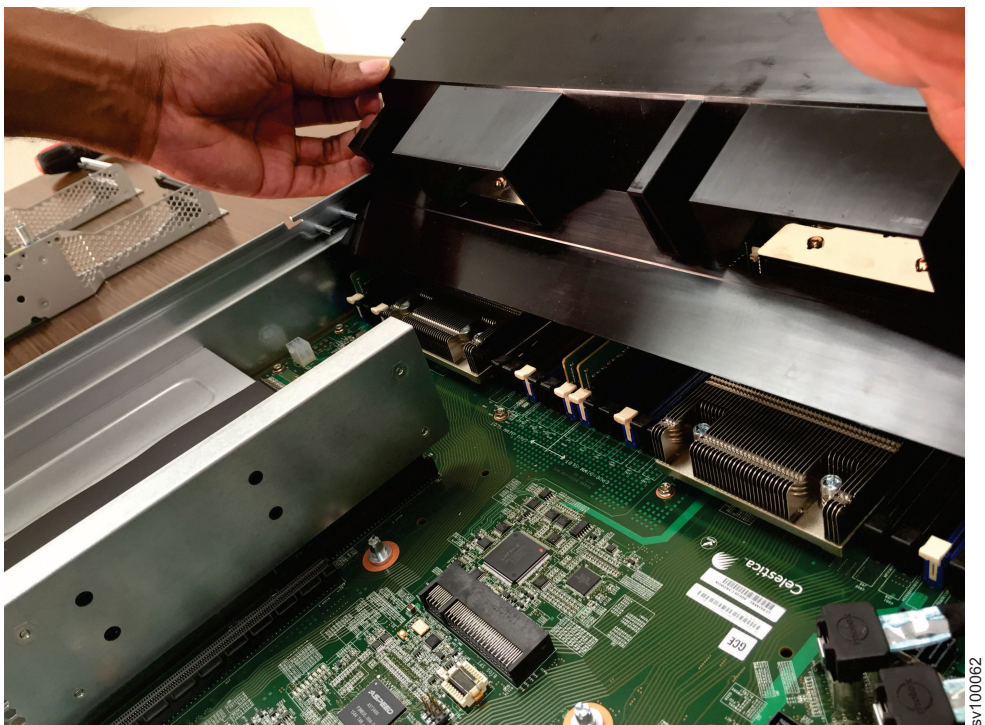
図 82. エア・バッフルの取り外し
