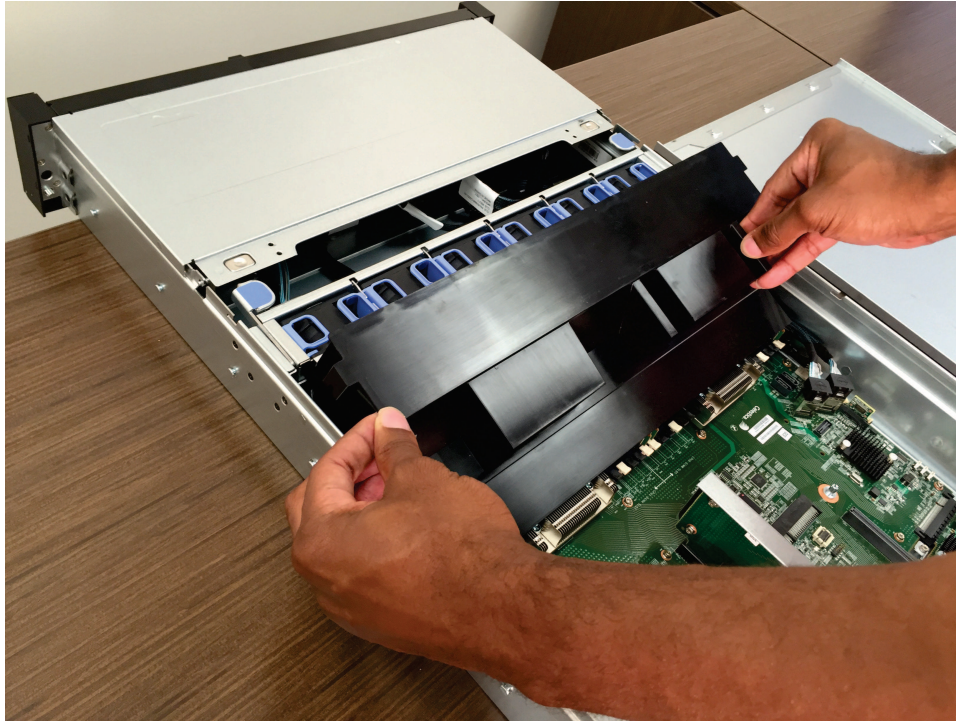
図 81. エア・バッフルの取り外し
