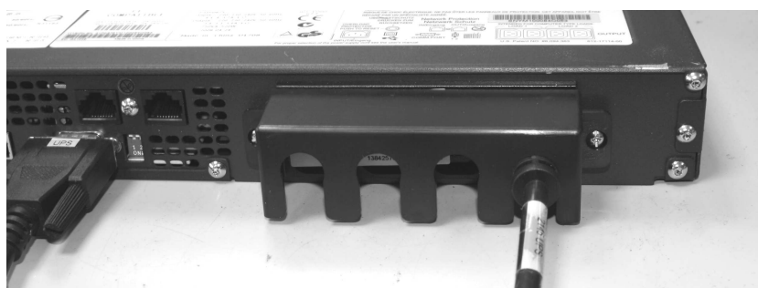
図 347. 2145 UPS-1U に接続された 2145 UPS-1U のケーブル保持ブラケット
