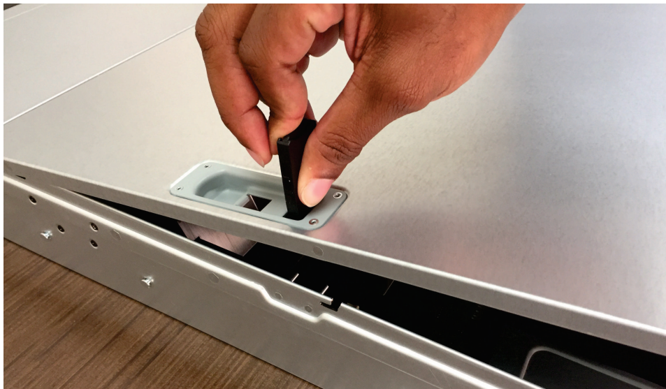
図 78. 2145-SV1 の背面カバーの再取り付け
