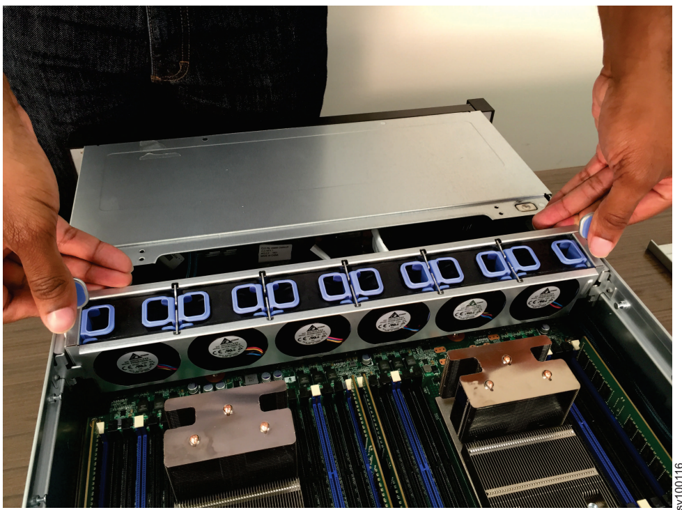
図 286. ファン・ブラケットの再取り付け
