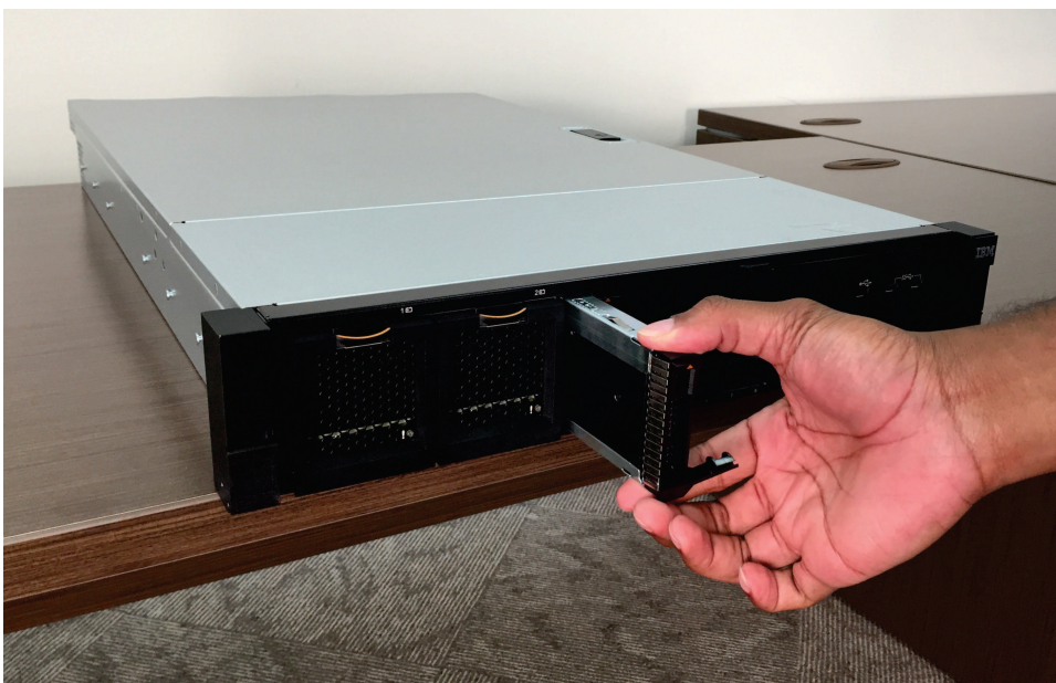
図 121. 2145-SV1 ブート・ドライブの取り外し
