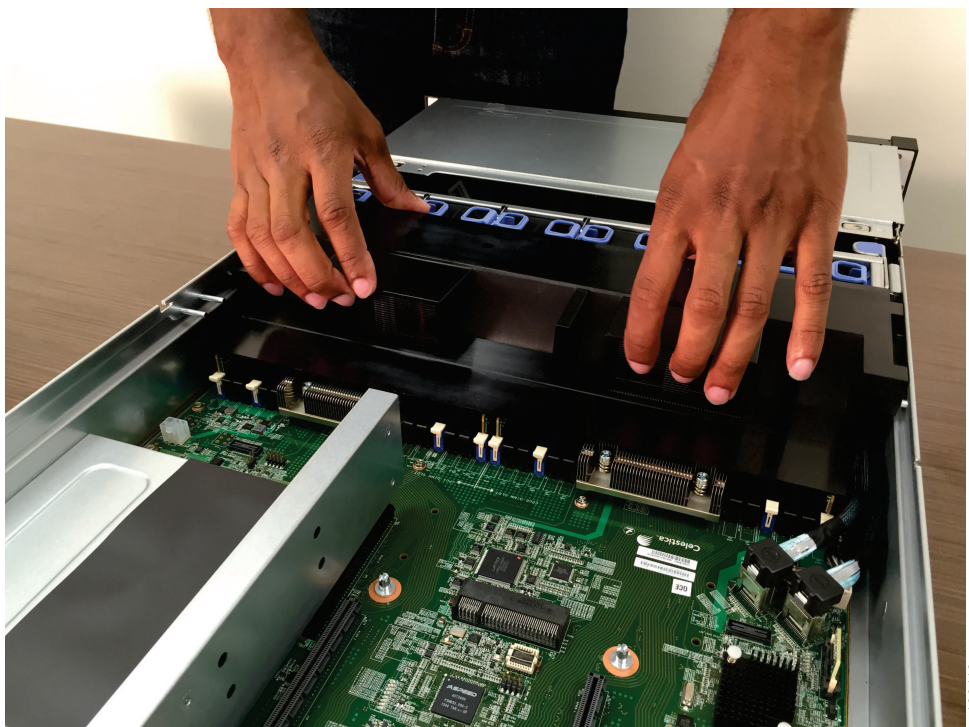
図 85. エア・バッフルの交換
