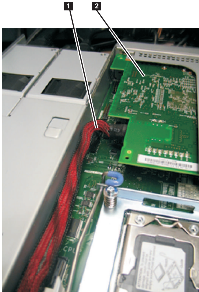
図 228. SAN ボリューム・コントローラー 2145-CG8 または 2145-CF8 内の高速 SAS アダプター・アセンブリーおよび高速 SAS ケーブル
