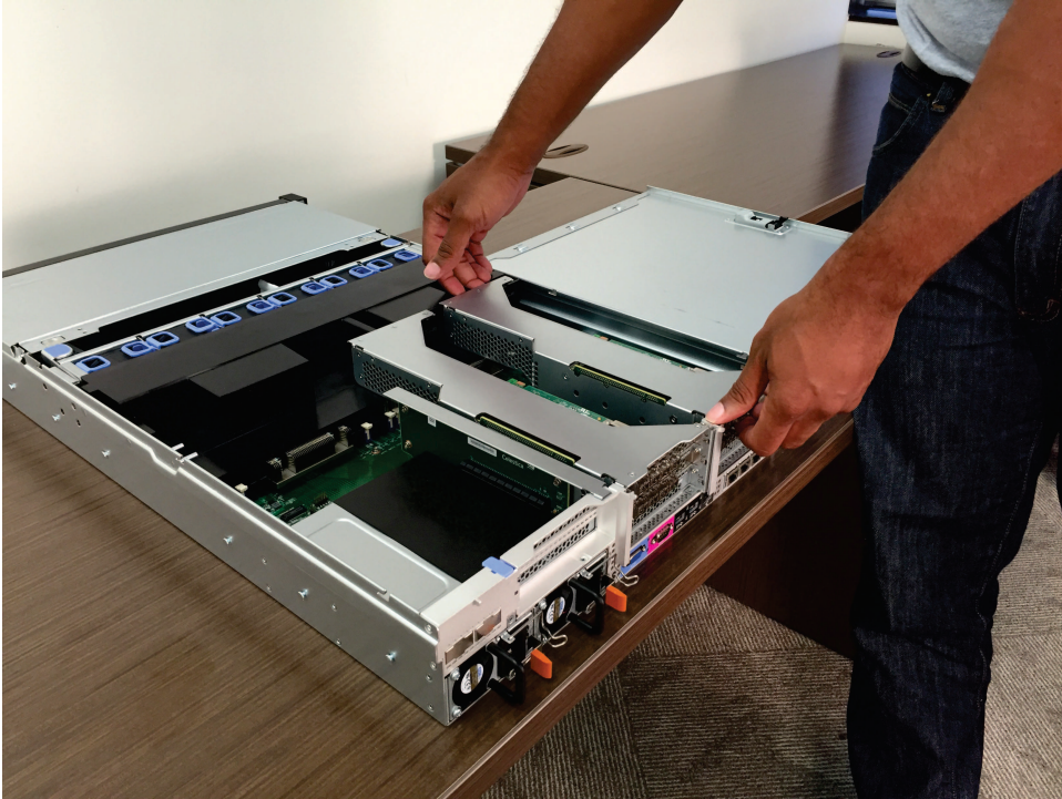
図 238. PCI ライザー・カード・アセンブリー 1 をつかむ
