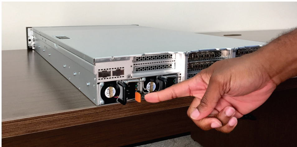
図 196. 2145-SV1 電源機構の解放
