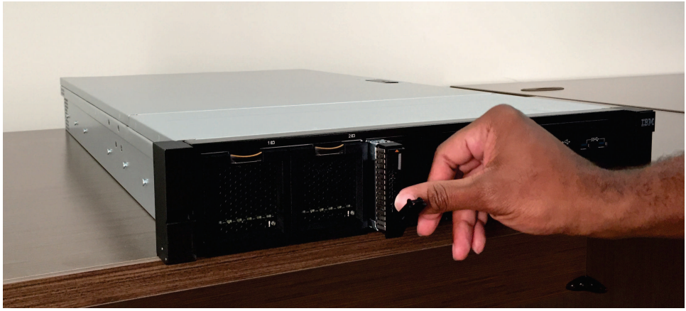
図 128. 2145-SV1 ブート・ドライブの交換
