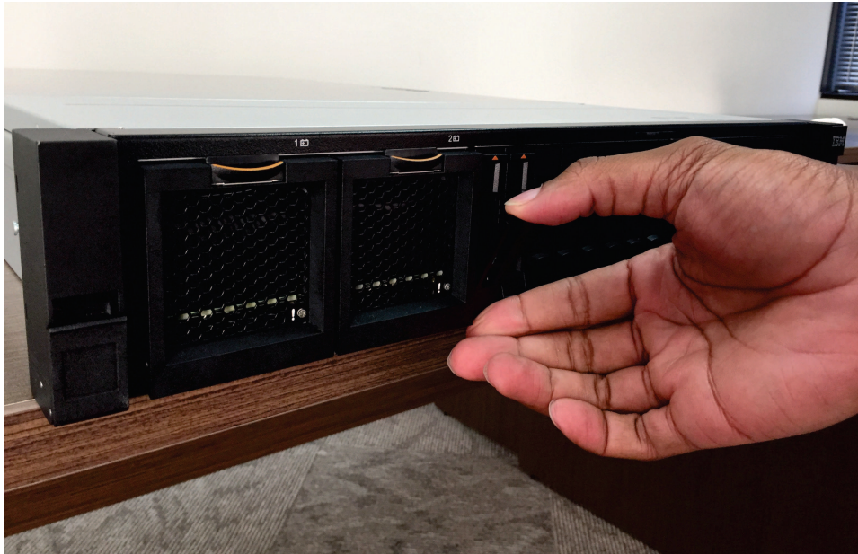
図 120. 2145-SV1 ブート・ドライブのリリース・ハンドルの操作
