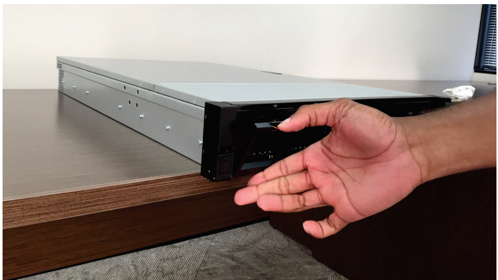
図 176. 2145-SV1 ノードのバッテリー・モジュールの取り外し
