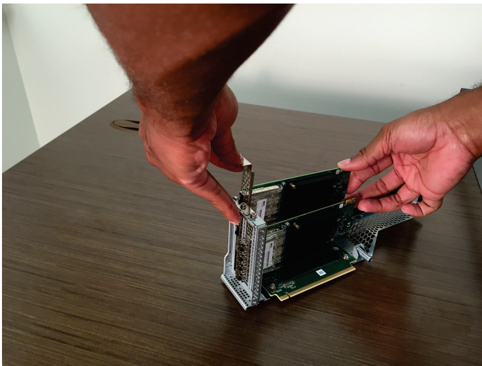
図 249. PCI コネクターへのアダプターの挿入
