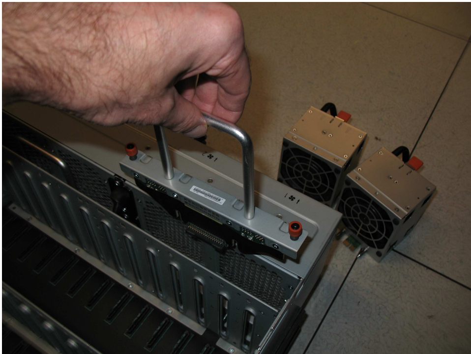
図 93. シャーシへの新規 FIB の装着
