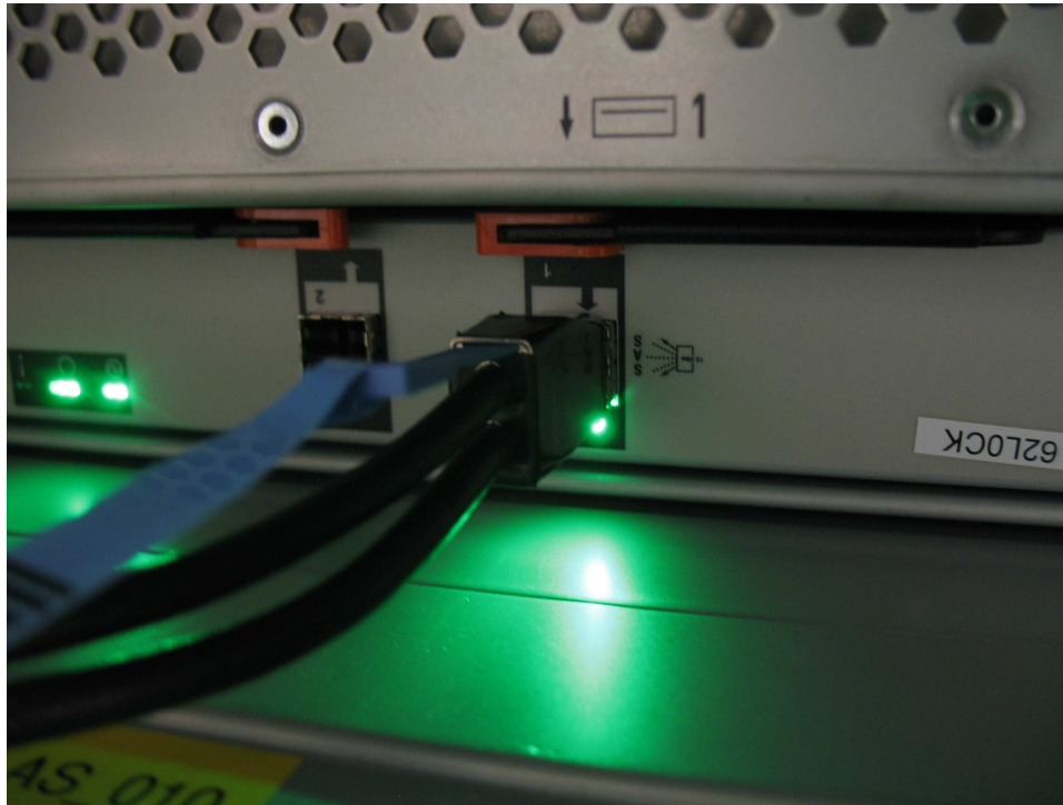
図 89. SAS ポートに正しく挿入された SAS ケーブル
