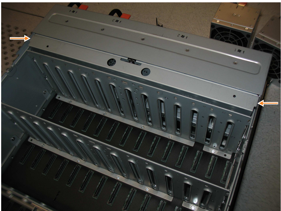
図 95. FIB カバーの再取り付け
