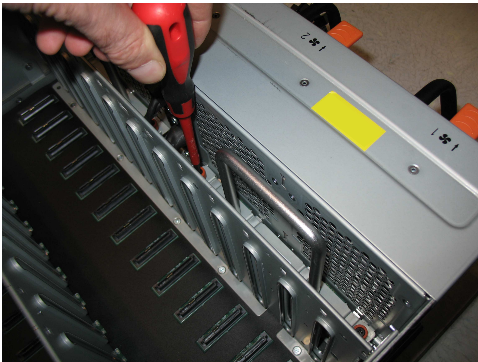
図 114. FIB のねじを緩める
