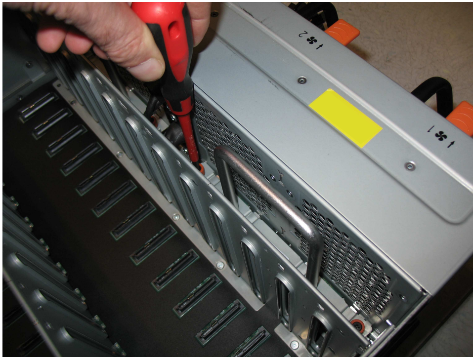
図 94. ドライブ・ボードへの FIB の固定
