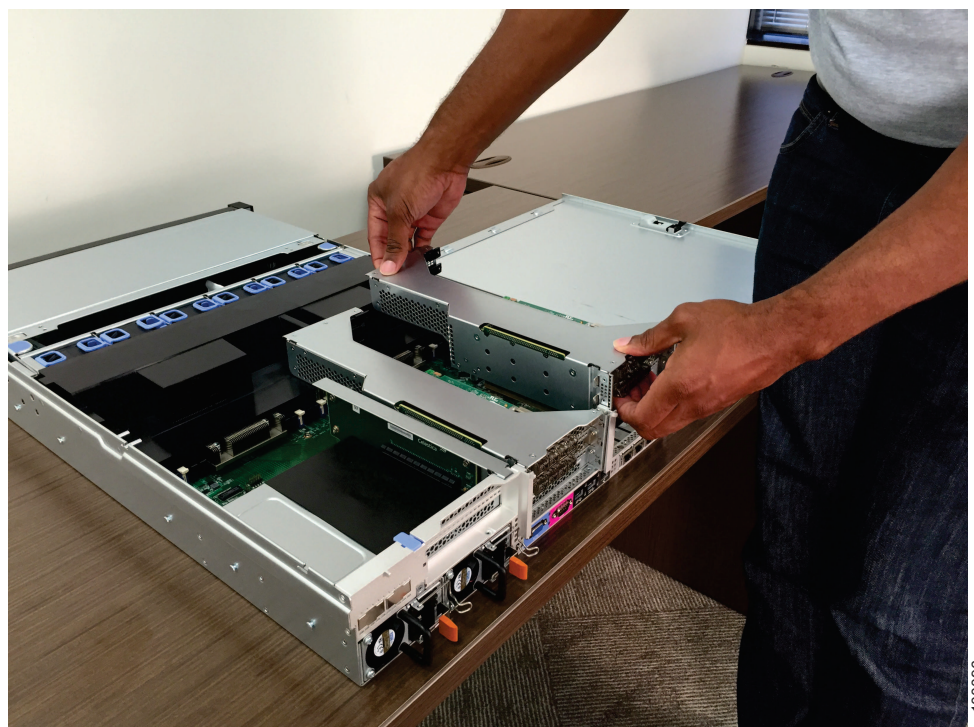
Figura 239. Removendo o conjunto da placa riser PCI 1
