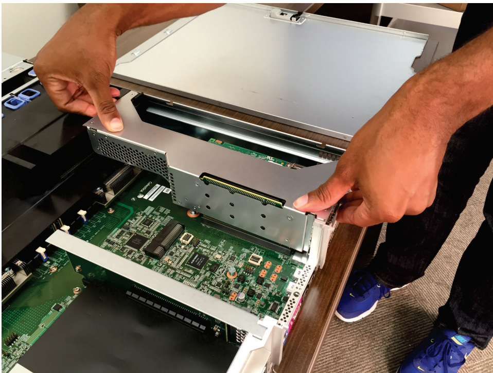
Figura 243. Substituindo o conjunto da placa riser PCI 1
