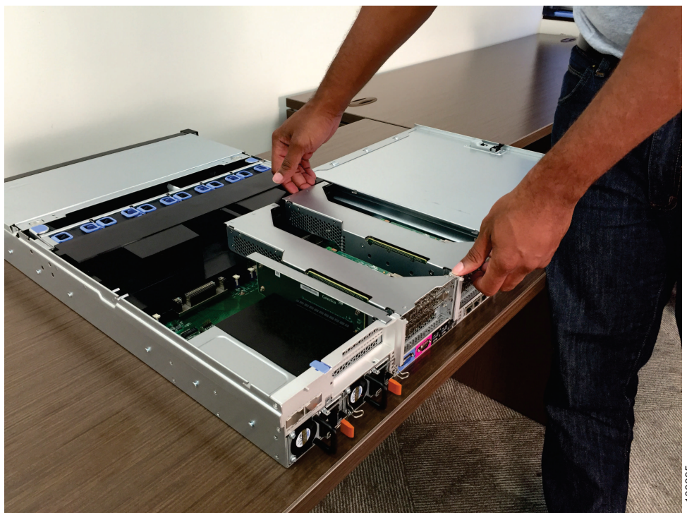
Figura 238. Segurando o conjunto da placa riser PCI 1
