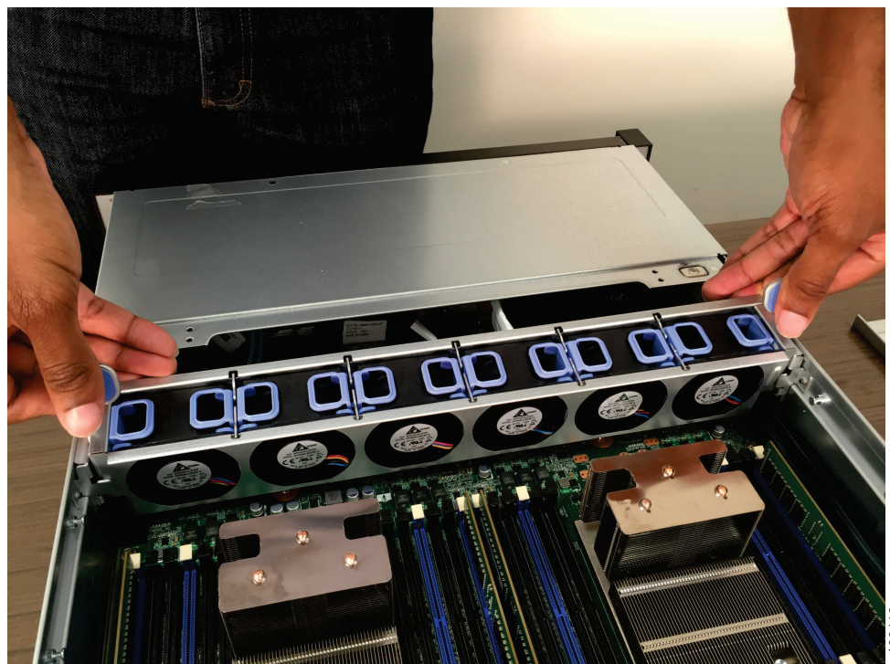
Figura 286. Substituindo o suporte do ventilador
