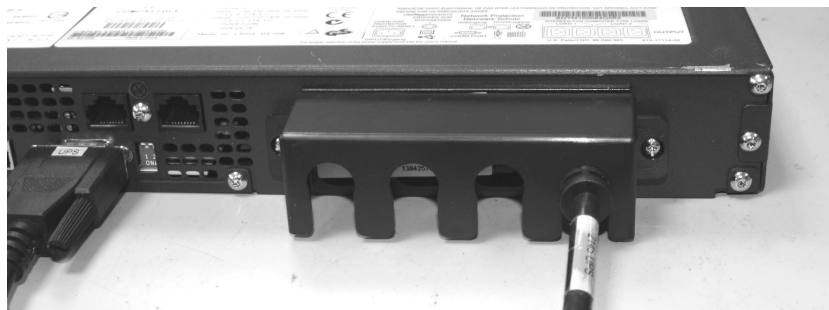
Figura 335. Suporte de retenção de cabos de energia do 2145 UPS-1U
