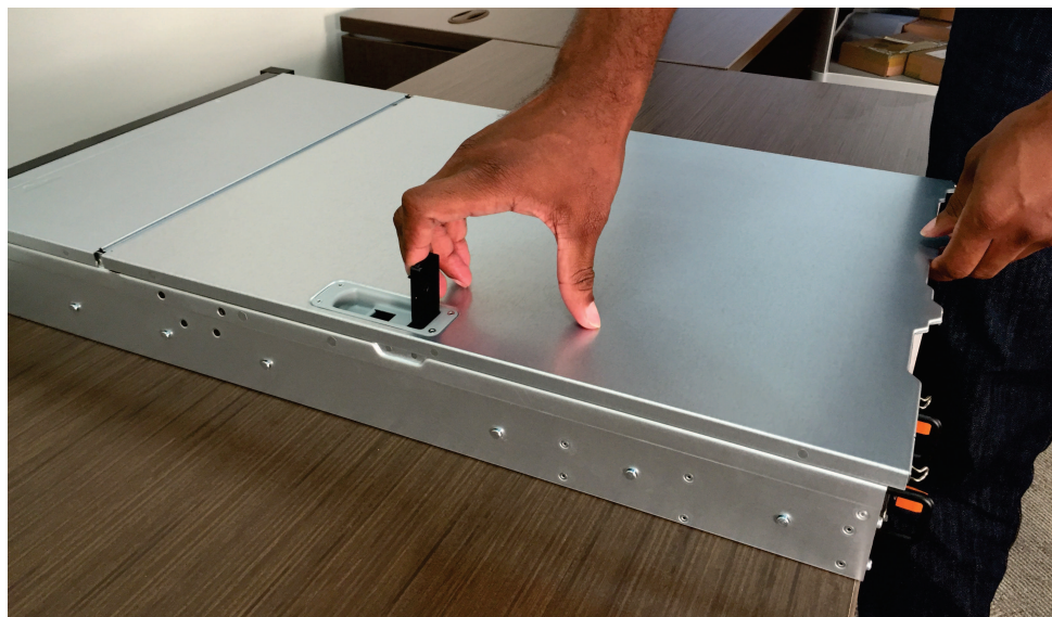
Figura 72. Trava de liberação da tampa traseira do 2145-SV1
