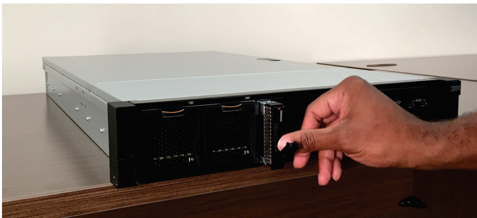
Figura 128. Substituindo uma reinicialização do 2145-SV1 de unidade
