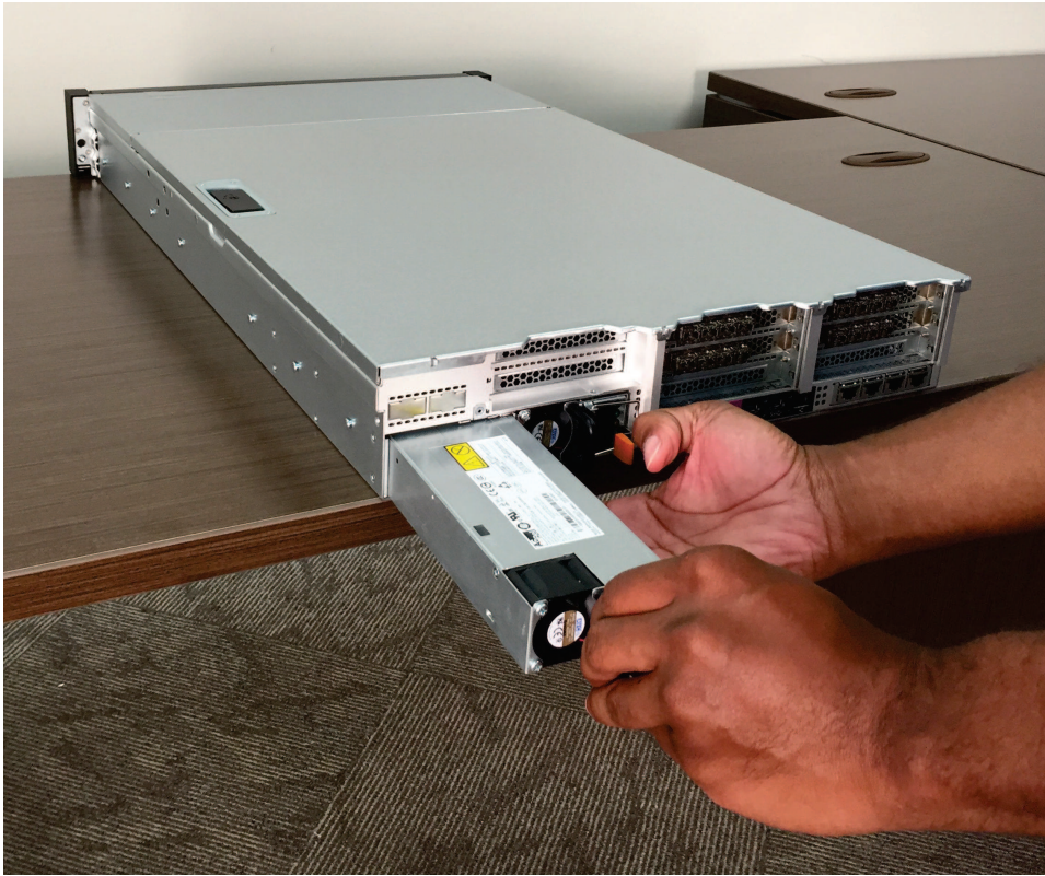
Figura 200. Substituindo a2145-SV1 Fonte de Alimentação
