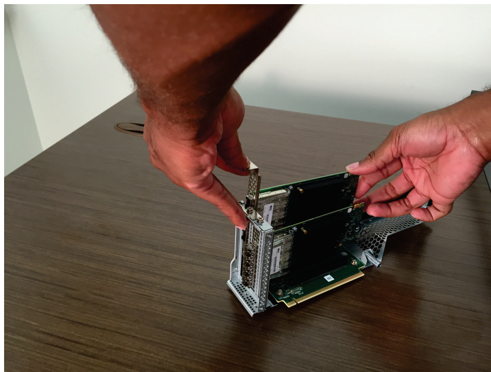
Figura 249. Inserindo o Adaptador no Conector PCI
