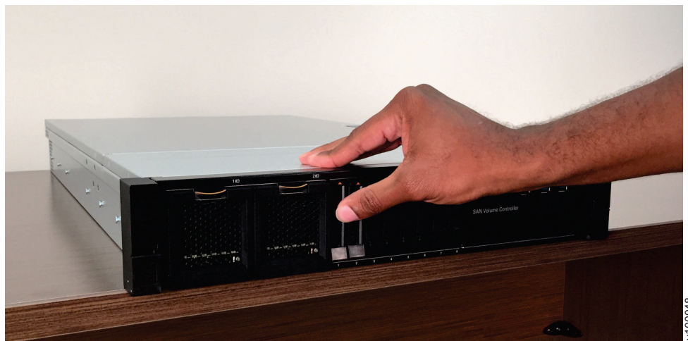
Figura 129. Fechando a alça de liberação em uma unidade de inicialização do 2145-SV1
