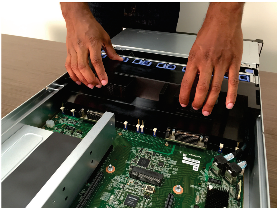
Figura 85. Substituindo a placa defletora de ar
