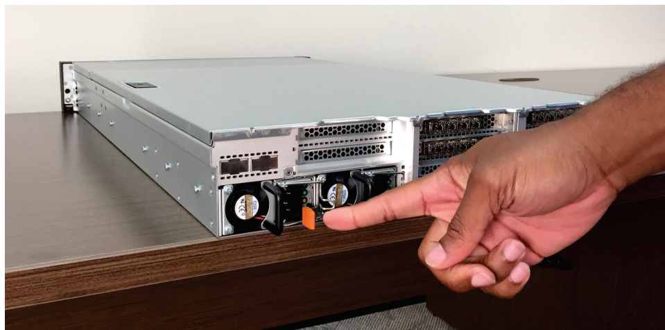
Figura 196. Liberação na fonte de alimentação do 2145-SV1
