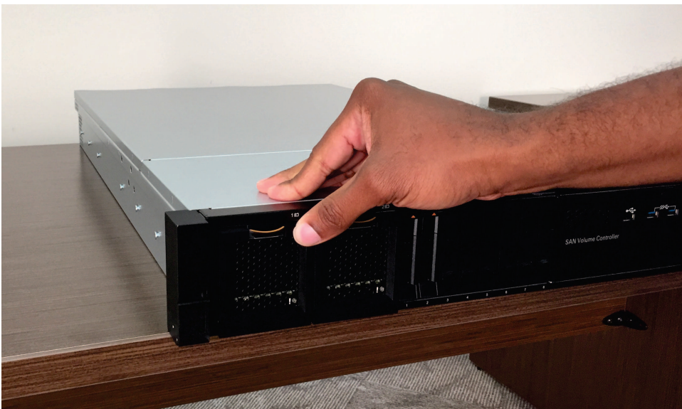
Figura 180. Fechando a alça de liberação da bateria
