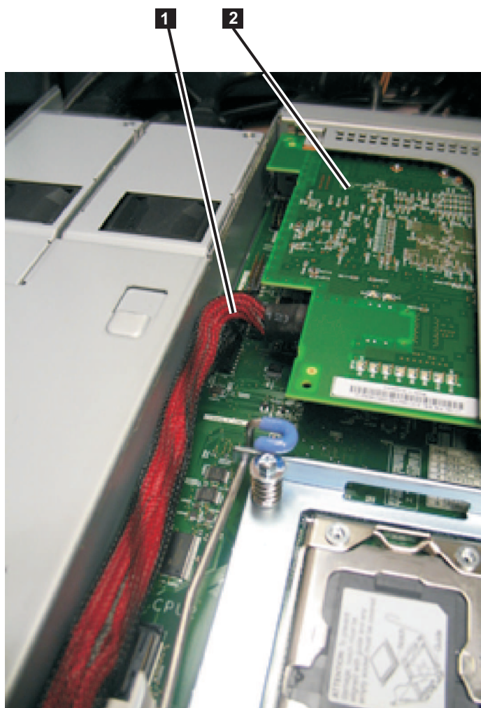
Figura 225. Conjunto de adaptadores SAS de alta velocidade e cabo SAS de alta velocidade no SAN Volume Controller 2145-CG8 ou 2145-CF8
