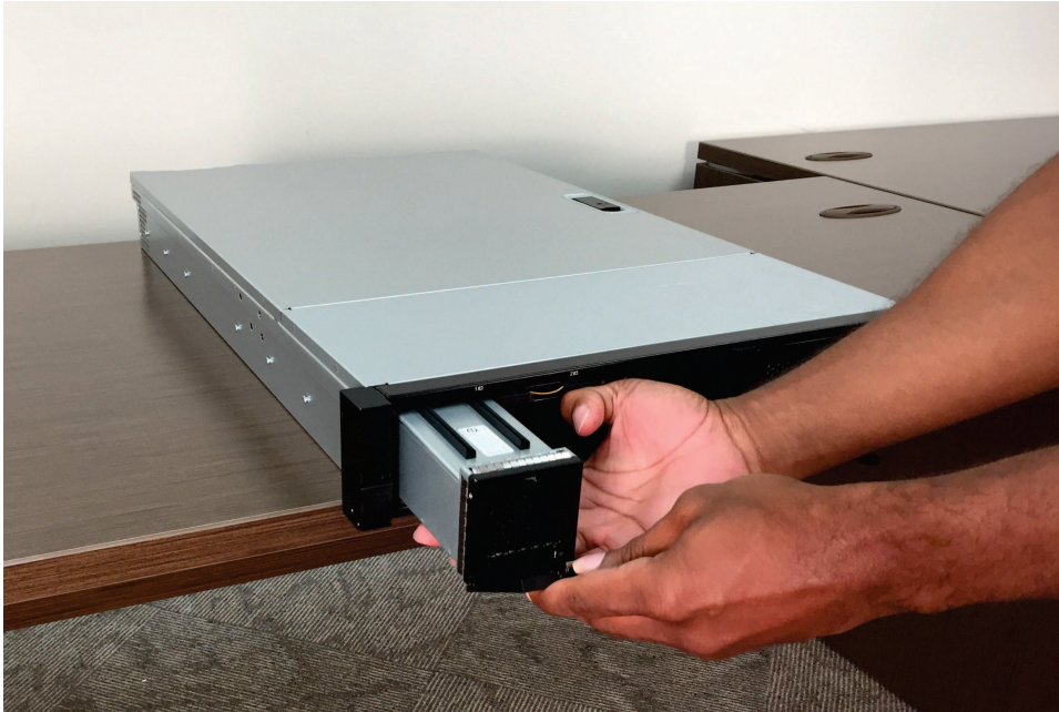
Figura 179. Substituindo a bateria do nó do 2145-SV1
