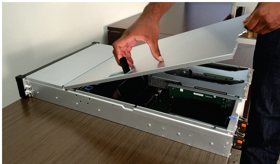
Figura 73. Removendo a tampa traseira do 2145-SV1
