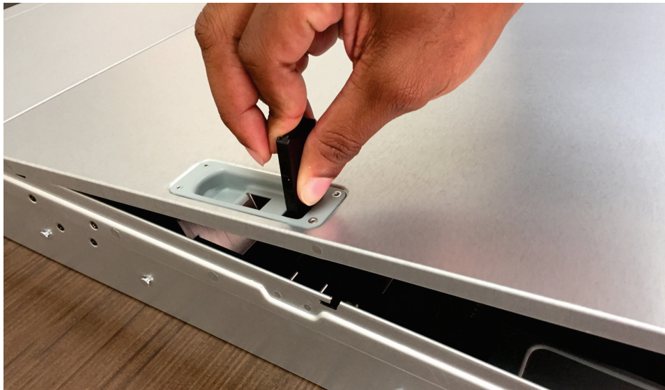
Figura 78. Substituindo a tampa traseira do 2145-SV1
