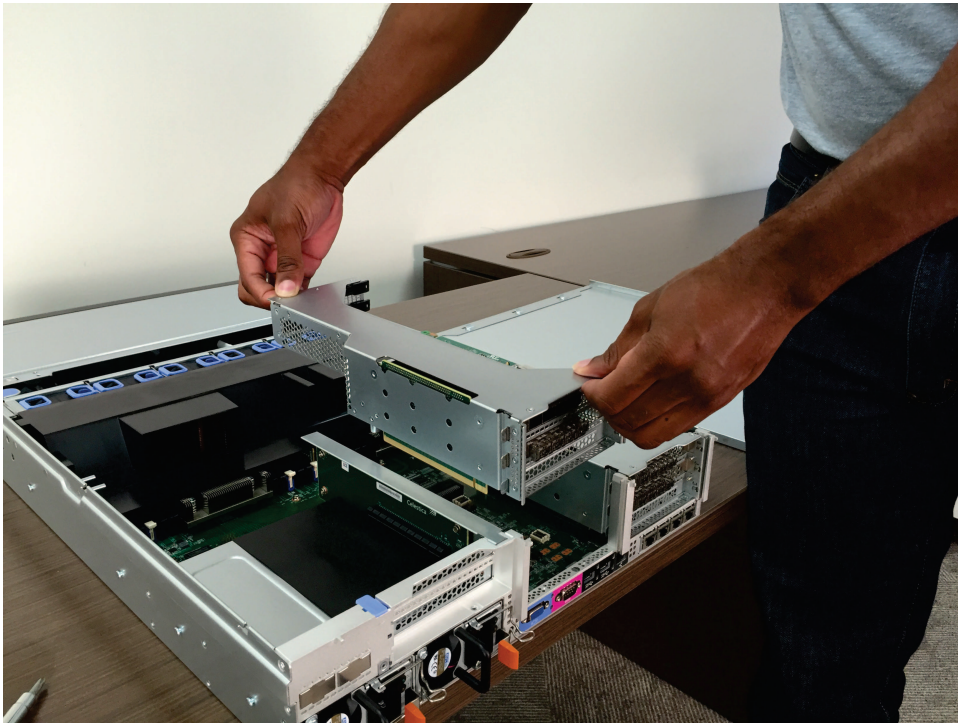
Figura 240. Segurando e removendo o conjunto da placa riser PCI 2
