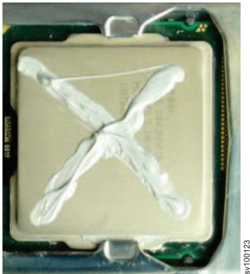
Figura 300. Aplicando Pasta Térmica no Microprocessador do 2145-SV1
