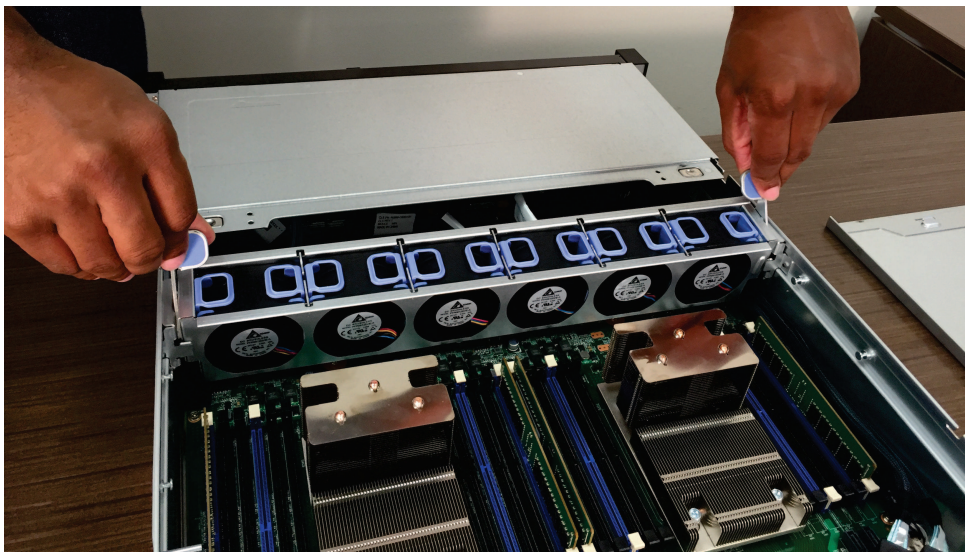
Figura 284. Removendo o Suporte do Ventilador
