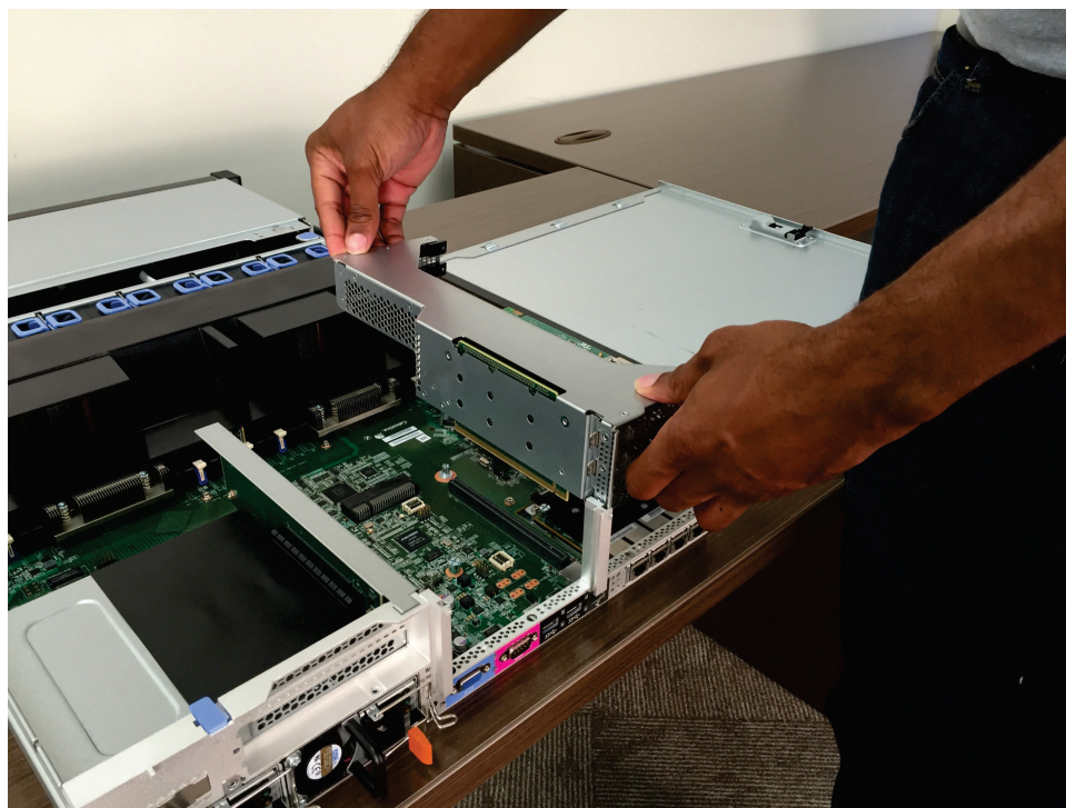
Figura 242. Alinhando o conjunto da placa riser PCI 1
