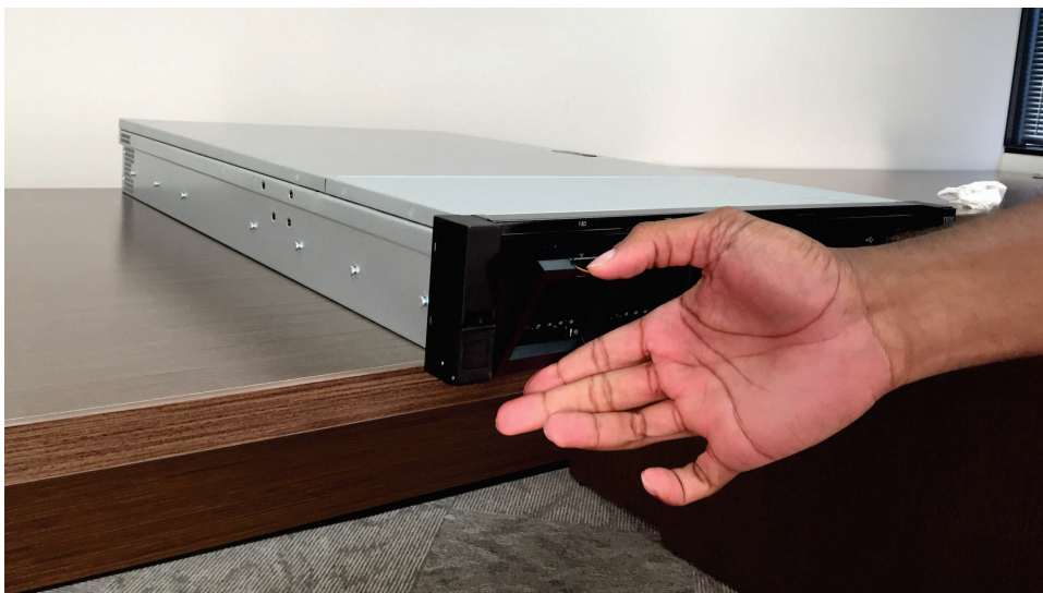
Figura 176. Liberar o módulo de bateria no nó 2145-SV1
