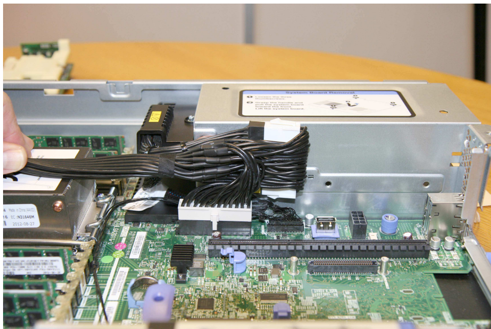
Figura 171. Conexão do cabo de energia entre a unidade da fonte de alimentação e a placa-mãe
