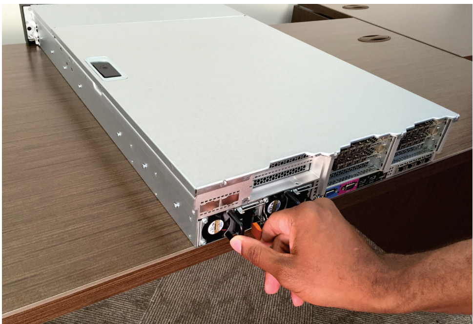
Figura 197. Removendo a Fonte de Alimentação do 2145-SV1
