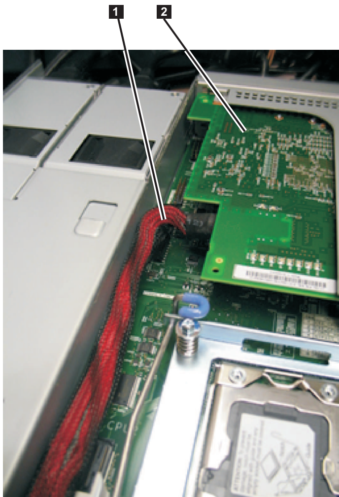
Figura 228. Conjunto de adaptadores SAS de alta velocidade e cabo SAS de alta velocidade no SAN Volume Controller 2145-CG8 ou 2145-CF8
