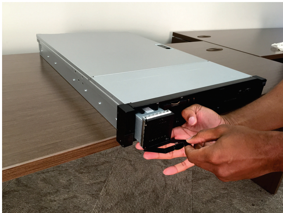
Figura 177. Removendo a bateria no nó 2145-SV1
