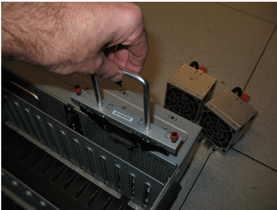
Abbildung 126. Lüfterschnittstellenplatine aus Chassis entfernen
