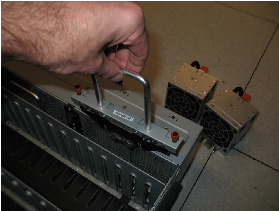
Figura 104. Insertar la nueva FIB en el chasis
