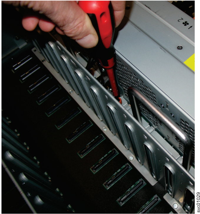
Figura 105. Fijar la FIB a la placa de unidad
