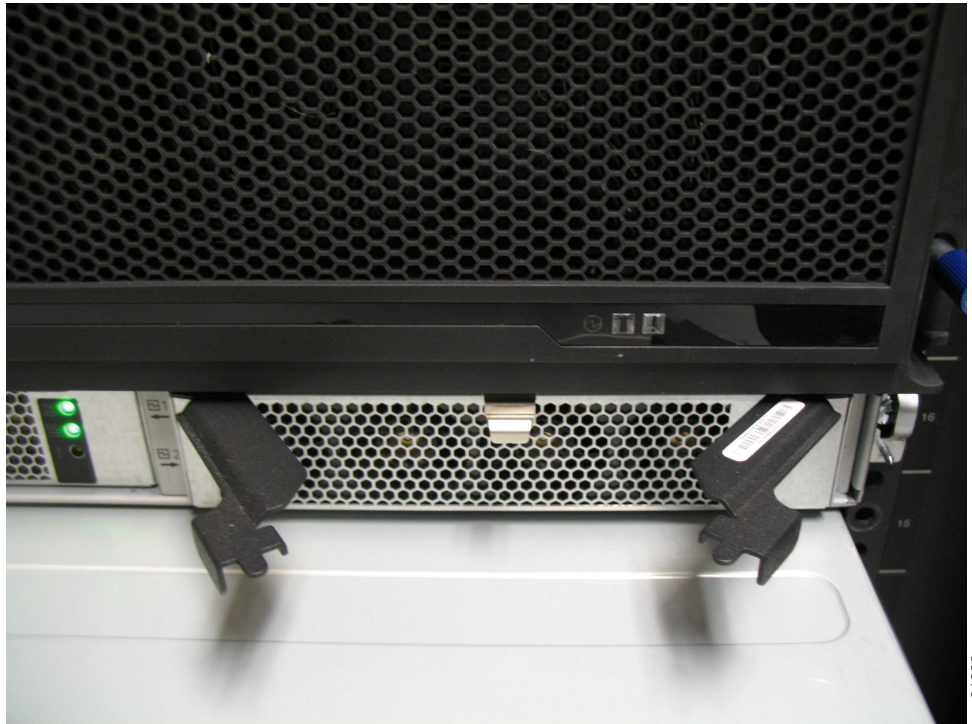
Figure 108. Libération des poignées de l'alimentation électrique
