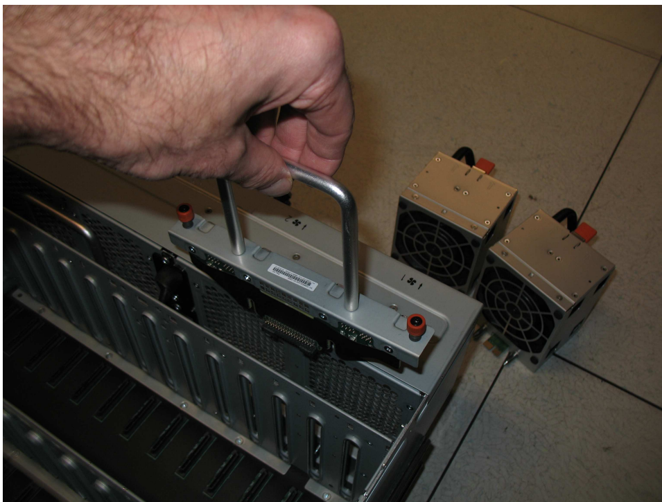
Figure 104. Insérer la nouvelle FIB dans le châssis
