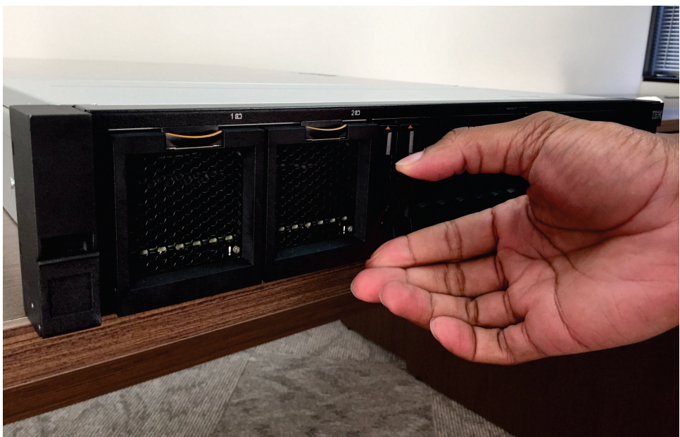
図 82. 2145-SV1 ブート・ドライブのリリース・ハンドルの操作
