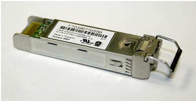
図 144. SFP トランシーバー (SFP transceiver)
