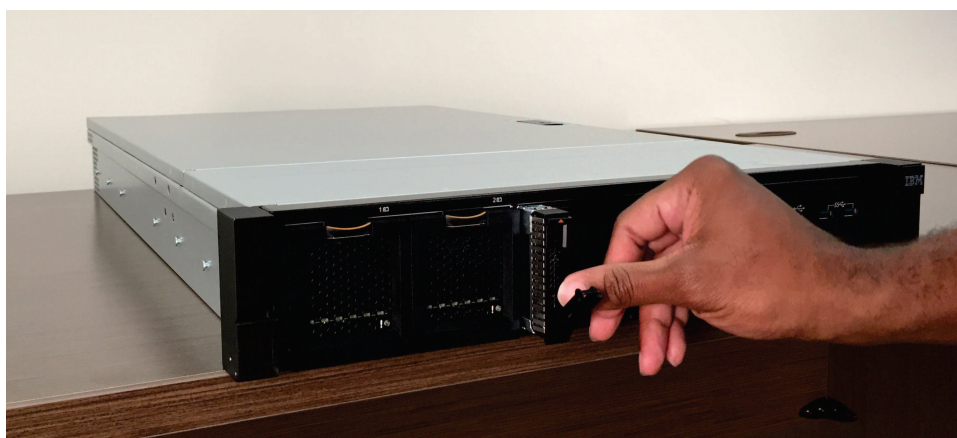
図 86. 2145-SV1 ブート・ドライブの交換
