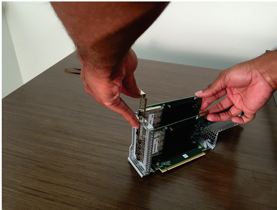
図 157. PCI コネクターへのアダプターの挿入
