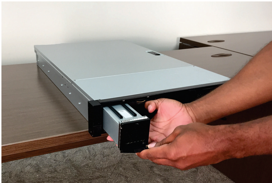
図 124. 2145-SV1 ノードのバッテリーの交換
