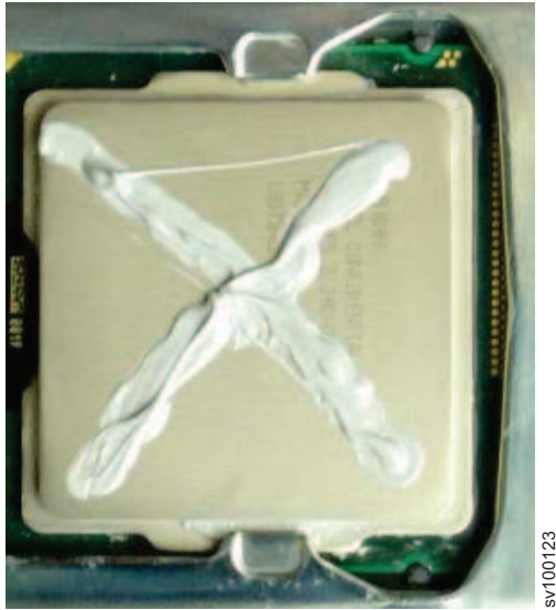
図 192. 2145-SV1 マイクロプロセッサへの熱伝導グリースの塗布
