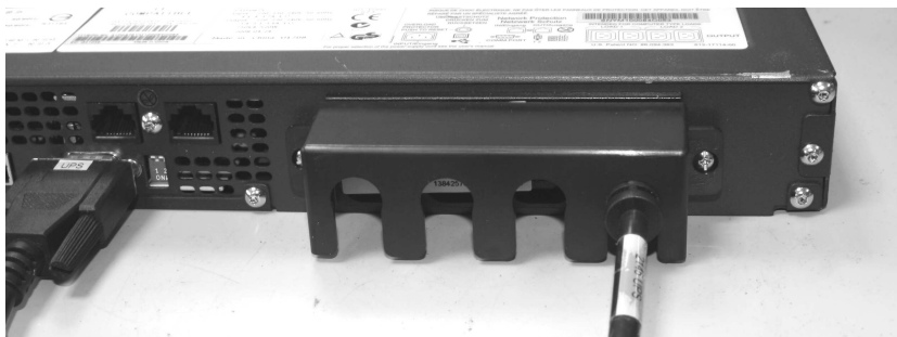
図 217. 2145 UPS-1U の電源ケーブル保持ブラケット
