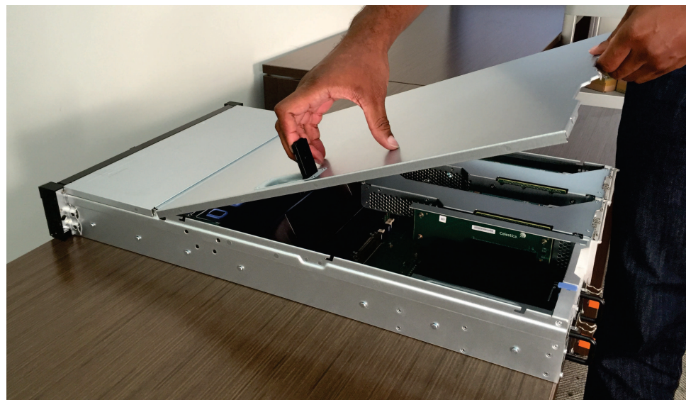
図 51. 2145-SV1 背面カバーの取り外し
