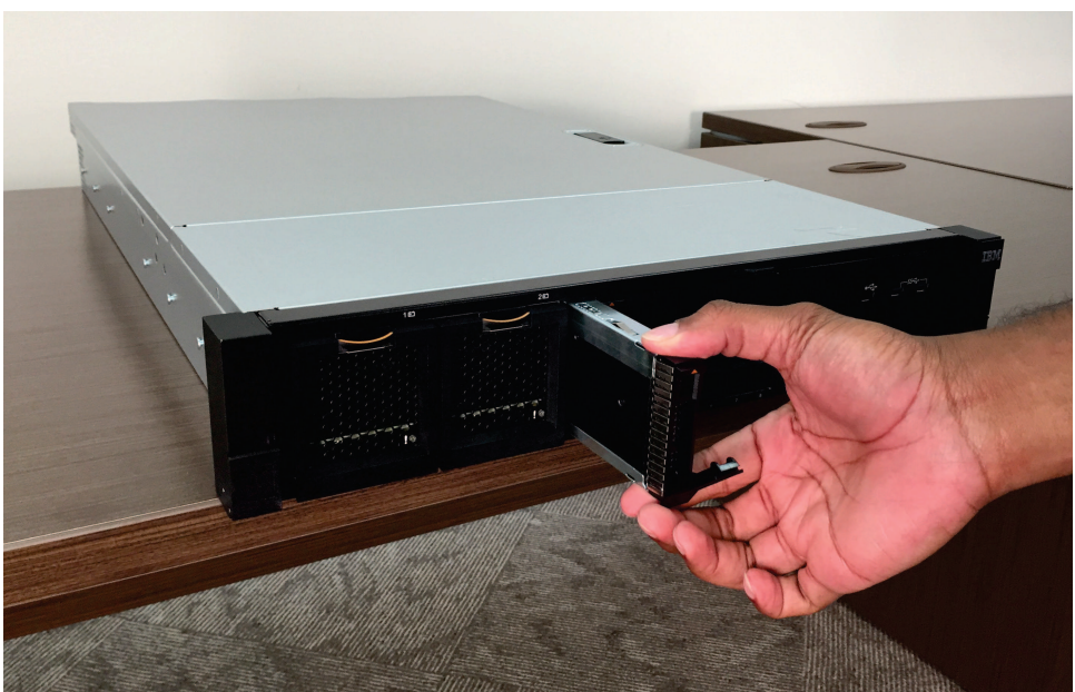
図 83. 2145-SV1 ブート・ドライブの取り外し
