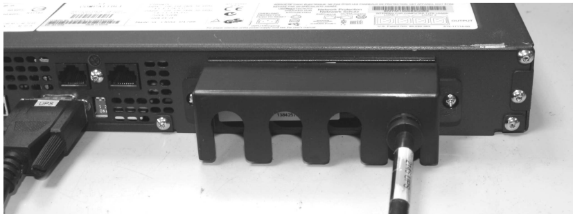
図 216. 2145 UPS-1U の電源ケーブル保持ブラケット
