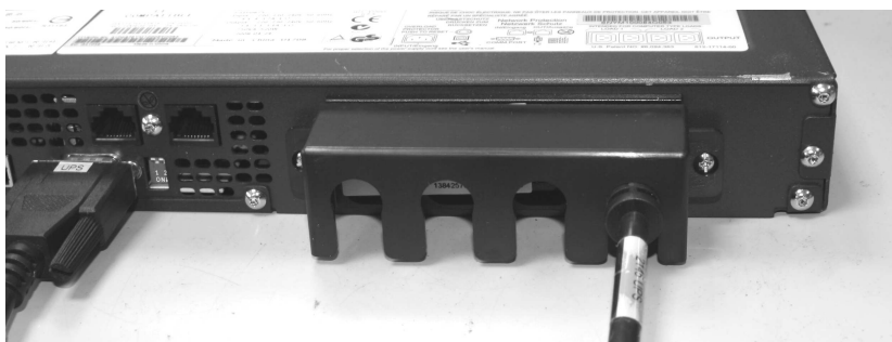
図 229. 2145 UPS-1U に接続された 2145 UPS-1U のケーブル保持ブラケット
