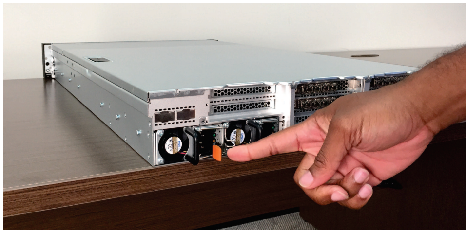
図 136. 2145-SV1 電源機構の解放
