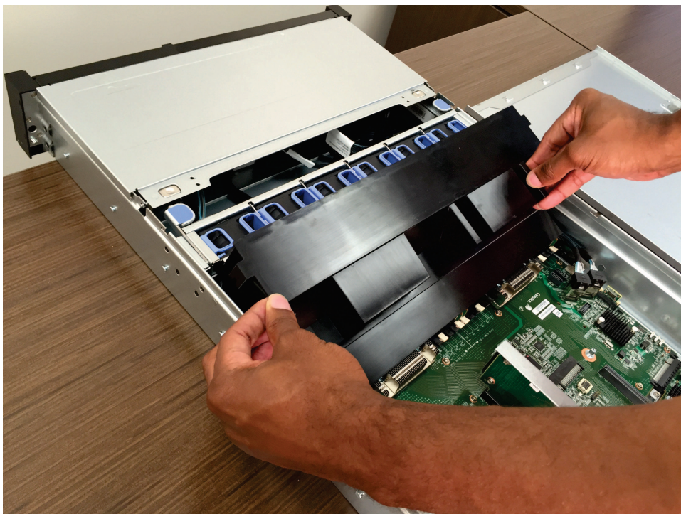
図 57. エア・バッフルの取り外し
