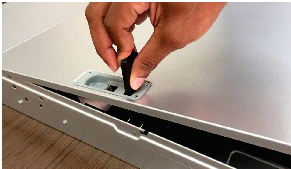
図 55. 2145-SV1 の背面カバーの再取り付け
