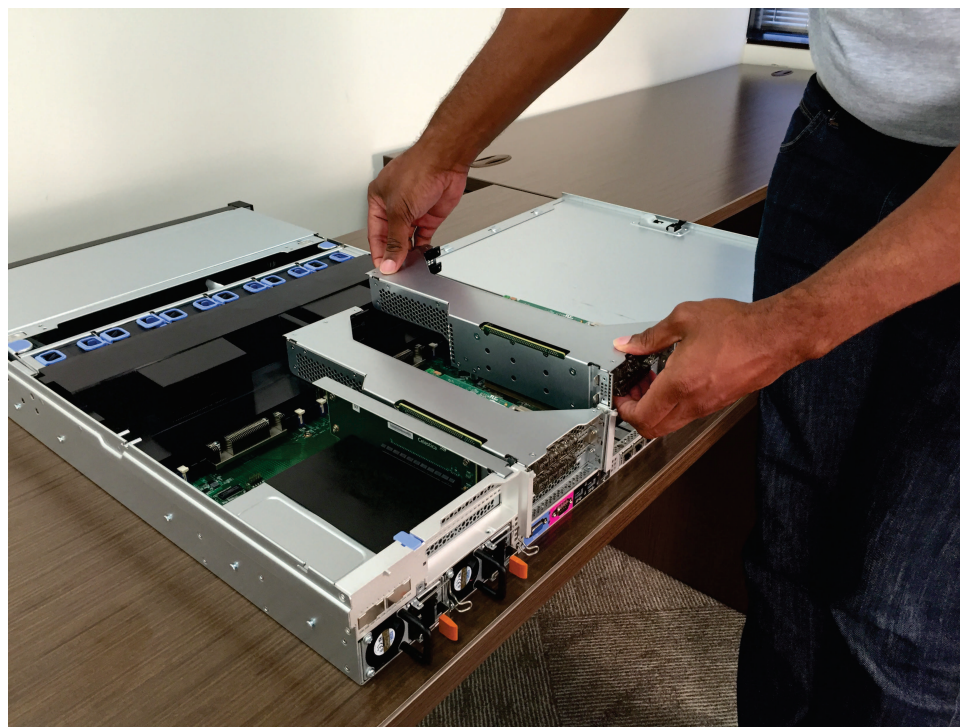
図 147. PCI ライザー・カード・アセンブリー 1 の取り外し
