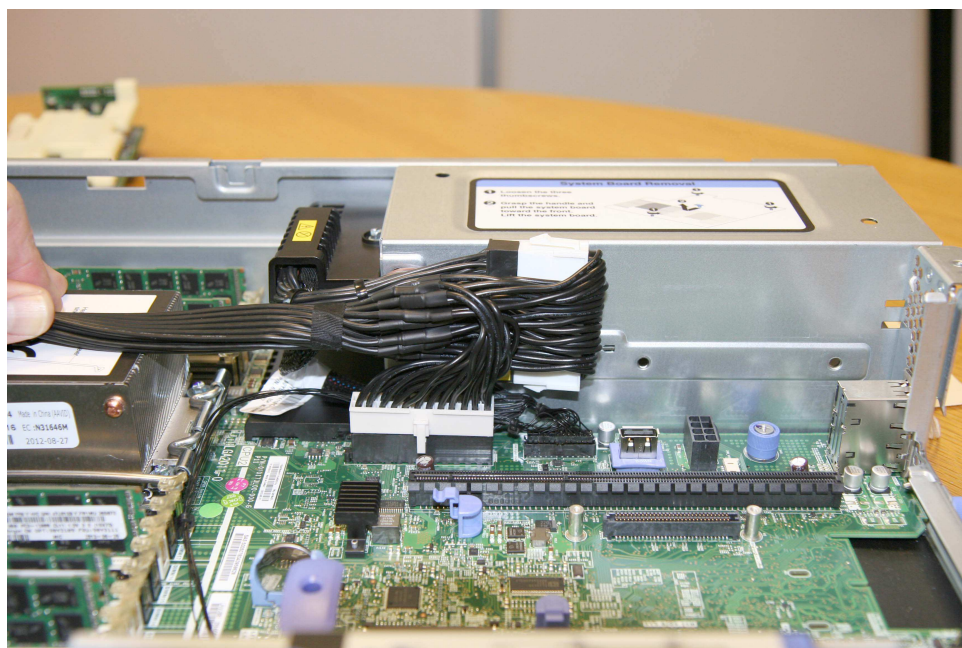
図 116. 電源機構とシステム・ボードの間の電源ケーブル接続
