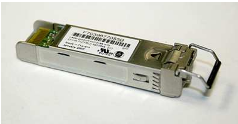
図 143. SFP トランシーバー (SFP transceiver)
