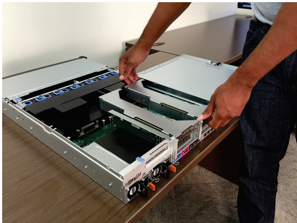
図 146. PCI ライザー・カード・アセンブリー 1 をつかむ
