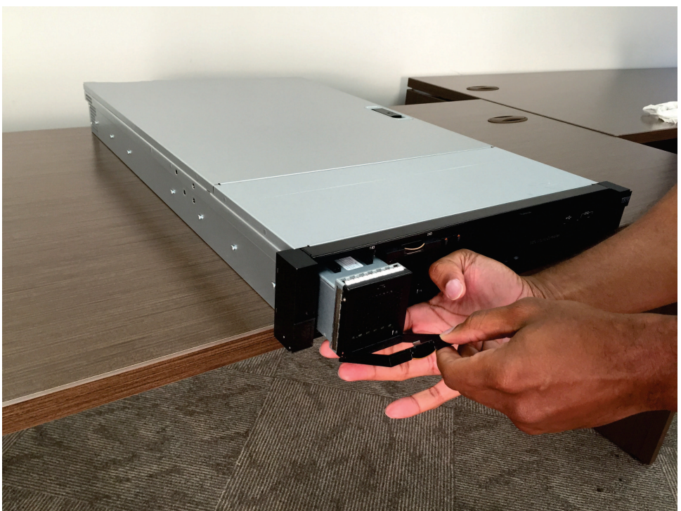
図 122. 2145-SV1 ノードのバッテリーの取り外し
