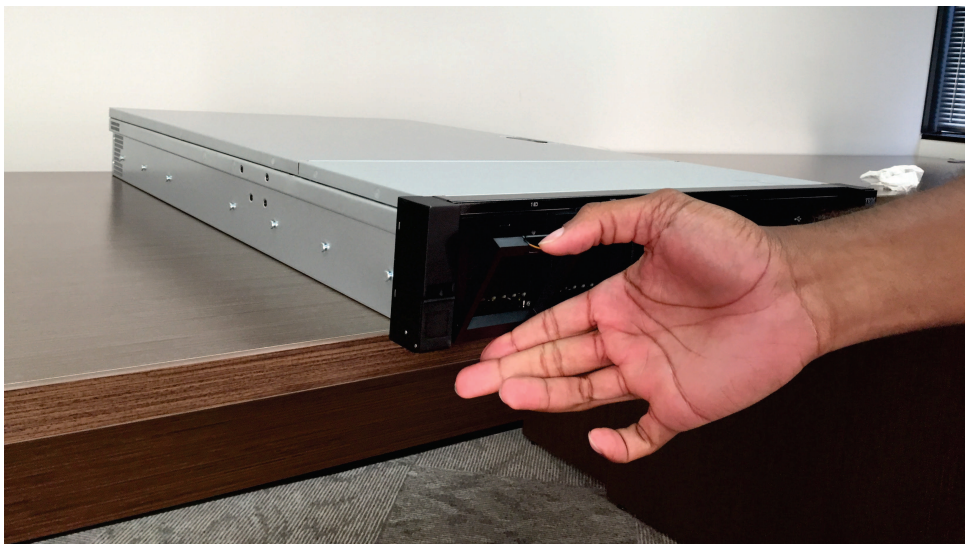
図 121. 2145-SV1 ノードのバッテリー・モジュールの取り外し
