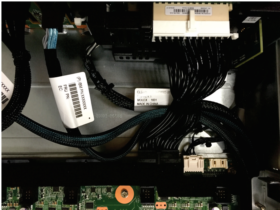
図 97. 2145-SV1 バックプレーンおよびケーブル
