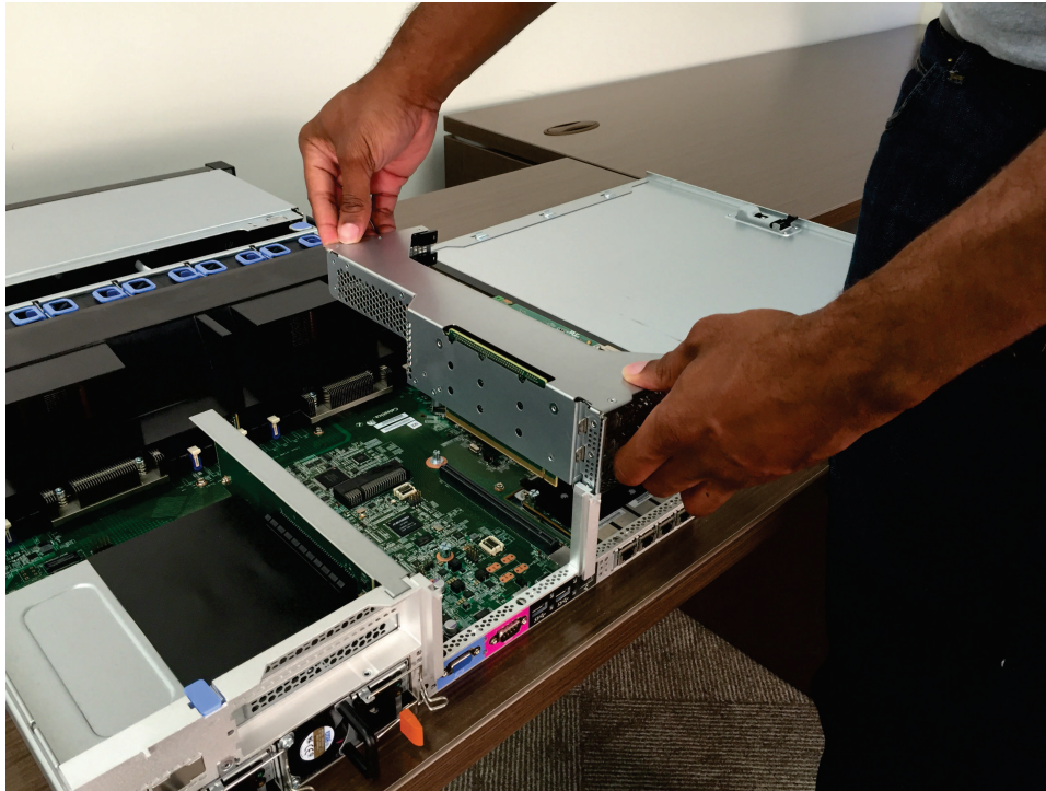
図 150. PCI ライザー・カード・アセンブリー 1 の位置合わせ
