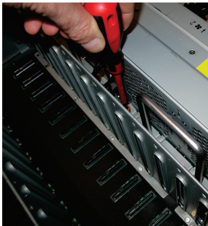
図 125. FIB のねじを緩める
