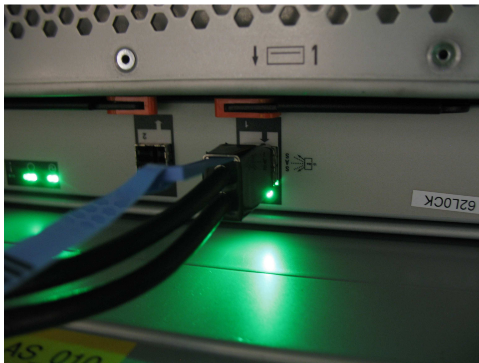
図 100. SAS ポートに正しく挿入された SAS ケーブル
