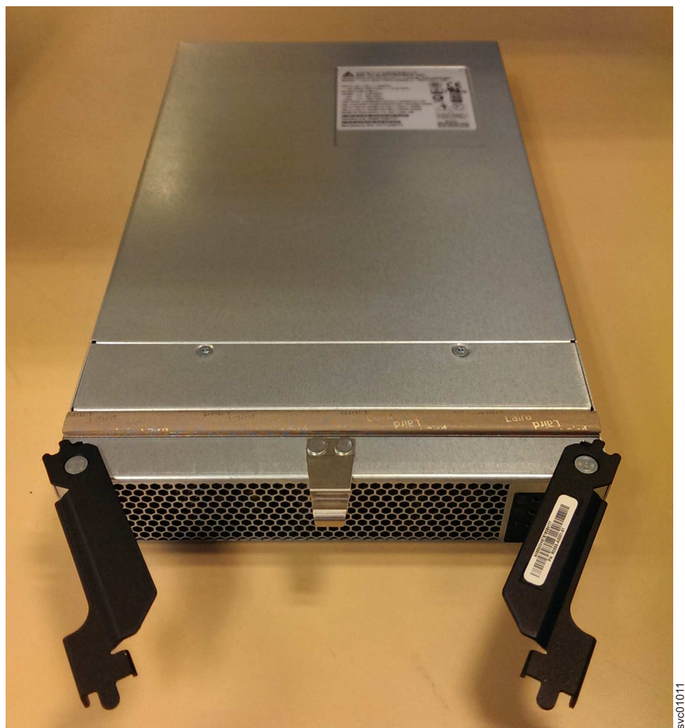
図 92. 電源機構を取り付けるための準備
