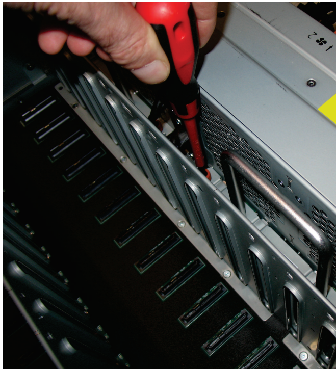
図 105. ドライブ・ボードへの FIB の固定
