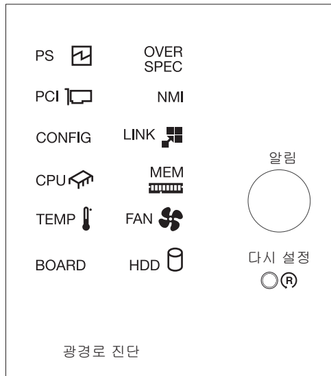
그림 46. SAN Volume Controller 2145-DH8 광경로 진단 패널
