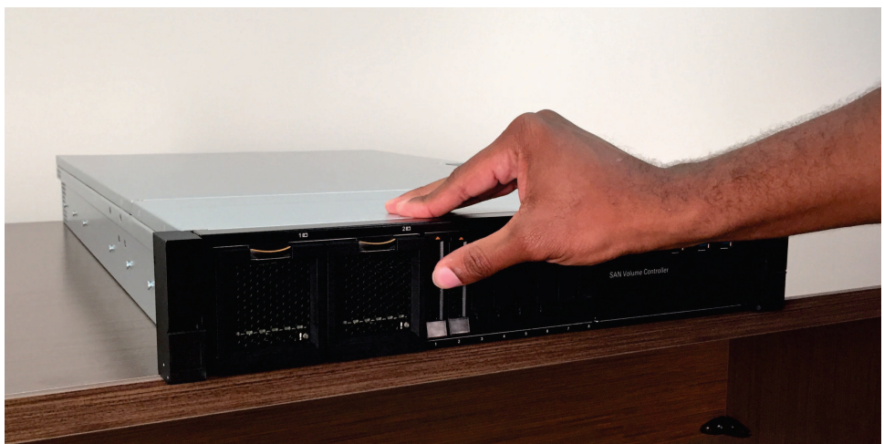
Figura 87. Fechando a alça de liberação em uma unidade de inicialização do 2145-SV1
