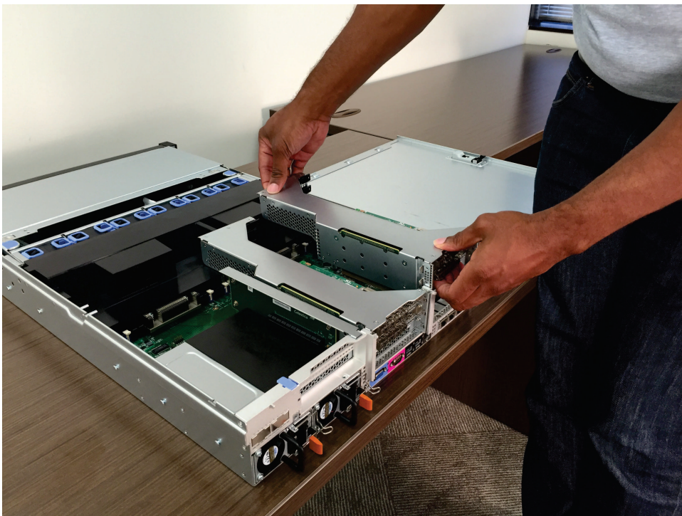
Figura 147. Removendo o conjunto da placa riser PCI 1
