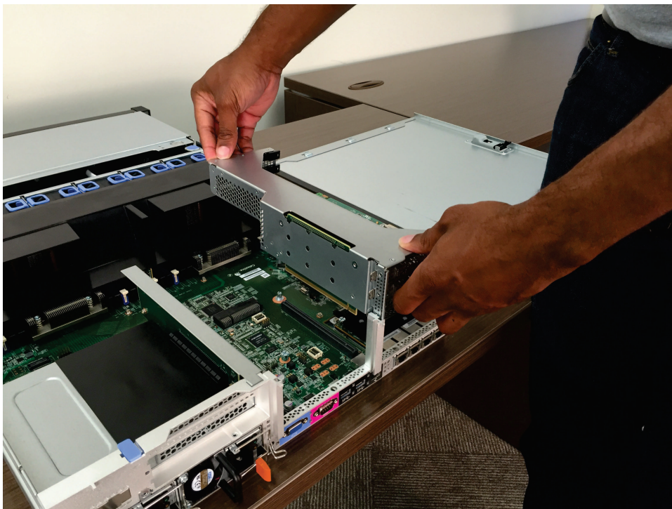
Figura 150. Alinhando o conjunto da placa riser PCI 1
