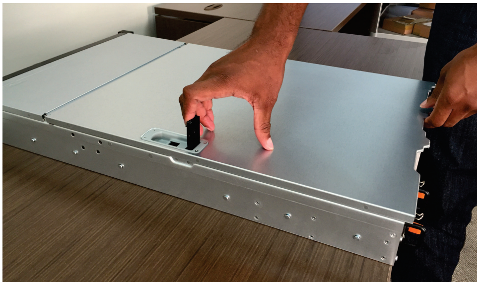
Figura 50. Trava de liberação da tampa traseira do 2145-SV1
