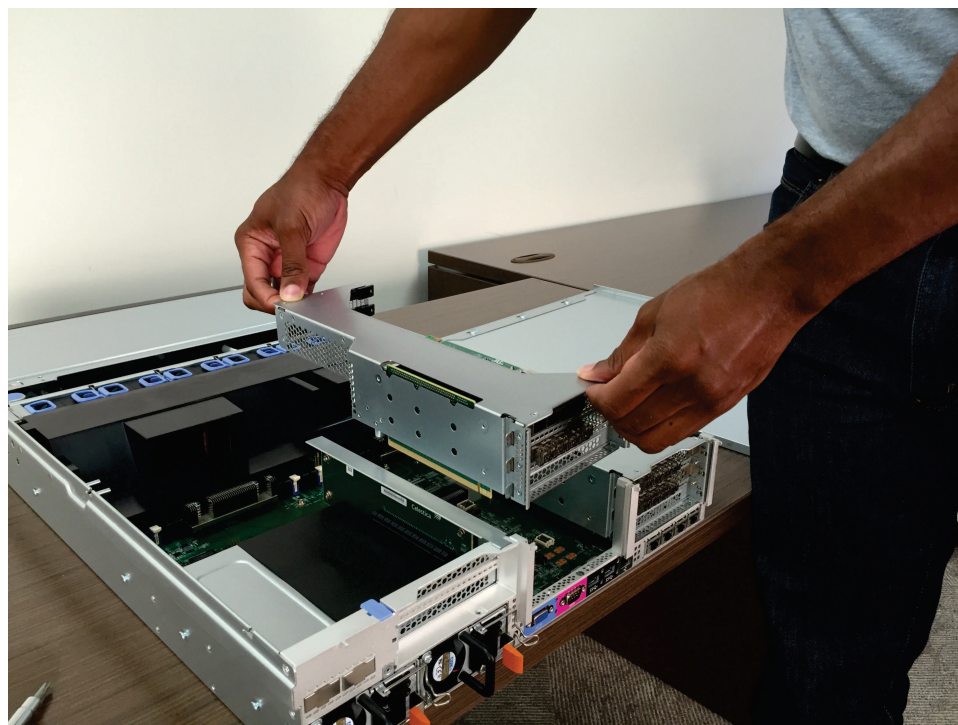
Figura 148. Segurando e removendo o conjunto da placa riser PCI 2
