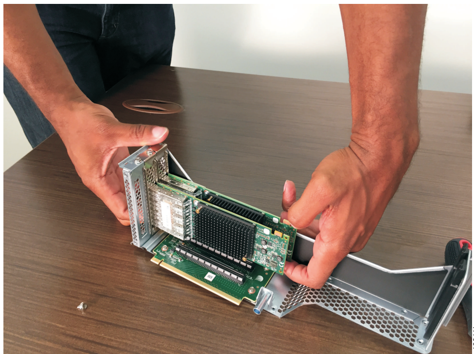
Figura 154. Desprendendo o adaptador
