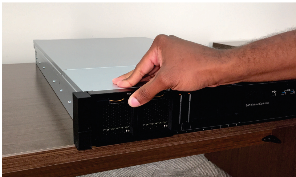
Figura 125. Fechando a alça de liberação da bateria
