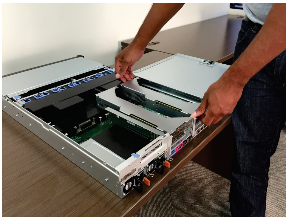
Figura 146. Segurando o conjunto da placa riser PCI 1
