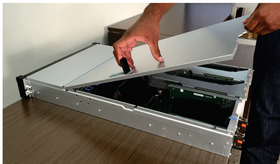
Figura 51. Removendo a tampa traseira do 2145-SV1
