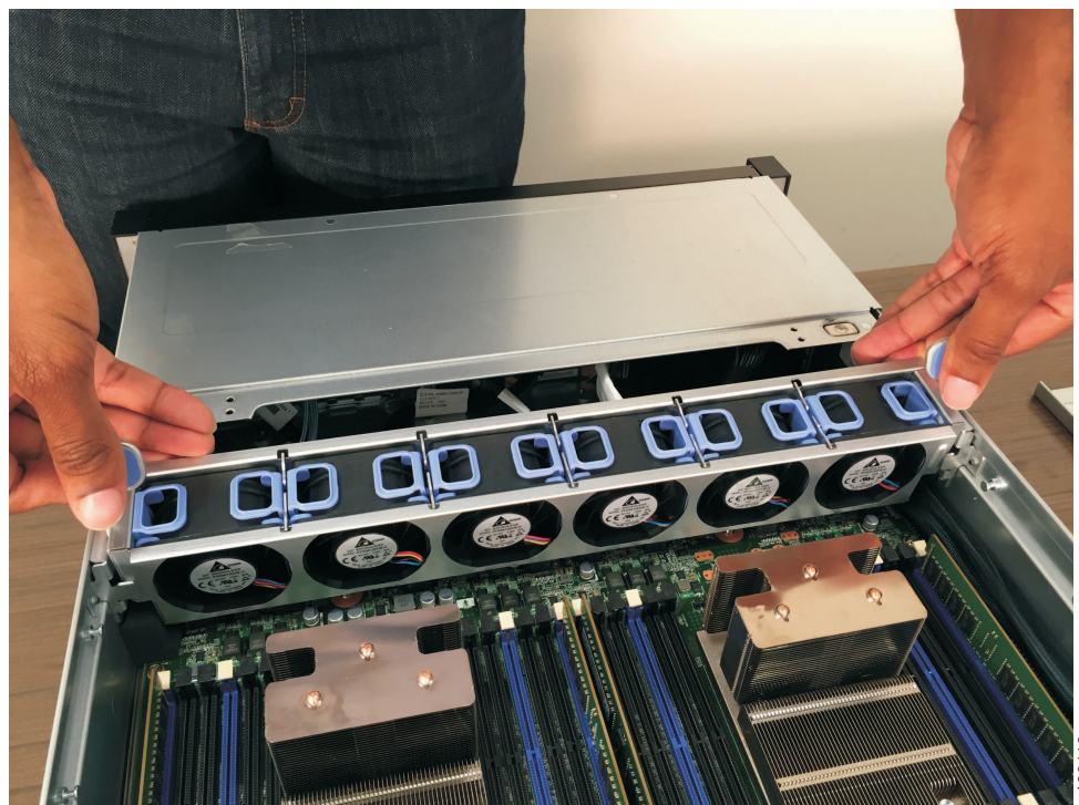
Figura 182. Substituindo o suporte do ventilador
