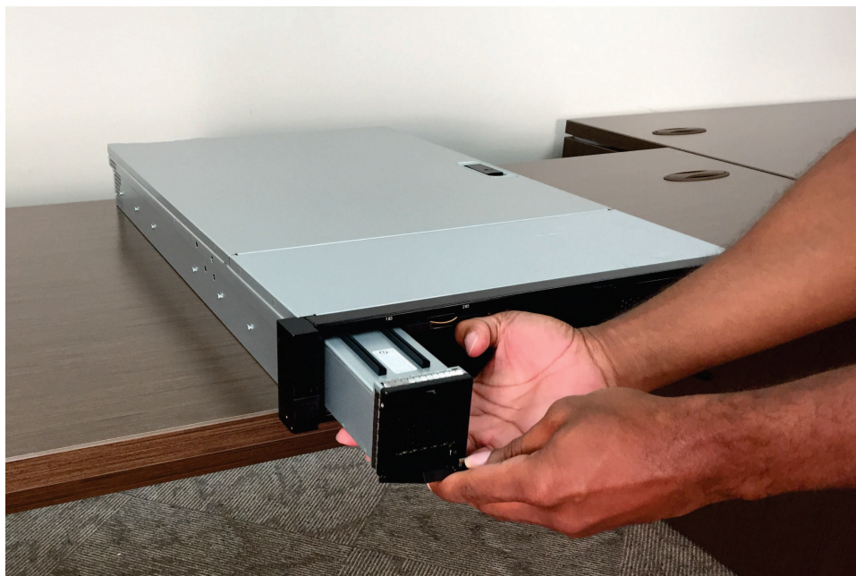
Figura 124. Substituindo a bateria do nó do 2145-SV1
