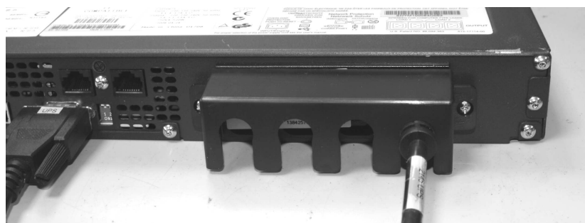
Figura 229. O suporte de retenção de cabos do 2145 UPS-1U conectado ao 2145 UPS-1U
