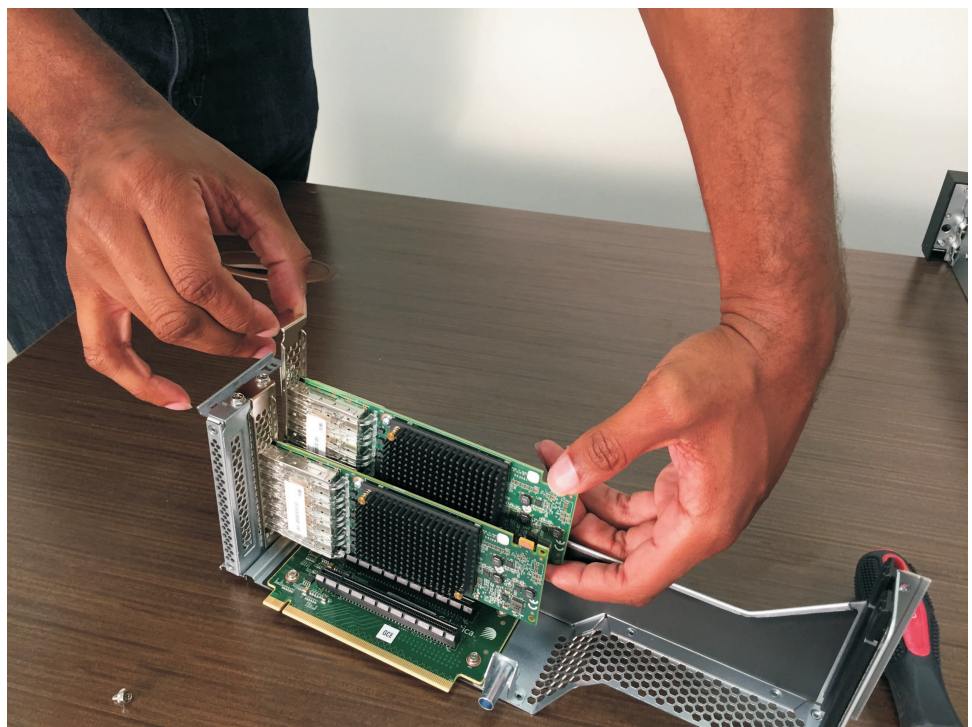
Figura 155. Removendo o adaptador dos conectores
