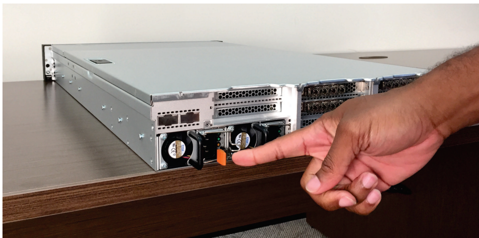
Figura 136. Liberação na fonte de alimentação do 2145-SV1
