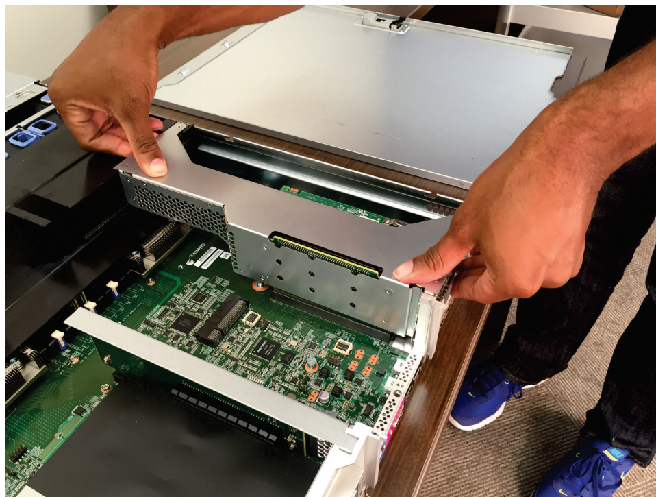
Figura 151. Substituindo o conjunto da placa riser PCI 1
