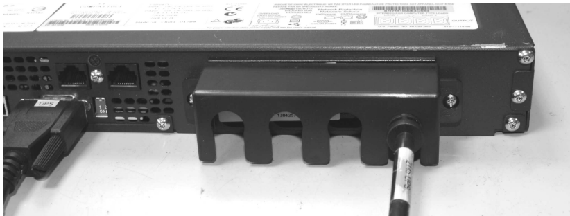
Figura 216. Suporte de Retenção de Cabos de Energia do 2145 UPS-1U
