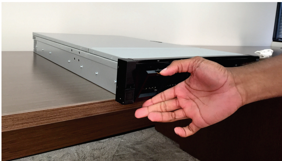
Figura 121. Liberar o módulo de bateria no nó 2145-SV1
