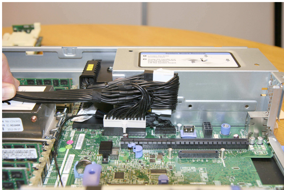
Figura 116. Conexão do cabo de energia entre a unidade da fonte de alimentação e a placa-mãe
