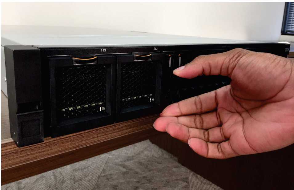
Figura 82. Operando a alça de liberação em uma unidade de inicialização do 2145-SV1
