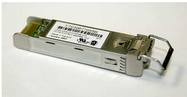
Figura 143. Transceptor SFP
