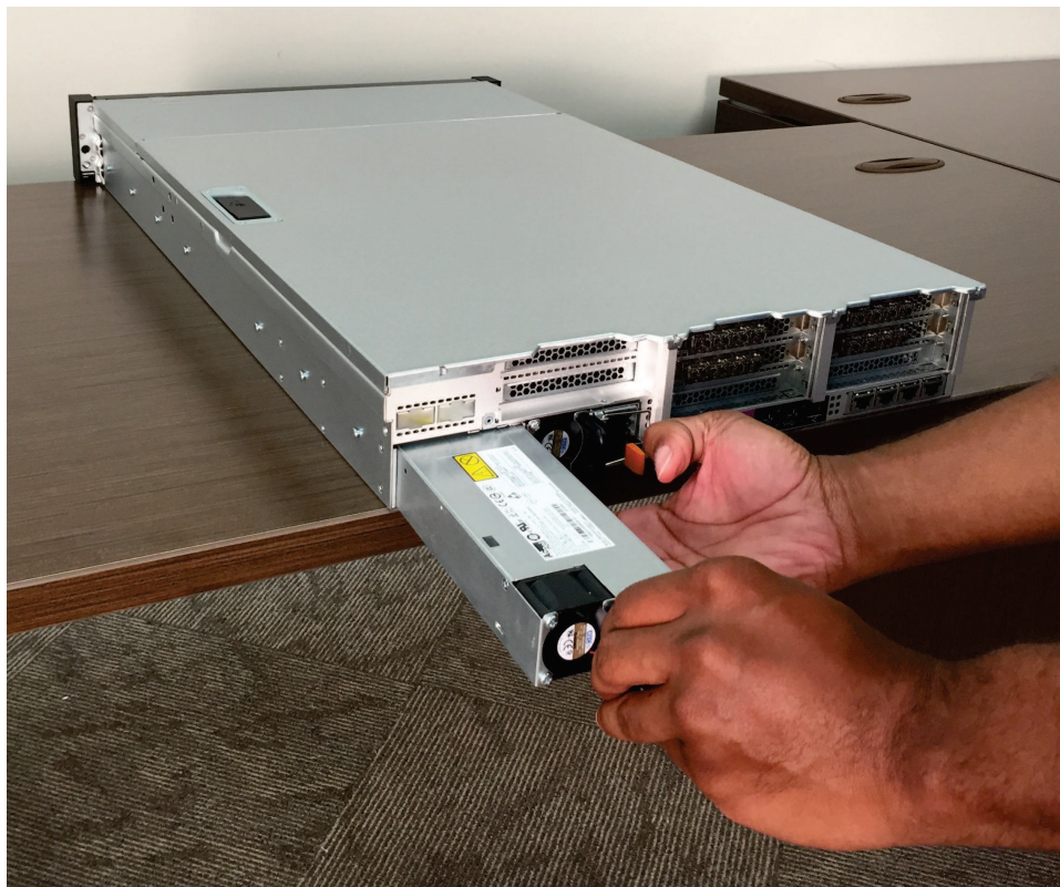
Figura 139. Substituindo a2145-SV1 Fonte de Alimentação
