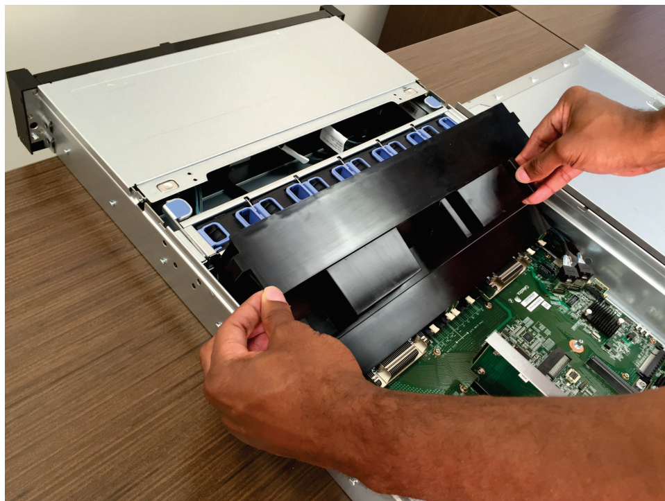
Figura 57. Removendo a placa defletora de ar
