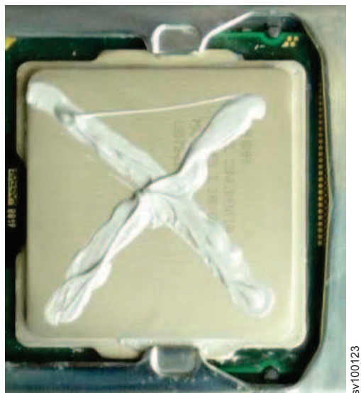
Figura 192. Aplicando Pasta Térmica no Microprocessador do 2145-SV1
