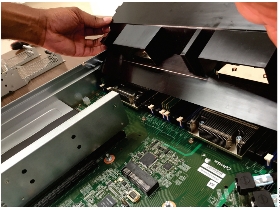
Figura 58. Removendo a placa defletora de ar
