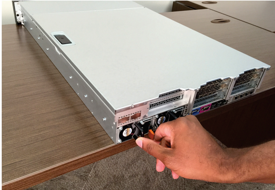
Figura 137. Removendo a Fonte de Alimentação do 2145-SV1
