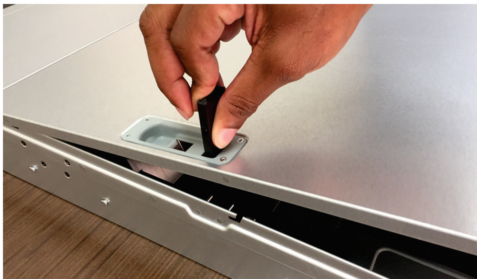
Figura 55. Substituindo a tampa traseira do 2145-SV1
