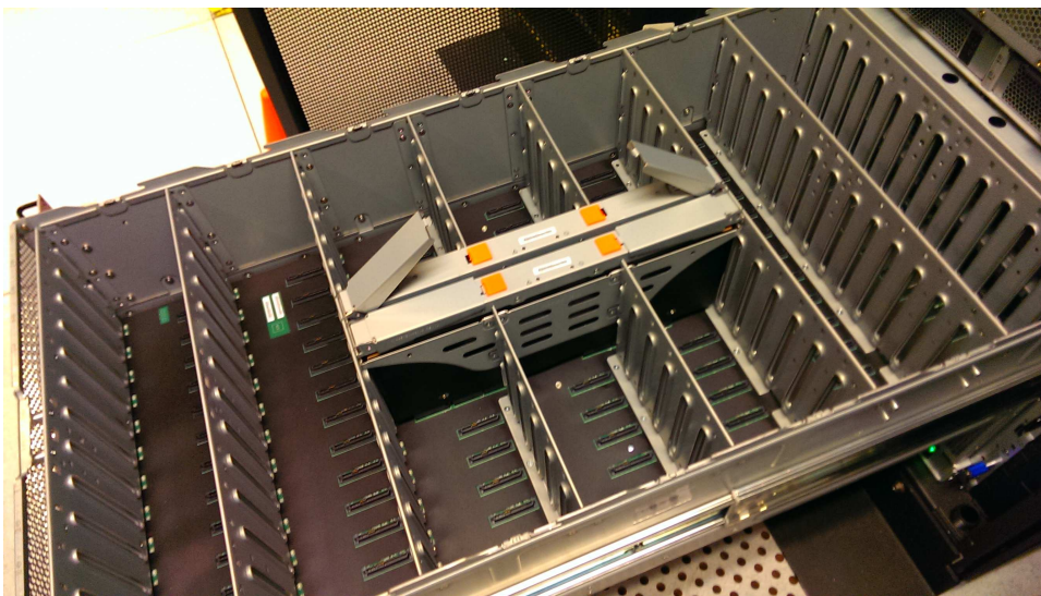
Figura 86. Local dos módulos do expensor secundário
