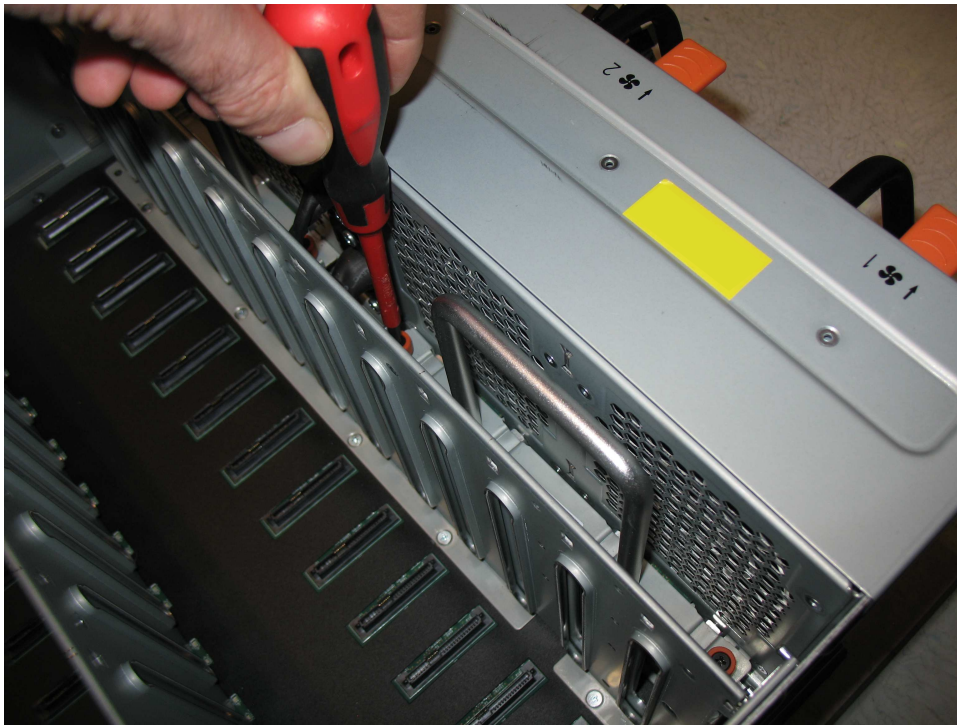
Figura 105. Prenda a FIB à placa de unidade
