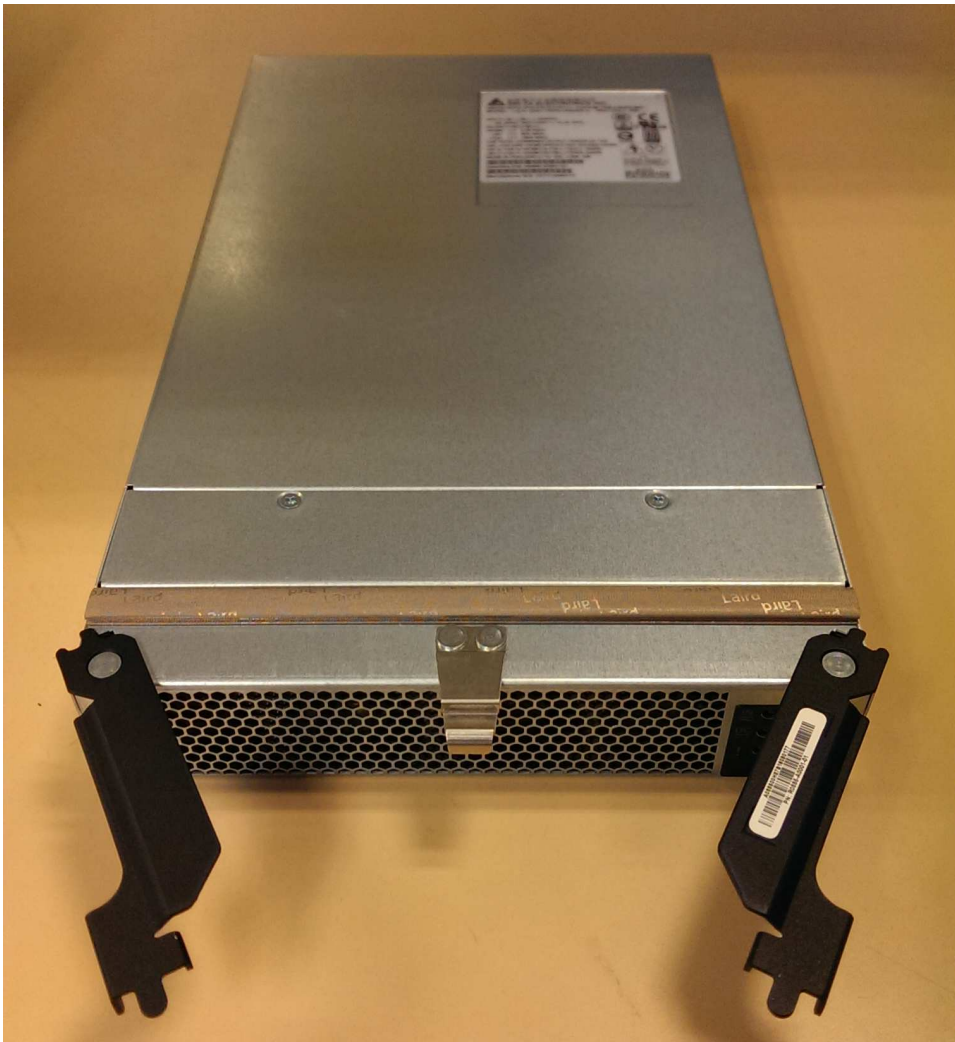
Figura 92. Preparando-se para instalar a fonte de alimentação
