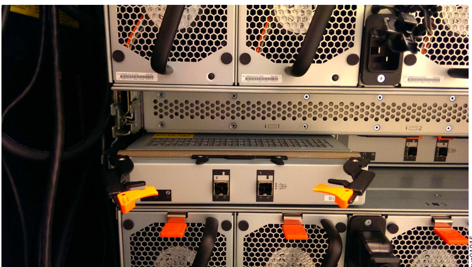
Figura 119. Removendo a caixa de expansão
