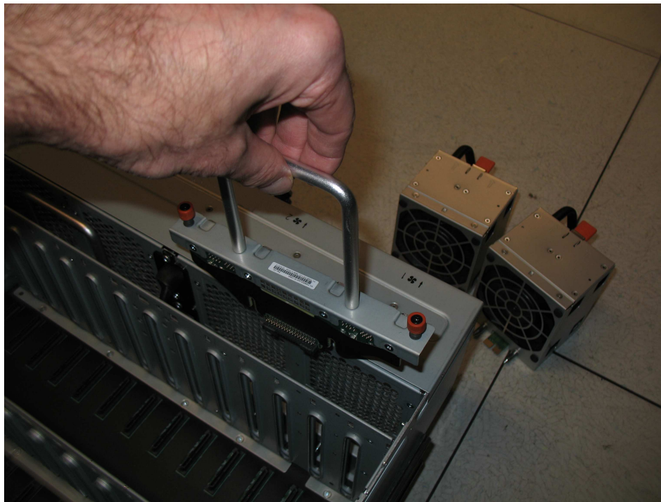
Figura 104. Insira a nova FIB no chassi
