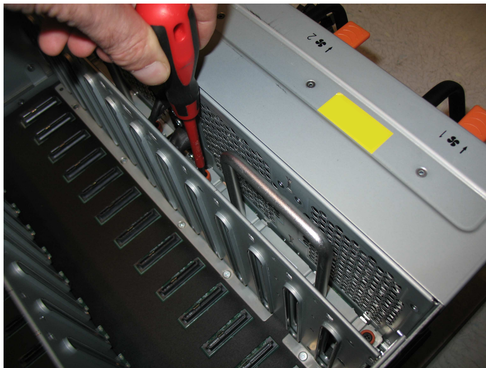
Figura 125. Solte os parafusos da FIB
