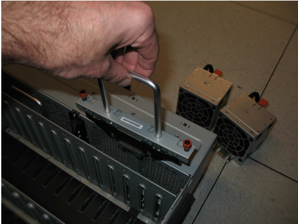
Рисунок 104. Вставка новой платы интерфейса вентиляции в шасси
