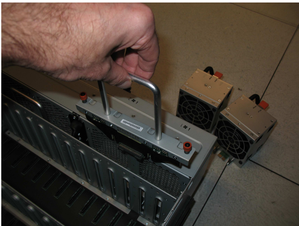
Рисунок 126. Удаление платы интерфейса вентиляции из шасси
