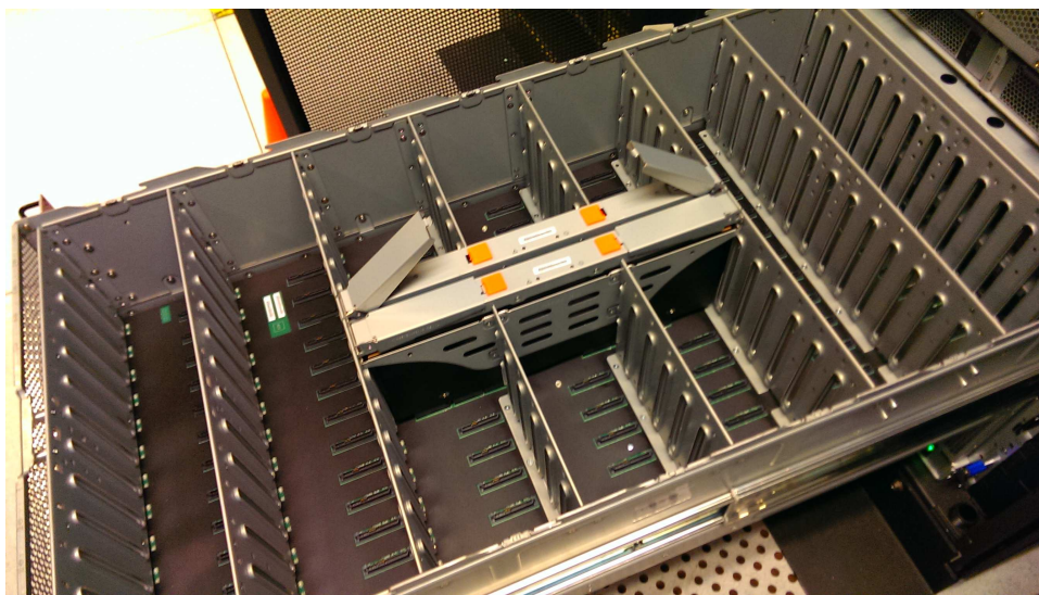
Рисунок 86. Расположение вспомогательных модулей расширения
