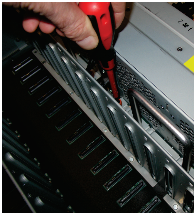
Рисунок 105. Прикрепление платы интерфейса вентиляции к плате накопителей
