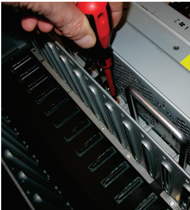
Рисунок 125. Ослабление винтов платы интерфейса вентиляции
