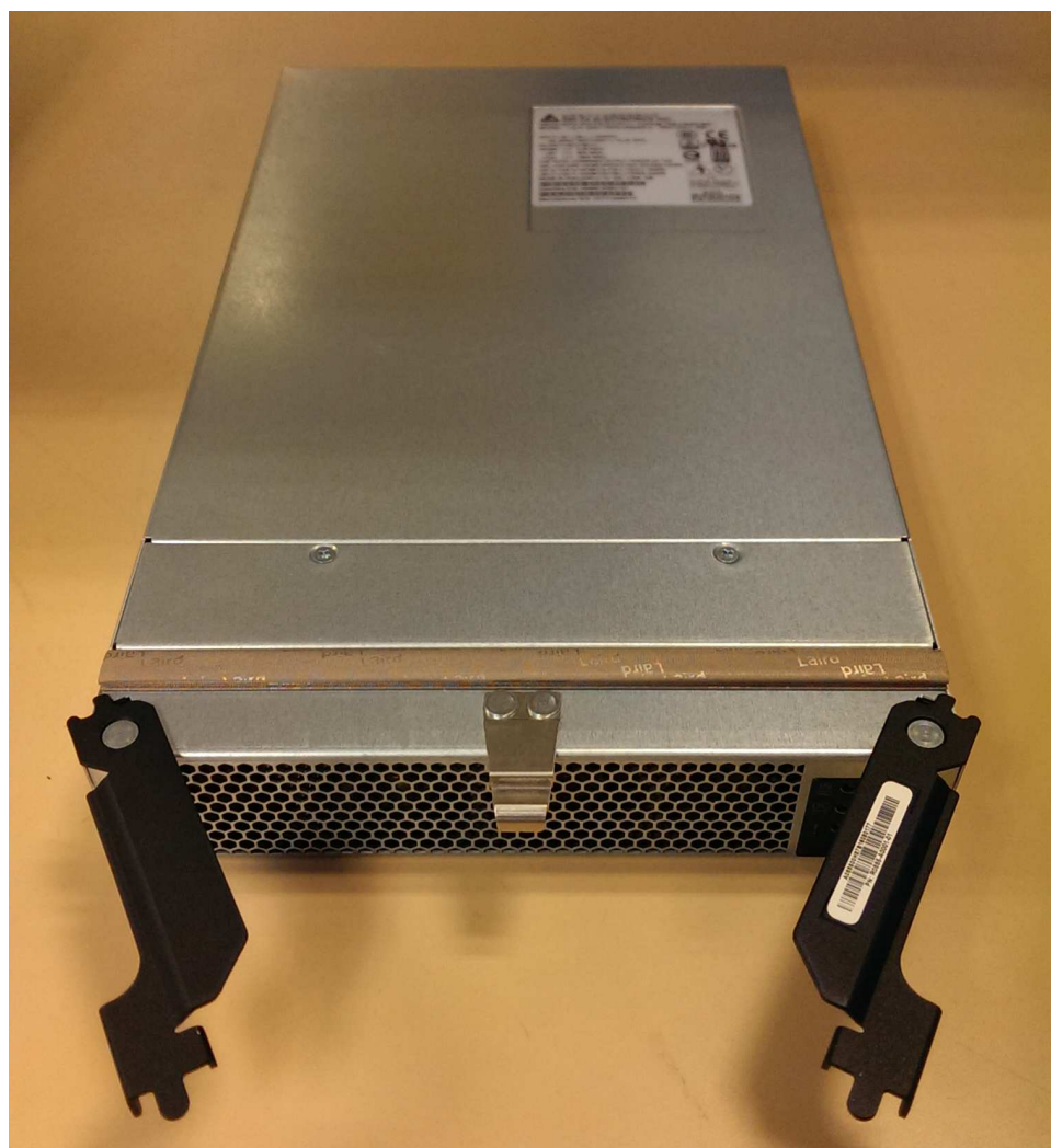
Рисунок 92. Подготовка к установке блока питания
