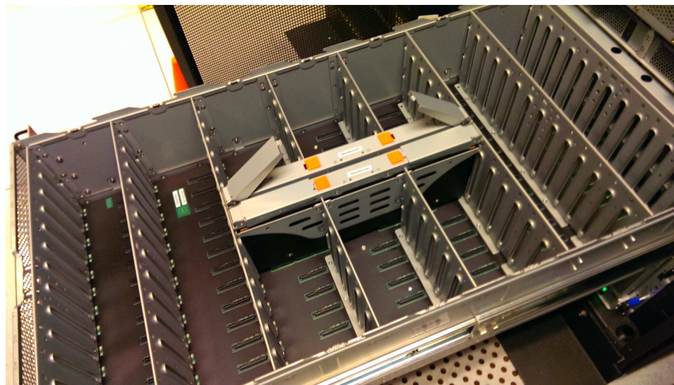
Рисунок 113. Расположение вспомогательных модулей расширения
