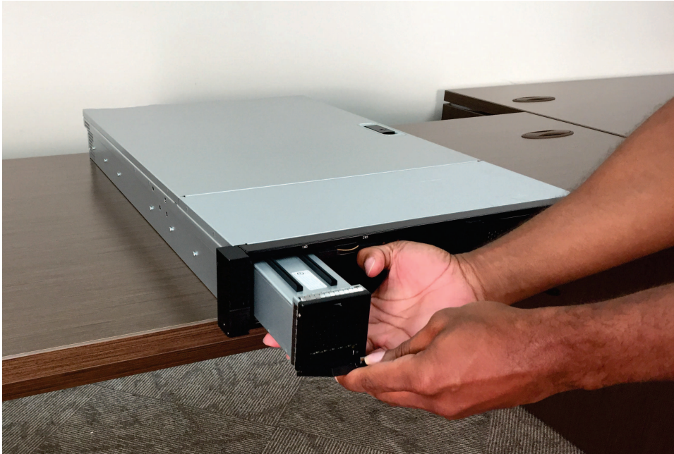
그림 124. 2145-SV1 노드에서 배터리 교체
