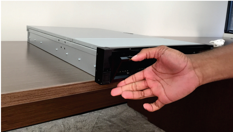
그림 121. 2145-SV1 노드에서 배터리 모듈 해제
