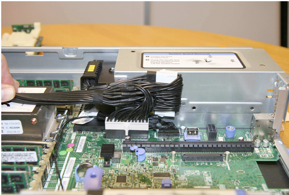
그림 116. 전원 공급 장치와 시스템 보드 사이의 전원 케이블 연결
