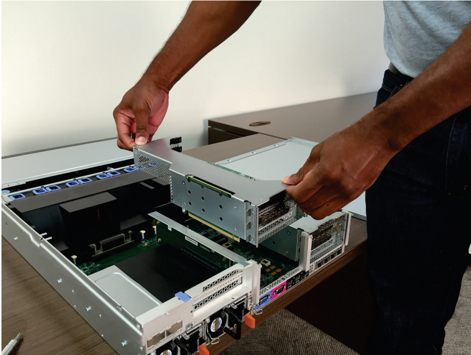
그림 148. PCI 라이저 카드 조립품 2를 잡아서 제거
