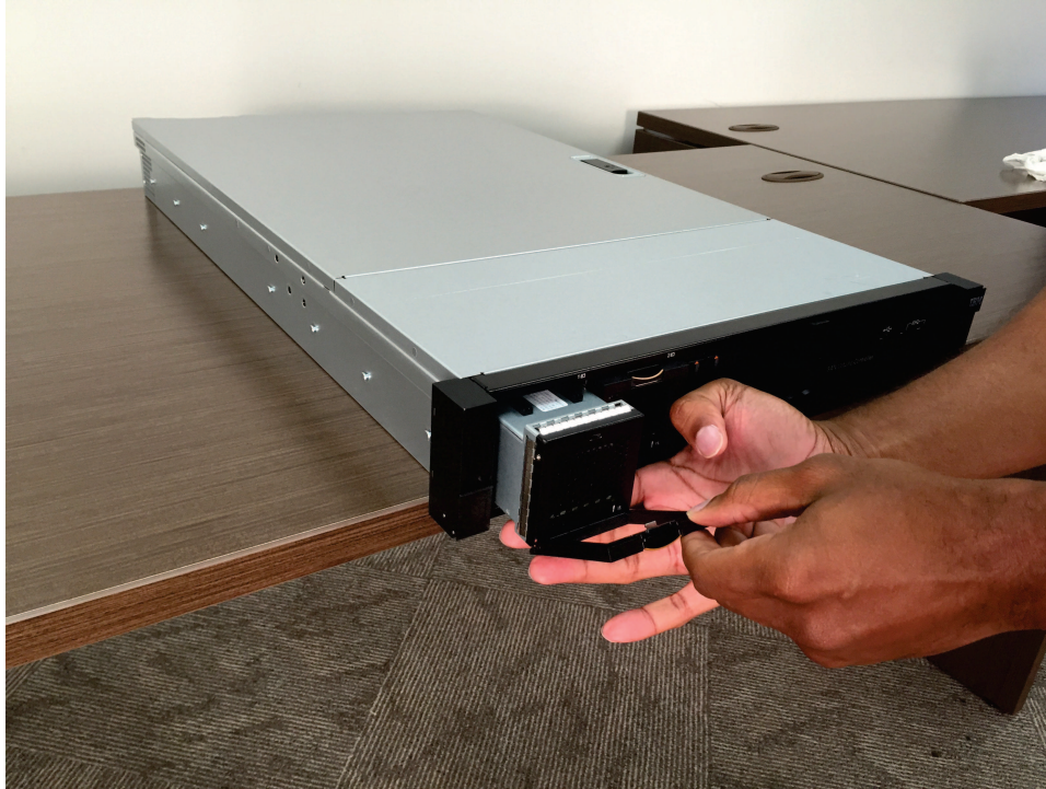
그림 122. 2145-SV1 노드의 배터리 제거
