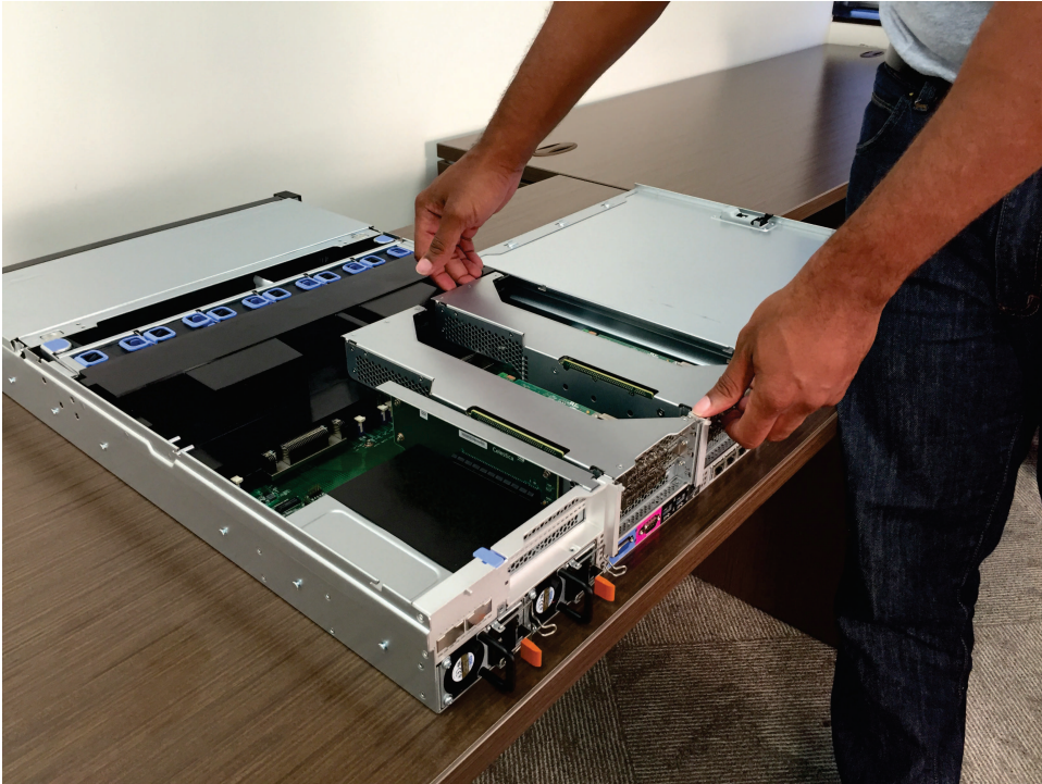
그림 146. PCI 라이저 카드 조립품 1 잡기
