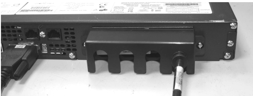
그림 229. 2145 UPS-1U에 연결된 2145 UPS-1U 케이블 고정 브래킷
