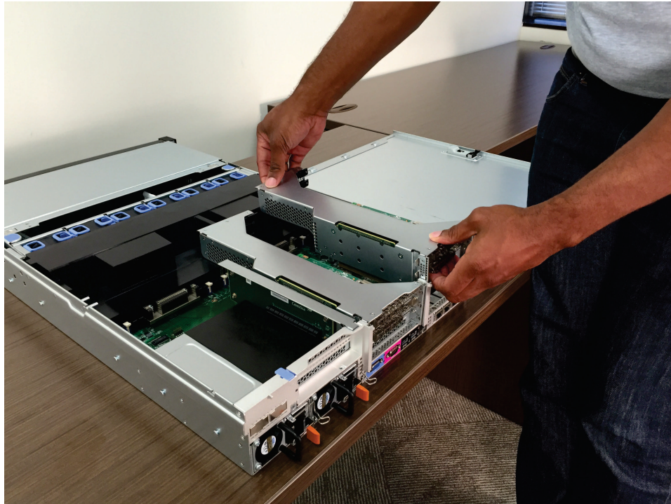
그림 147. PCI 라이저 카드 조립품 1 제거
