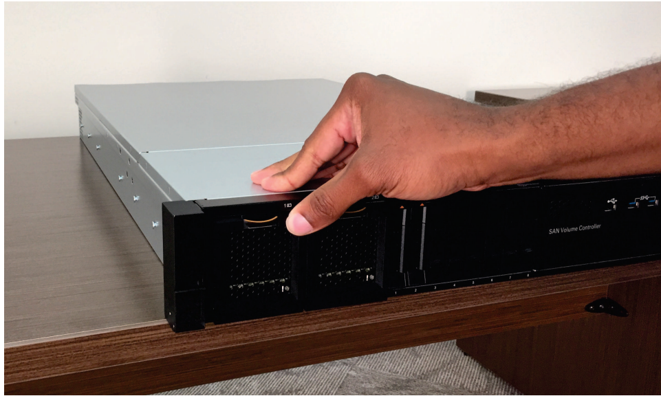
그림 125. 배터리 해제 핸들 닫기
