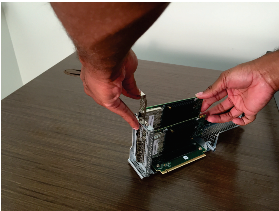
그림 157. PCI 커넥터에 어댑터 삽입
