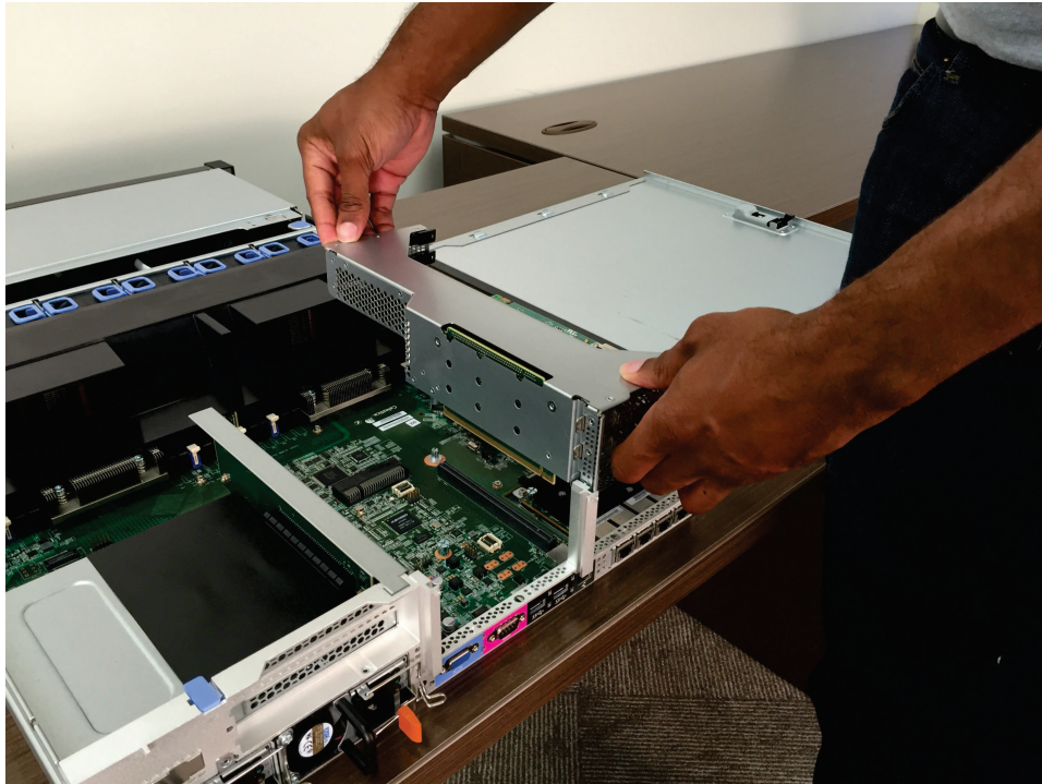
그림 150. PCI 라이저 카드 조립품 1 맞추기
