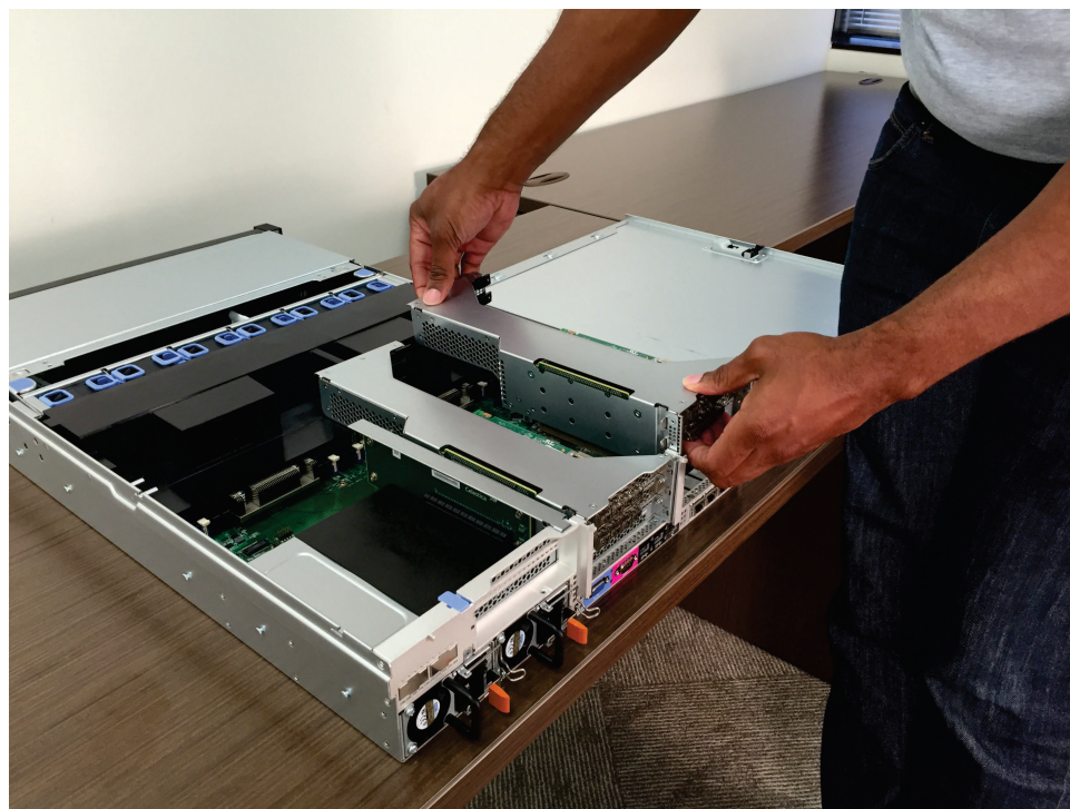
图 147. 卸下 PCI 转接卡组合件 1
