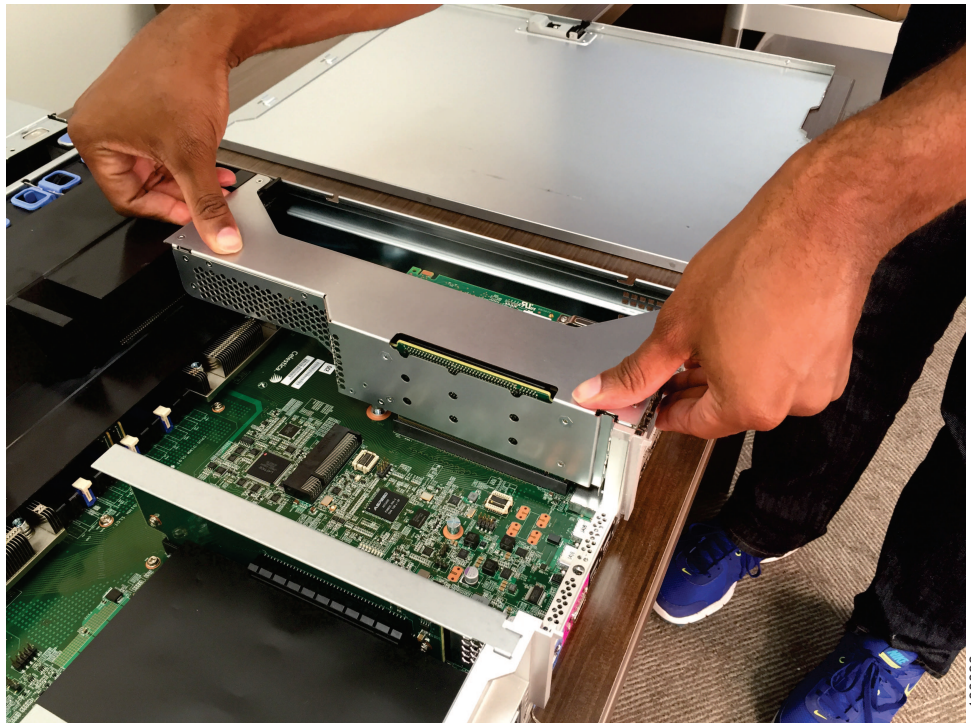
图 151. 更换 PCI 转接卡组件 1
