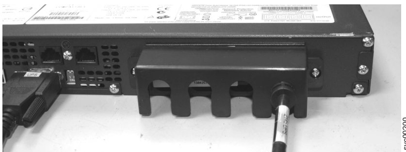
图 217. 2145 UPS-1U 电源线固定支架
