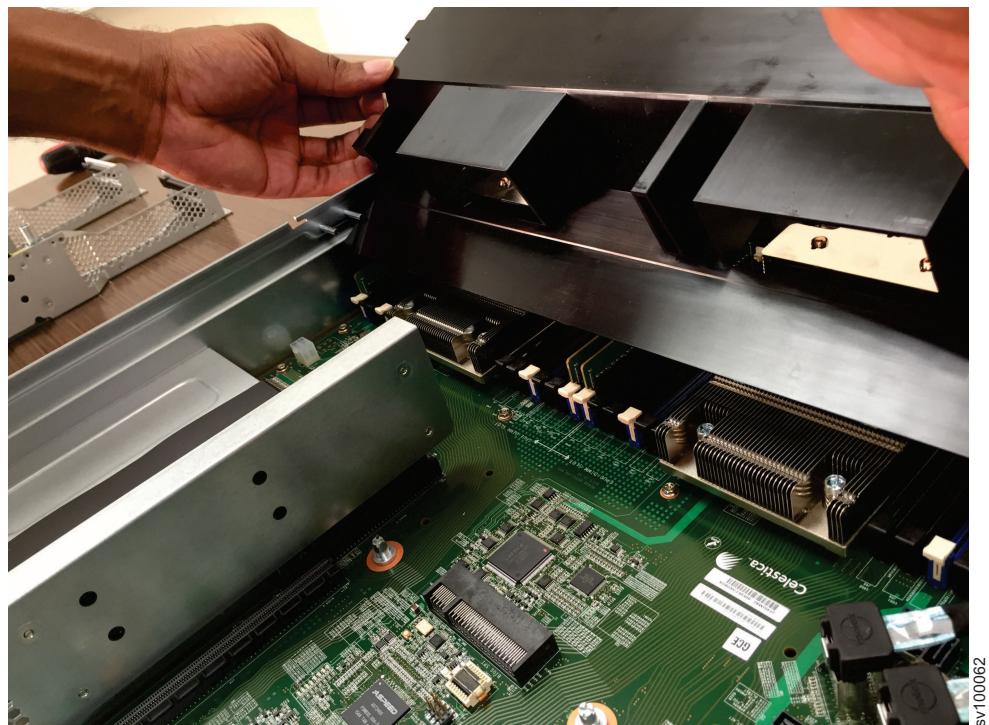
图 58. 卸下空气挡板
