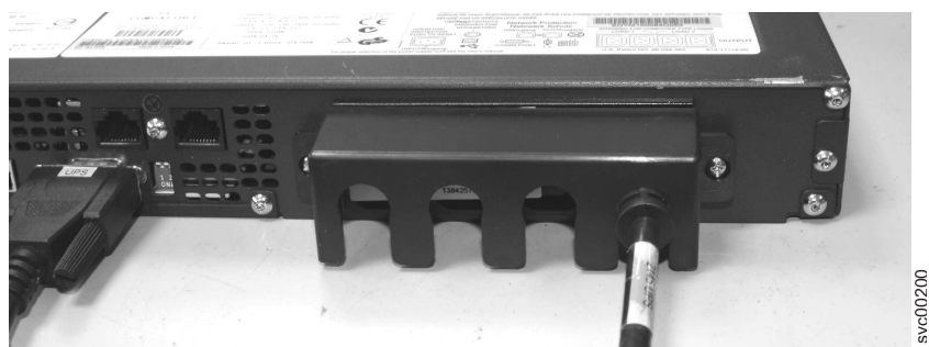
图 229. 连接到 2145 UPS-1U 的 2145 UPS-1U 电缆固定支架
