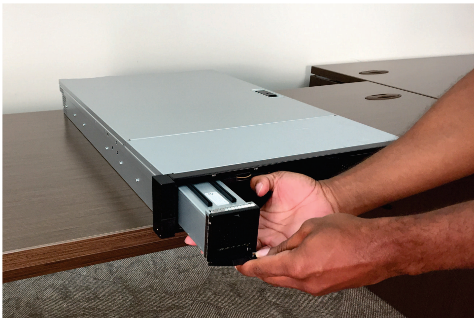
图 124. 更换 2145-SV1 节点中的电池
