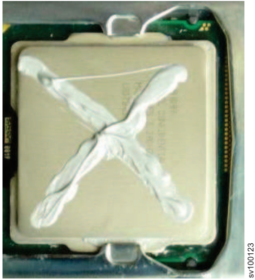
图 192. 将导热油脂涂在 2145-SV1 微处理器上
