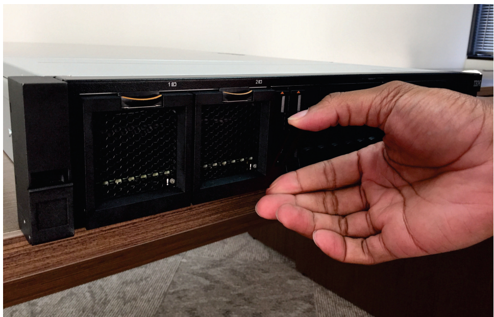
图 82. 在 2145-SV1 引导驱动器上操作释放手柄
