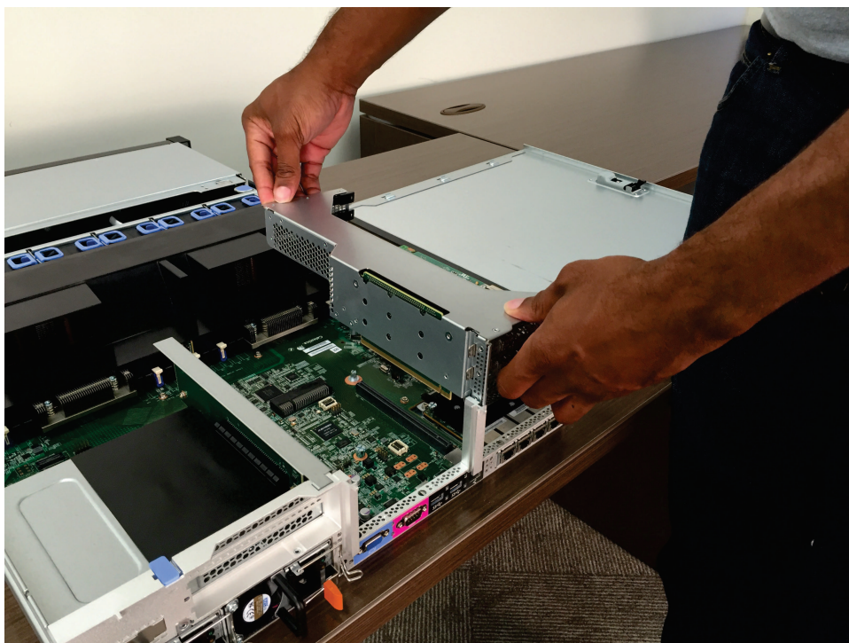
图 150. 对齐 PCI 转接卡组合件 1
