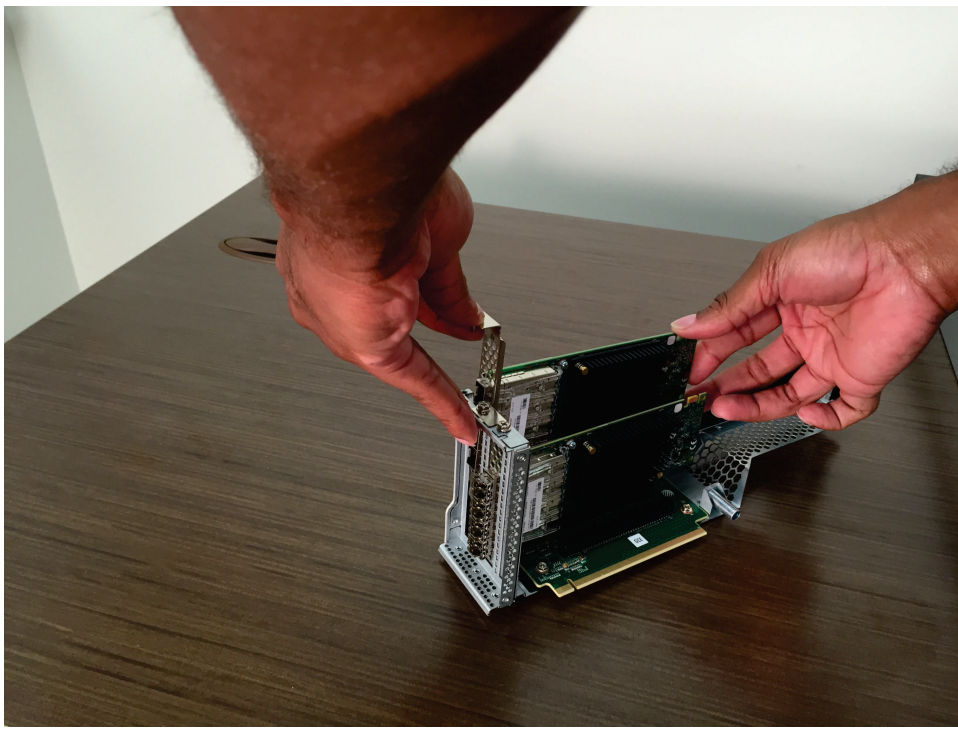
图 157. 将适配器插入 PCI 接口
