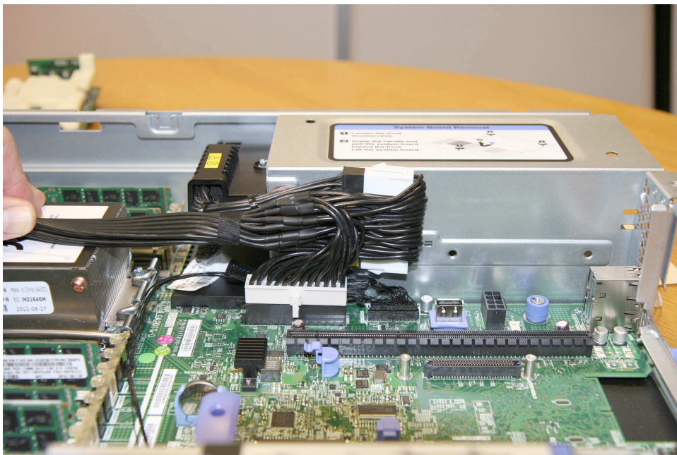
图 116. 电源单元和主板之间的电源线连接
