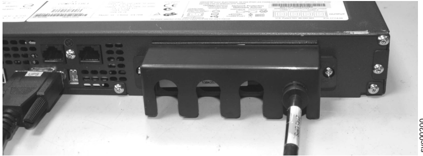
图 216. 2145 UPS-1U 电源线固定支架
