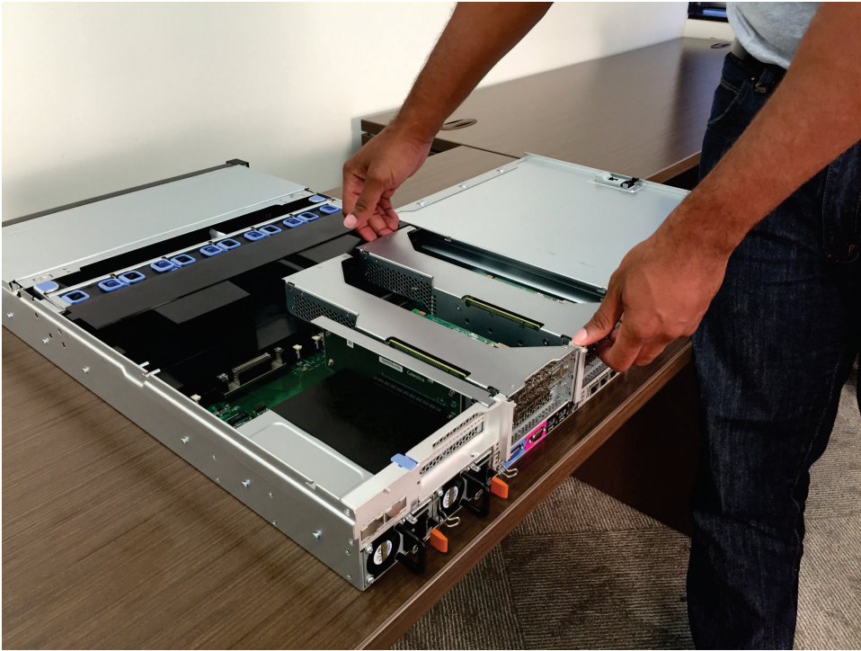
图 146. 握住 PCI 转接卡组合件 1
