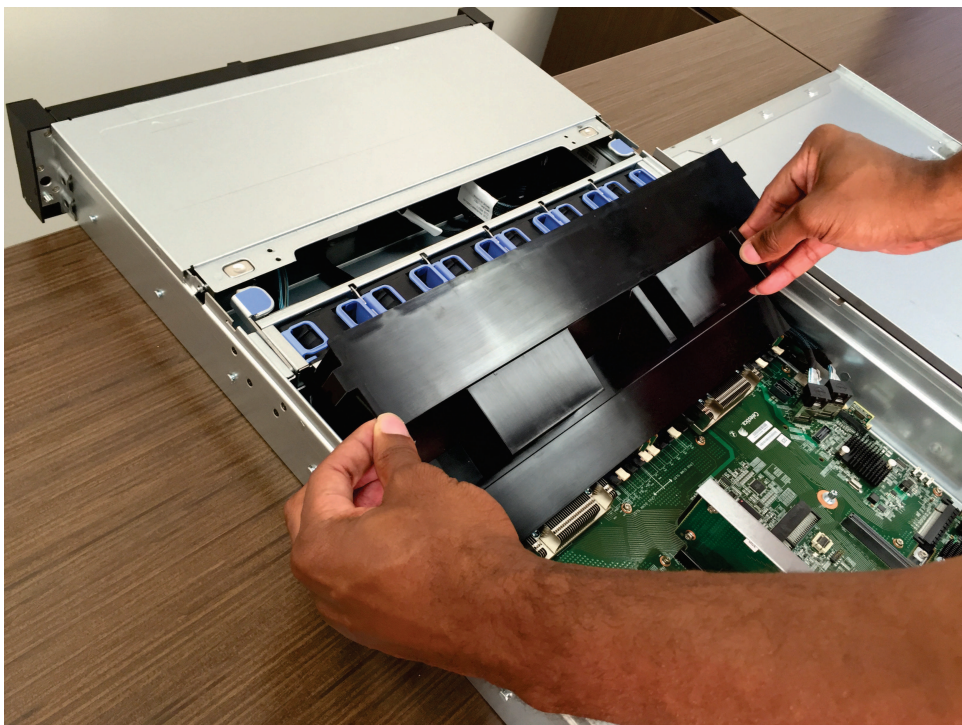
图 57. 卸下空气挡板
