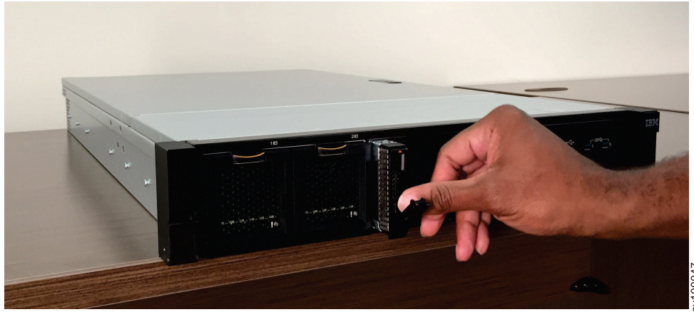
图 86. 更换 2145-SV1 引导驱动器
