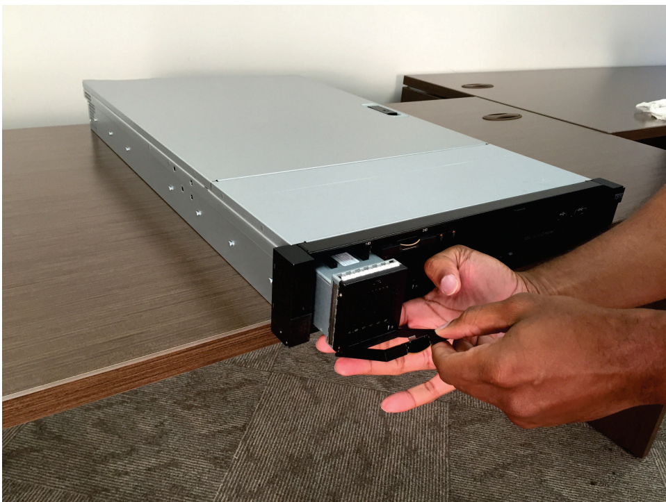
图 122. 卸下 2145-SV1 节点中的电池
