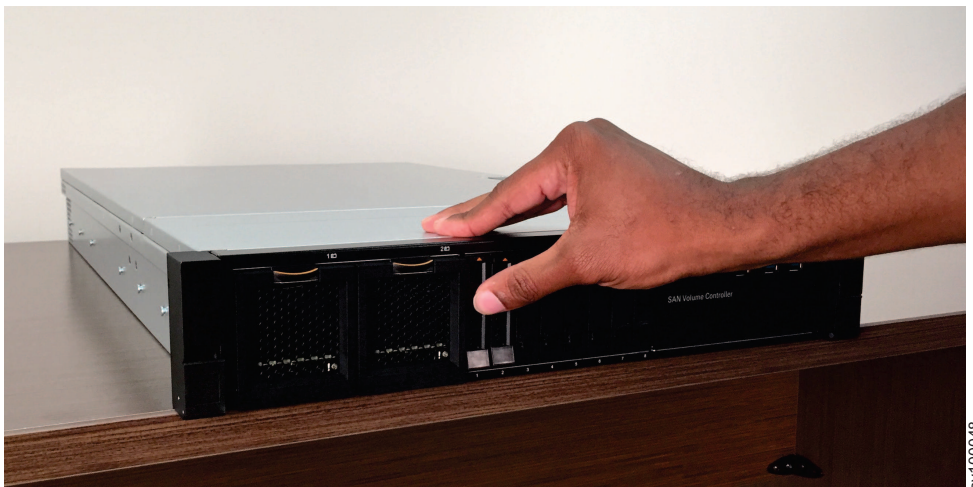
图 87. 在 2145-SV1 引导驱动器上闭合释放手柄
