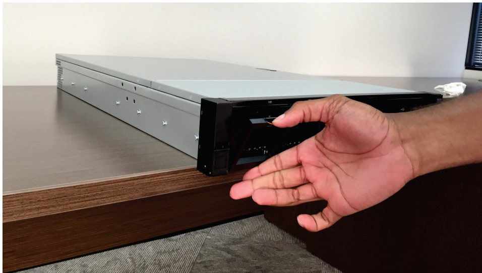
图 121. 松开 2145-SV1 节点上的电池模块
