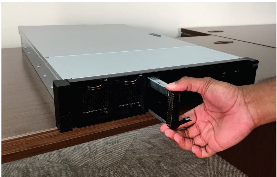
图 83. 卸下 2145-SV1 引导驱动器
