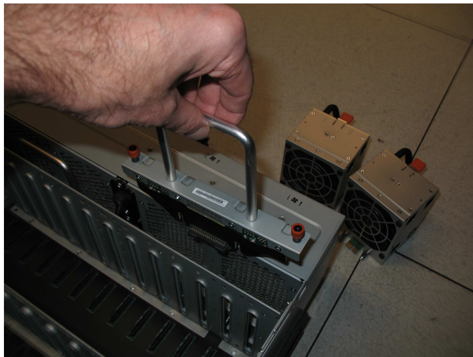
图 104. 在机箱中插入新的 FIB
