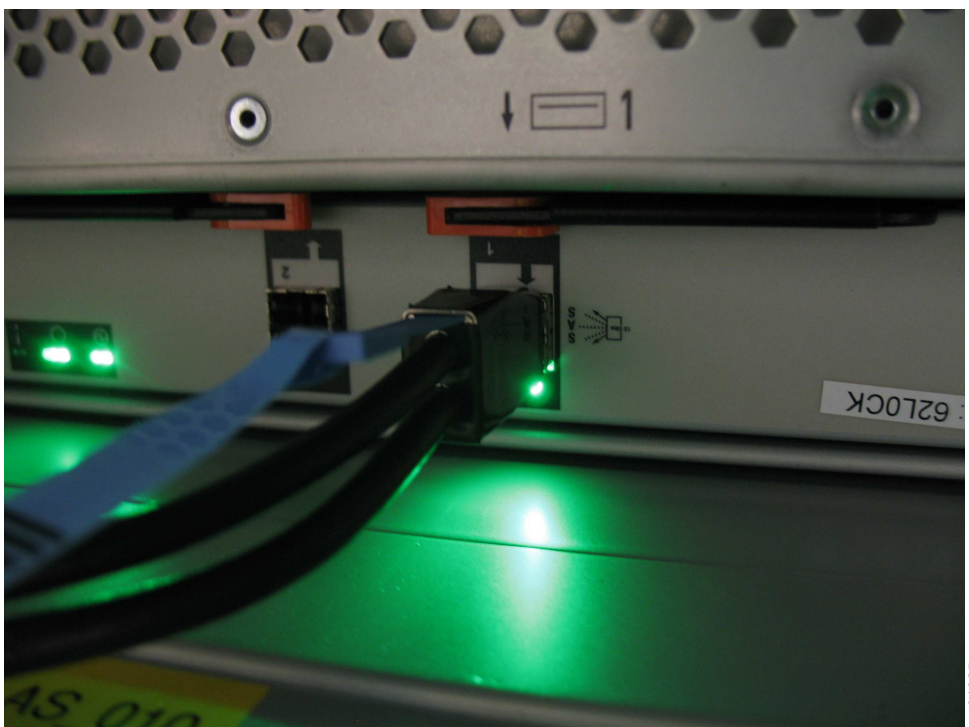
图 100. SAS 电缆已正确插入到 SAS 端口中
