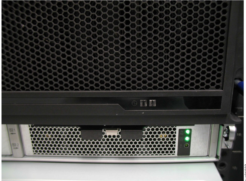
图 97. 从 PSU 卸下的面板
