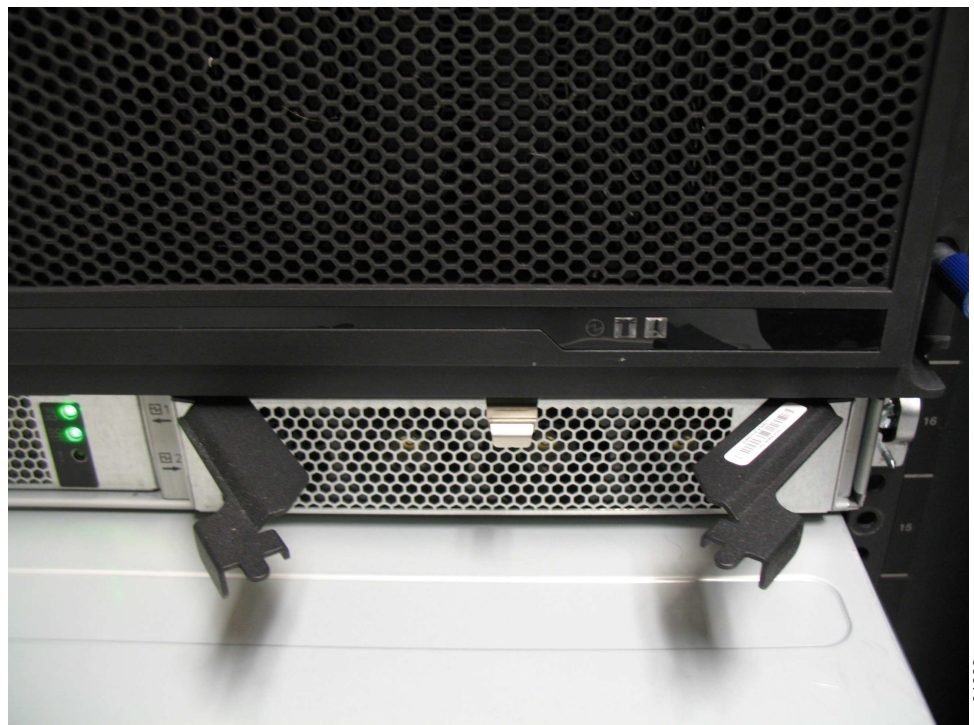
图 93. 安装电源
