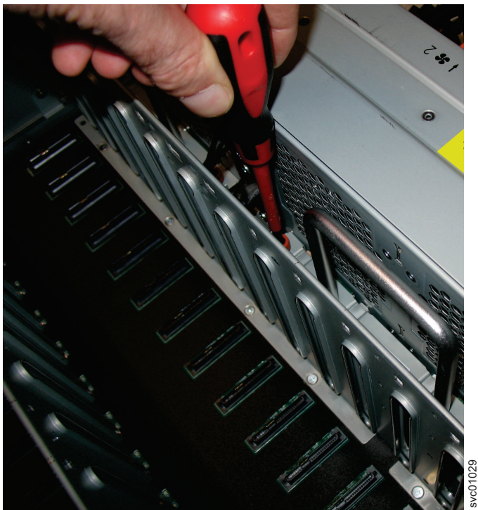
图 105. 将 FIB 固定到驱动器板上
