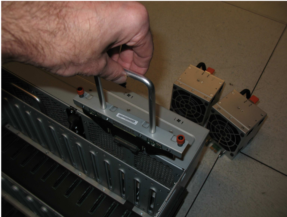
圖 126. 從基座移除 FIB
