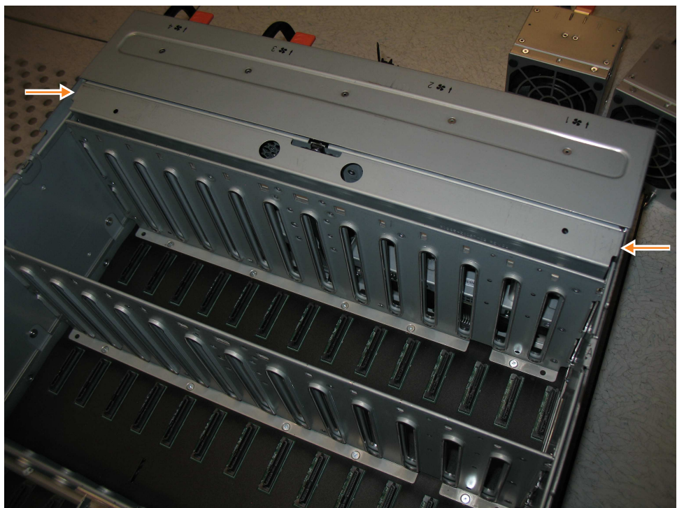
圖 106. 裝回 FIB 蓋板
