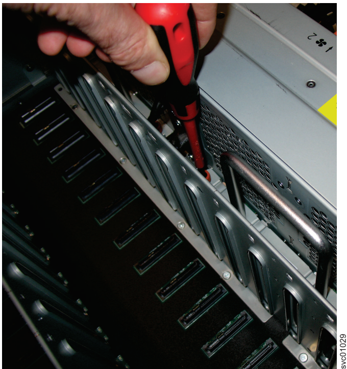
圖 105. 將 FIB 固定到磁碟機板
