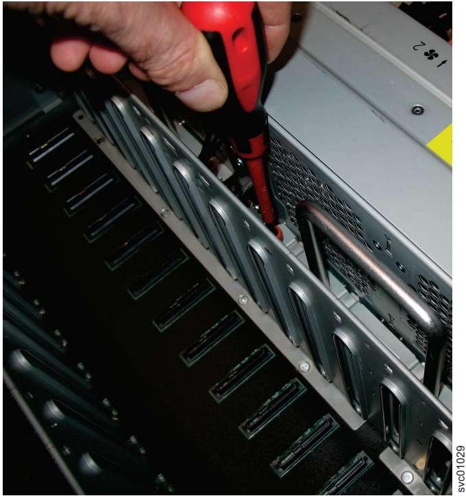
Abbildung 105. Lüfterschnittstellenplatine an Laufwerkplatine befestigen
