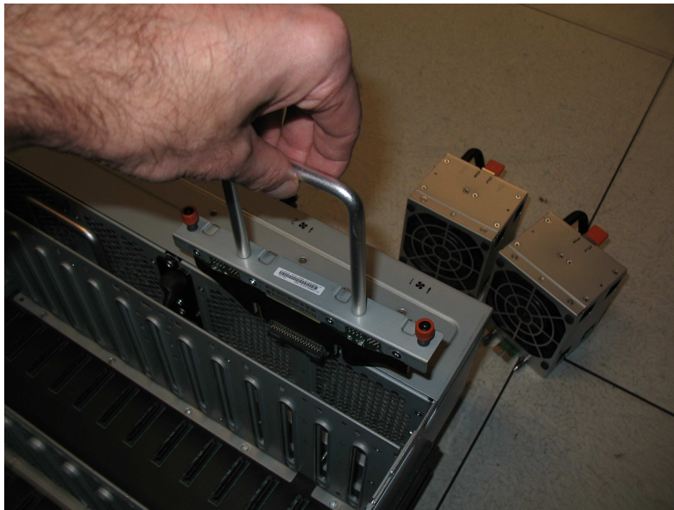
Abbildung 104. Neue Lüfterschnittstellenplatine in Chassis einsetzen
