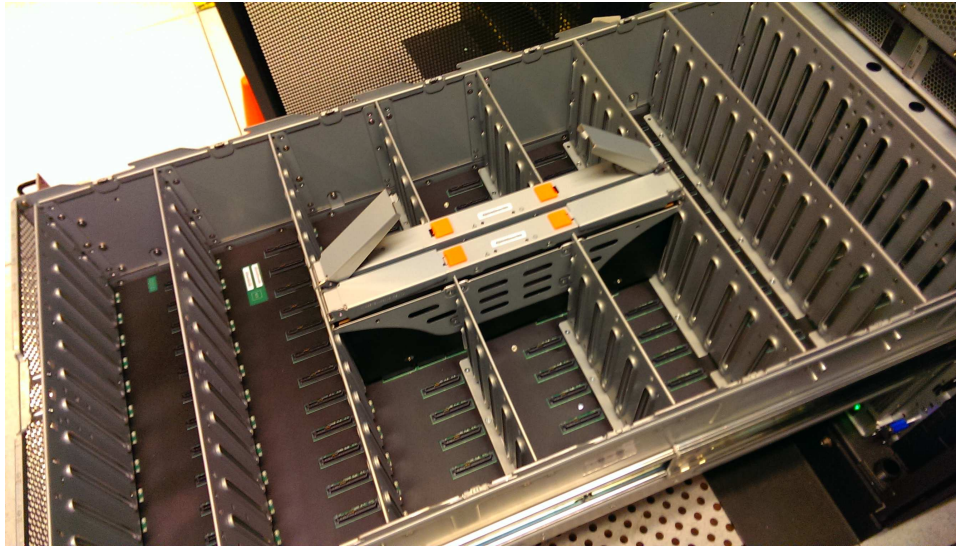
Abbildung 86. Position sekundärer Erweiterungsmodule
