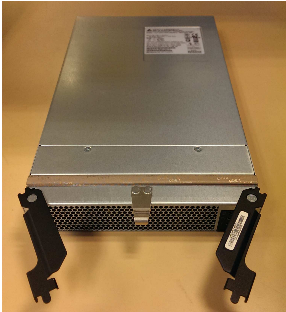
Abbildung 109. Entferntes Netzteil
