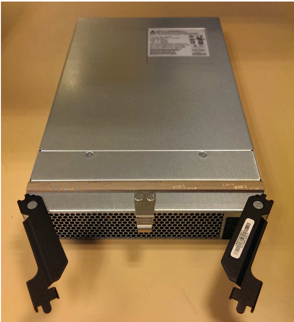
Abbildung 92. Installation des Netzteils vorbereiten
