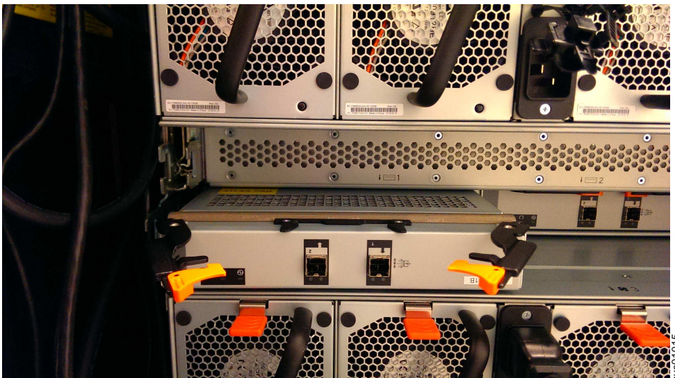
Abbildung 119. Erweiterungseinschub entfernen
