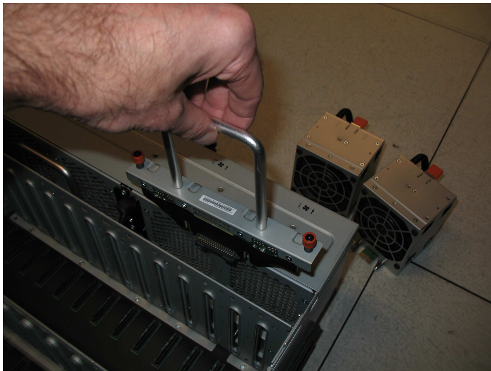
Abbildung 126. Lüfterschnittstellenplatine aus Chassis entfernen
