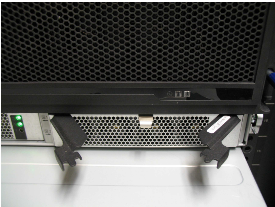
Abbildung 108. Netzteilgriffe entriegeln
