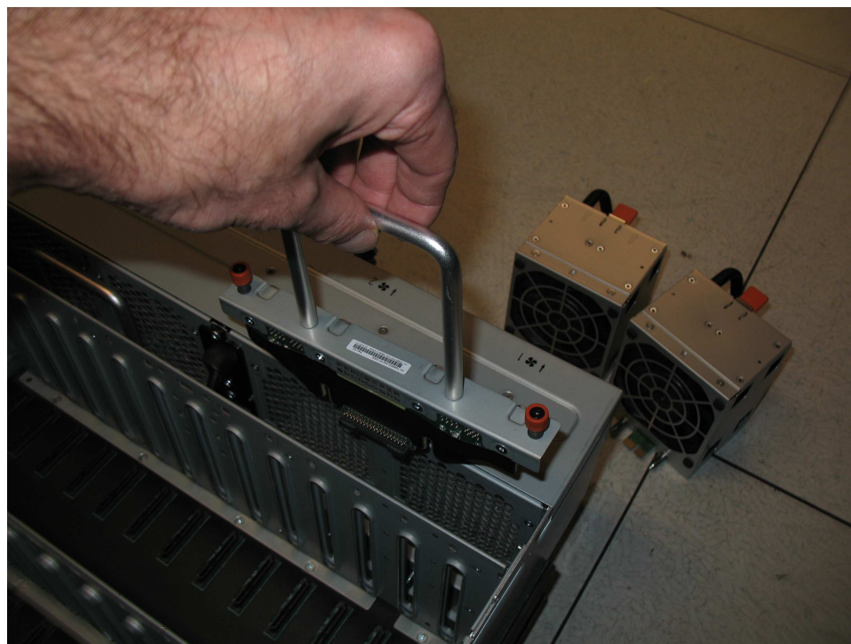
Figura 126. Extraer la FIB del chasis
