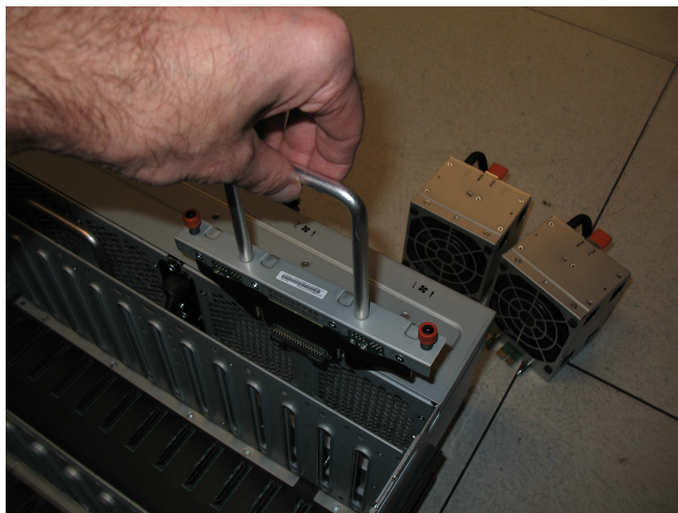
Figura 104. Insertar la nueva FIB en el chasis
