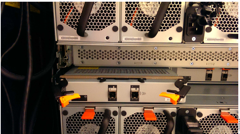
Figura 119. Extracción del recipiente de expansión
