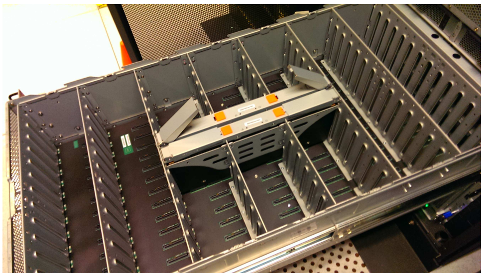
Figura 113. Ubicación de los módulos expansores secundarios
