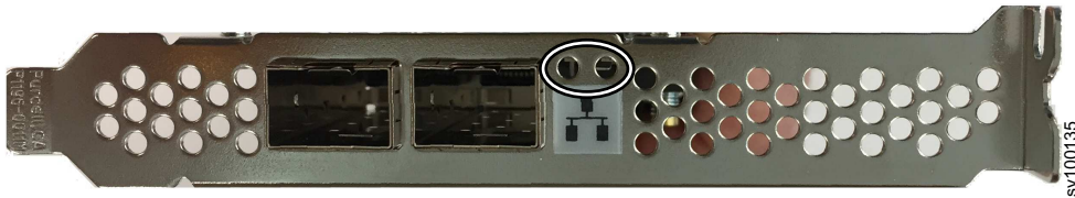
Figura 12. LEDs y puertos adaptador de interfaz de host Ethernet de 25 Gbps (iWARP)
