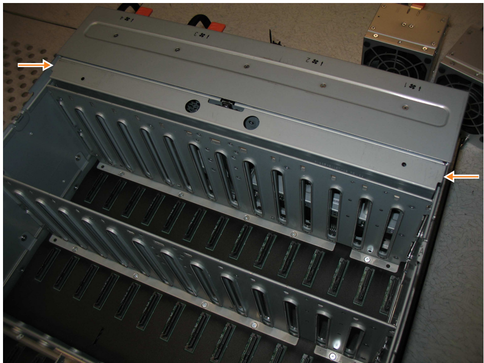
Figura 124. Ubicación de la cubierta de FIB
