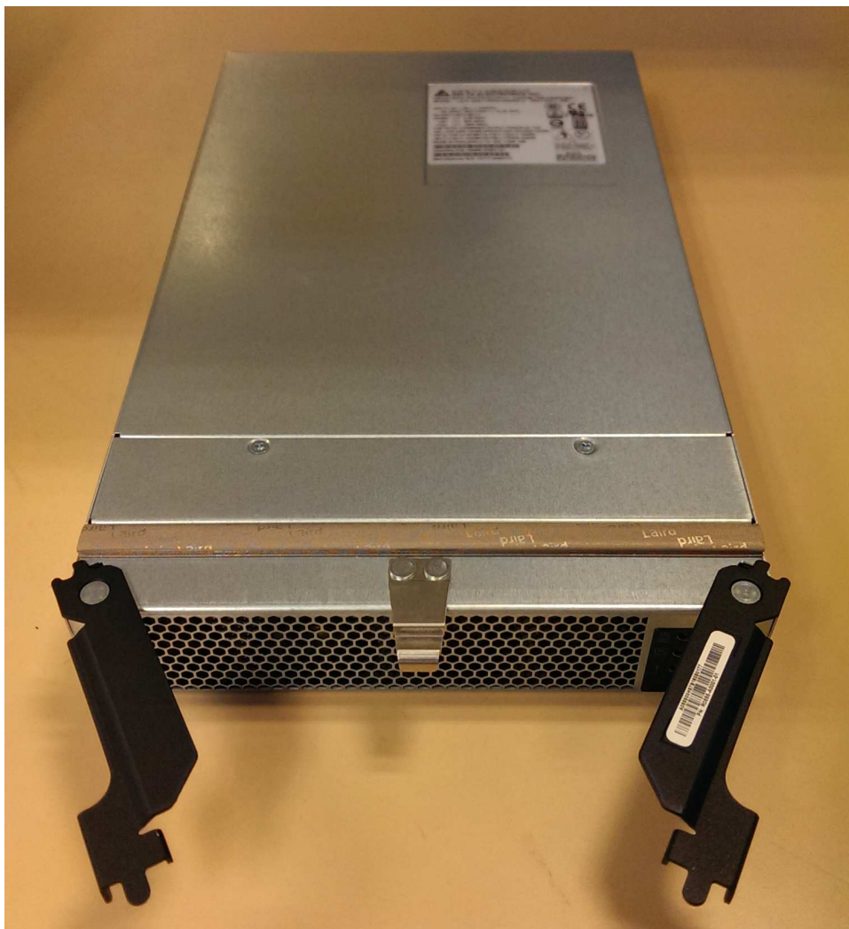
Figure 109. Alimentation électrique retirée
