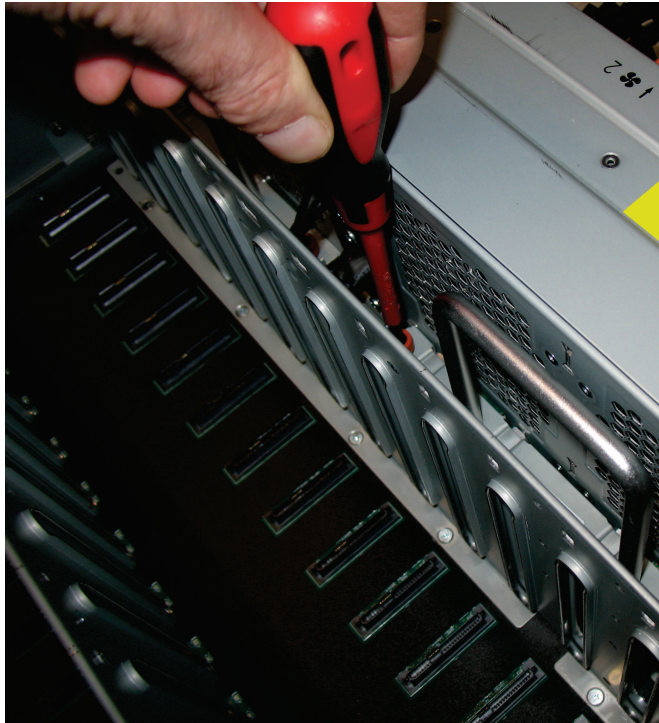
Figure 105. Fixation de la FIB sur la carte mère de l'unité
