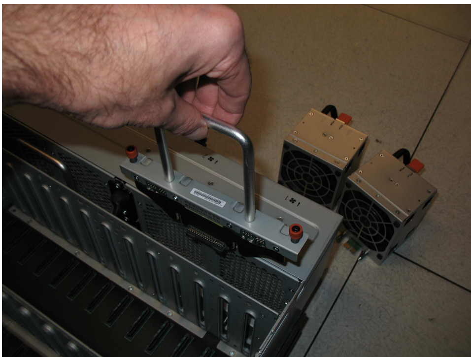
Figure 126. Retirez la FIB du châssis
