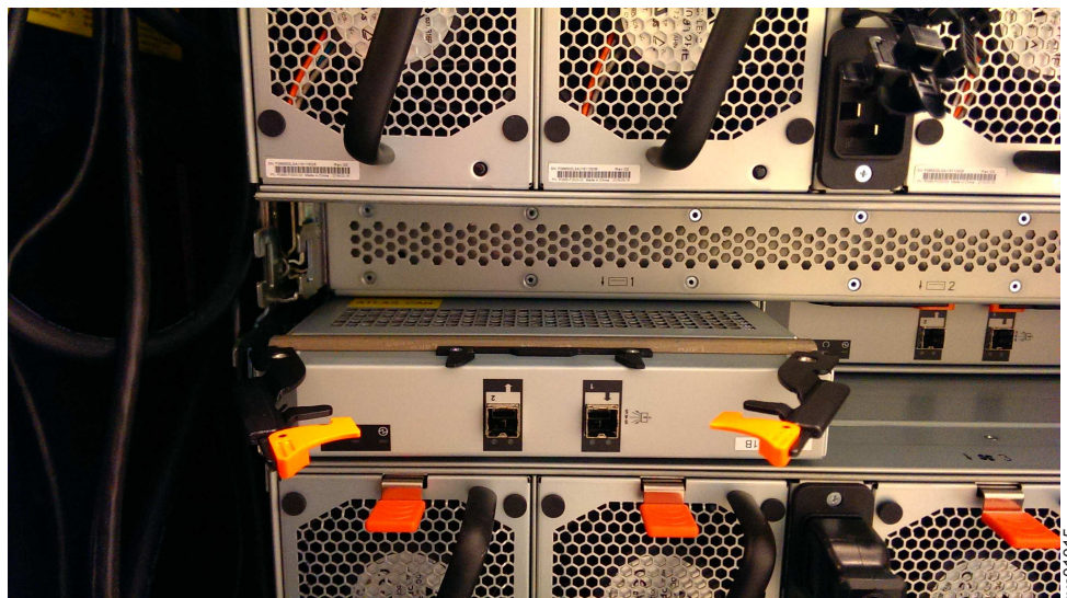
Figure 119. Retrait de la cartouche d'extension
