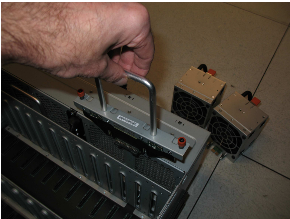
図 104. シャーシへの新規 FIB の装着
