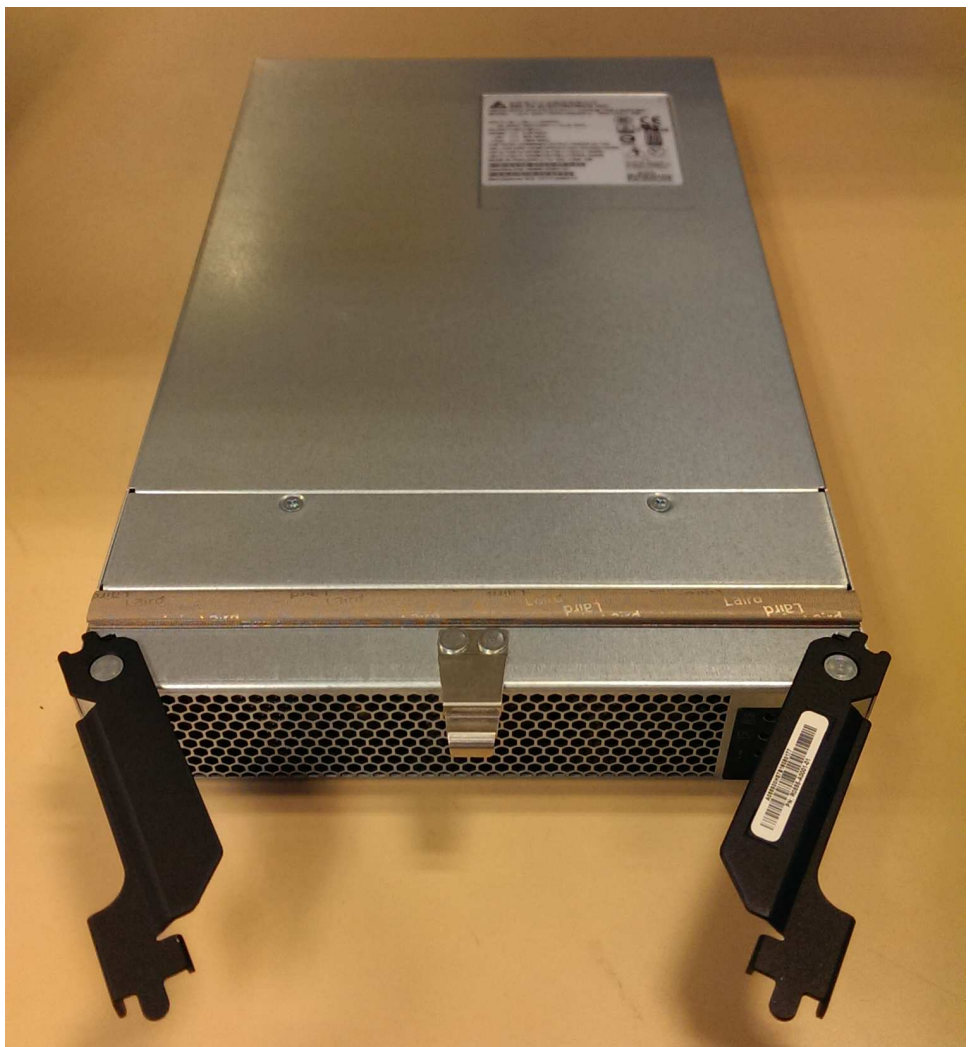
図 109. 取り出された電源機構
