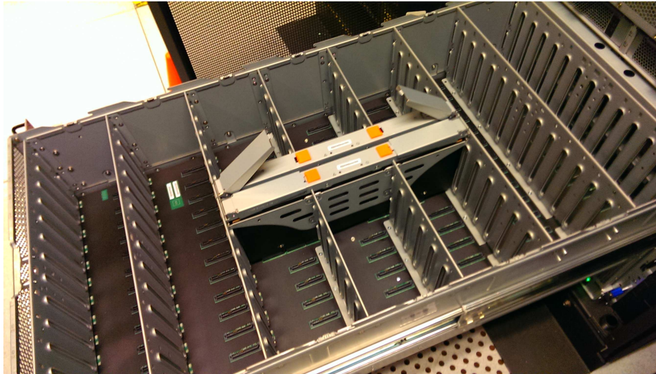
図 113. 2 次拡張機構モジュールの位置
