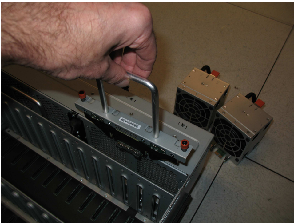
Figura 104. Insira a nova FIB no chassi
