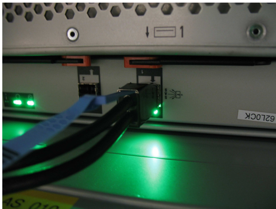
Figura 100. Cabo SAS inserido corretamente na porta SAS
