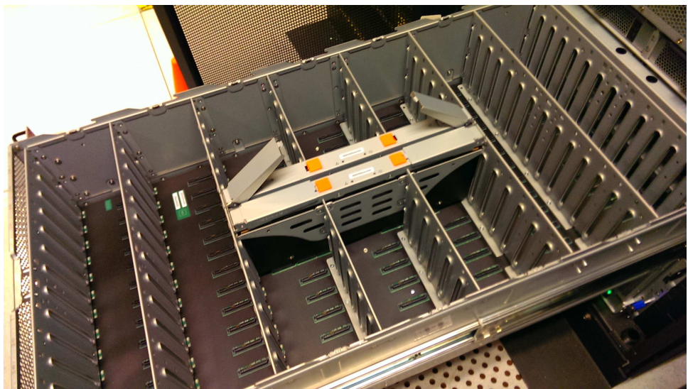
Рисунок 113. Расположение вспомогательных модулей расширения
