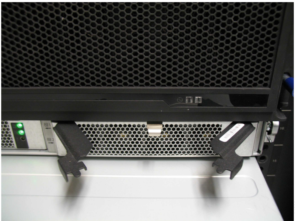
Рисунок 108. Освобождение ручек блока питания
