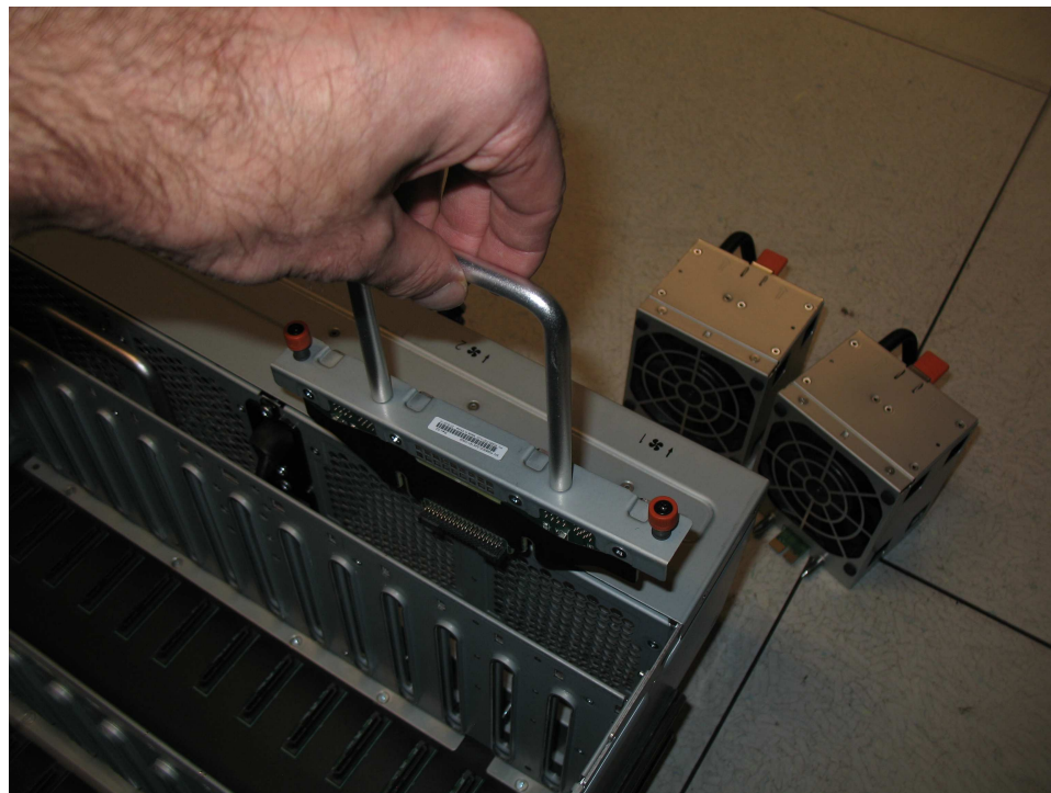
Рисунок 104. Вставка новой платы интерфейса вентиляции в шасси
