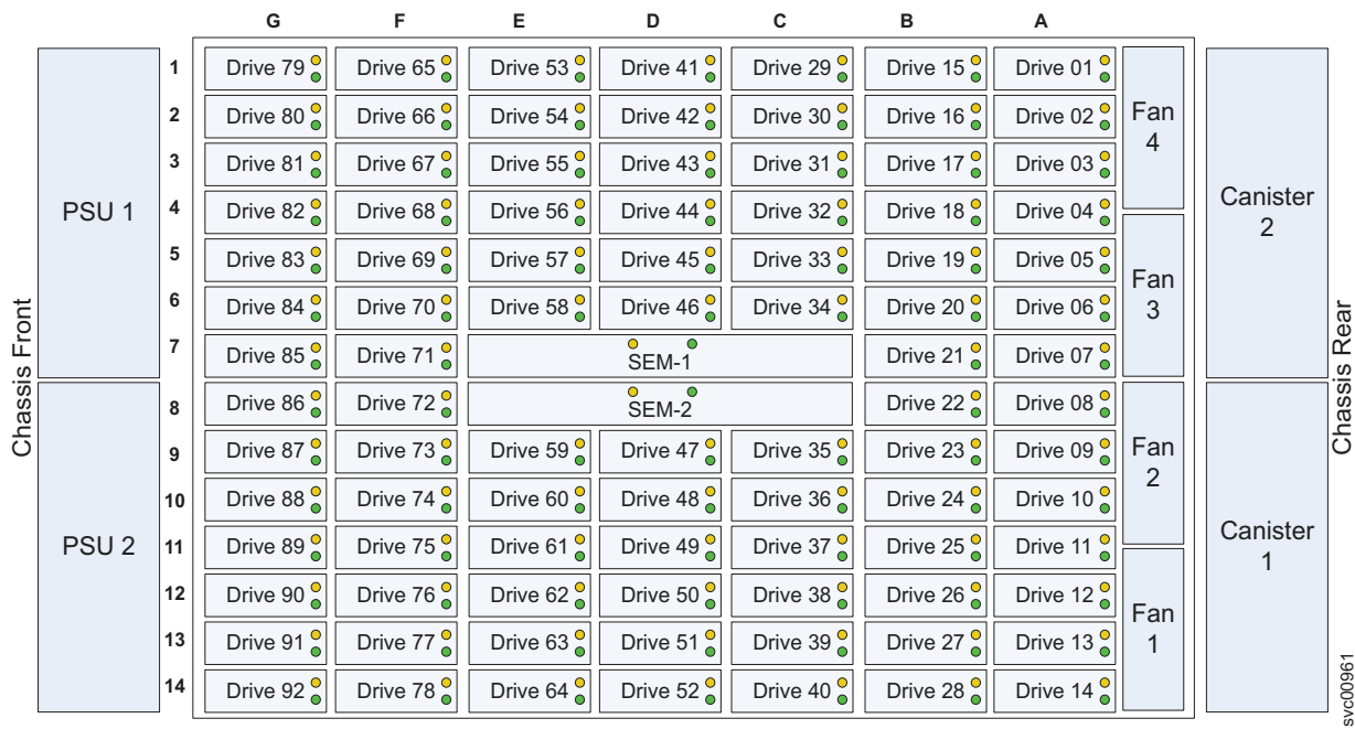
Рисунок 146. Индикаторы накопителей и вспомогательных модулей расширения
