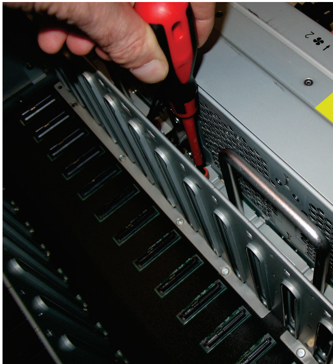
Рисунок 125. Ослабление винтов платы интерфейса вентиляции
