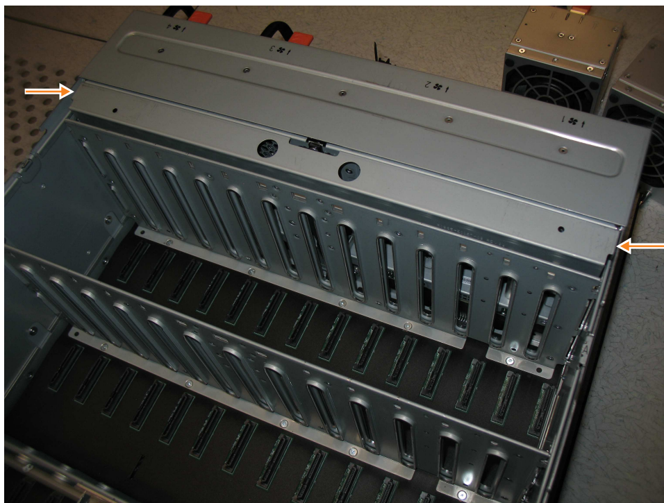
Рисунок 106. Замена крышки платы интерфейса вентиляции
