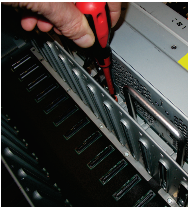
Рисунок 105. Прикрепление платы интерфейса вентиляции к плате накопителей
