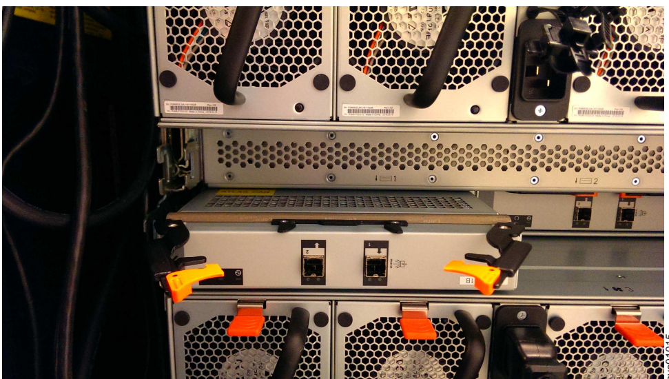
Рисунок 119. Удаление кейса расширения
