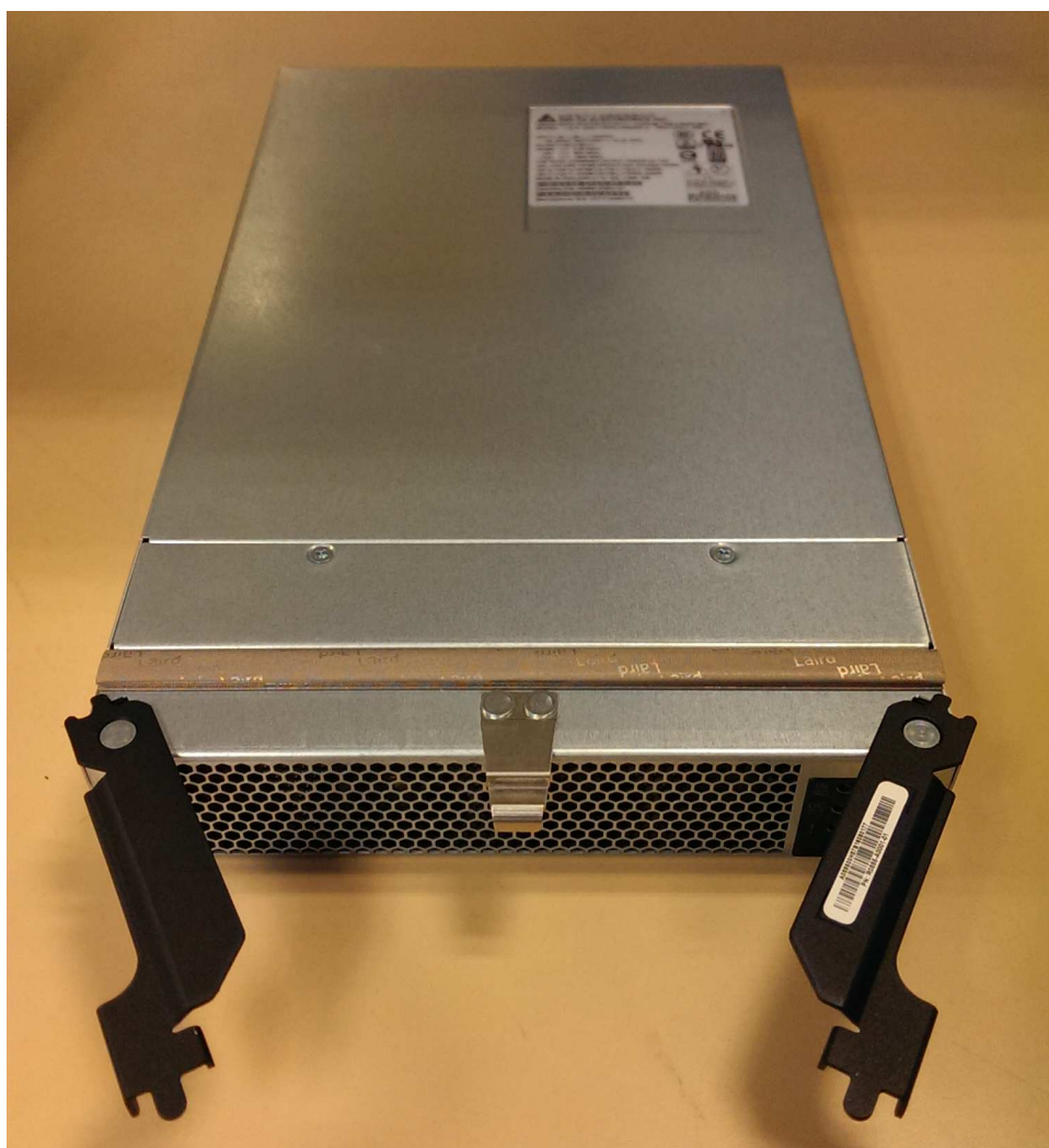
Рисунок 92. Подготовка к установке блока питания
