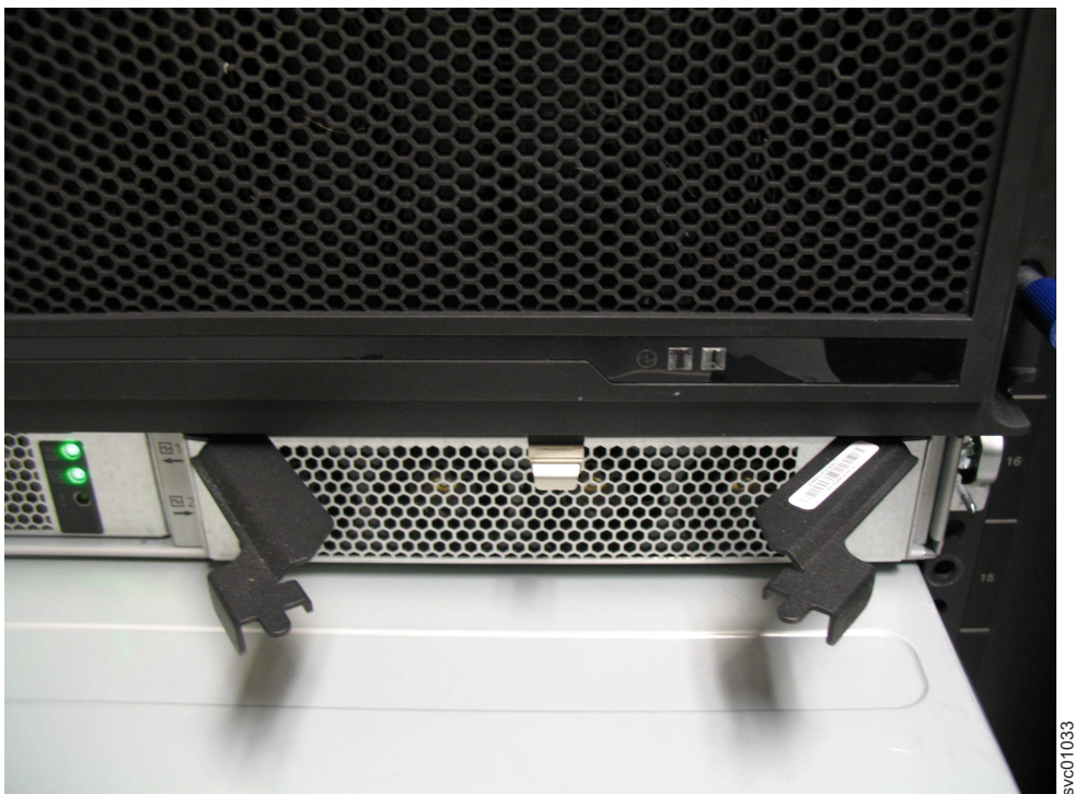
图 93. 安装电源
