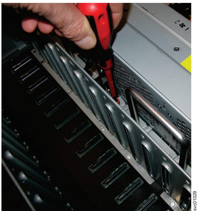
图 125. 拧松 FIB 螺钉
