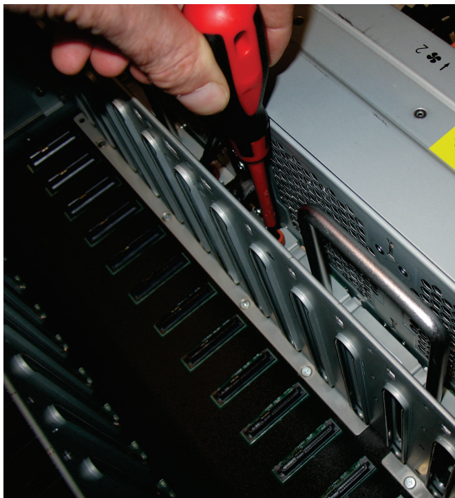
图 105. 将 FIB 固定到驱动器板上
