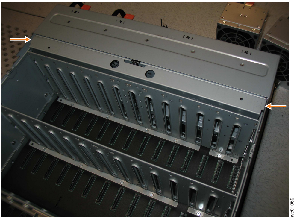
图 106. 重新安装 FIB 外盖
