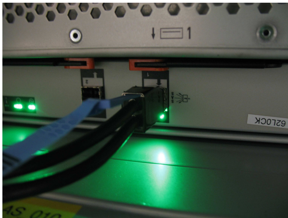
图 100. SAS 电缆已正确插入到 SAS 端口中
