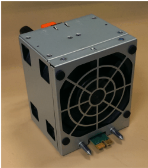
Figure 101. Fan module orientation
