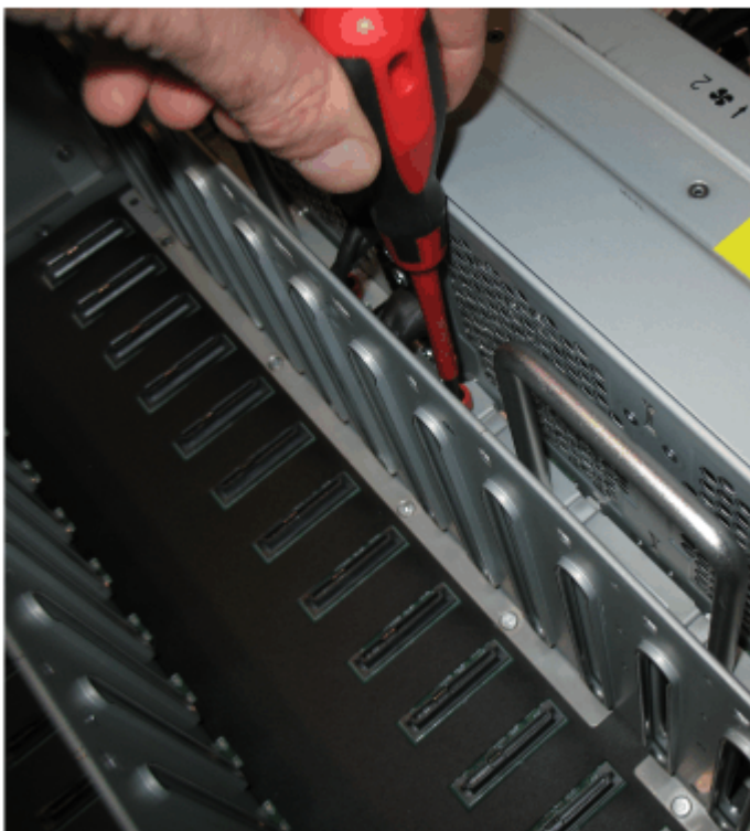
Abbildung 125. Schrauben der Lüfterschnittstellenplatine lösen
