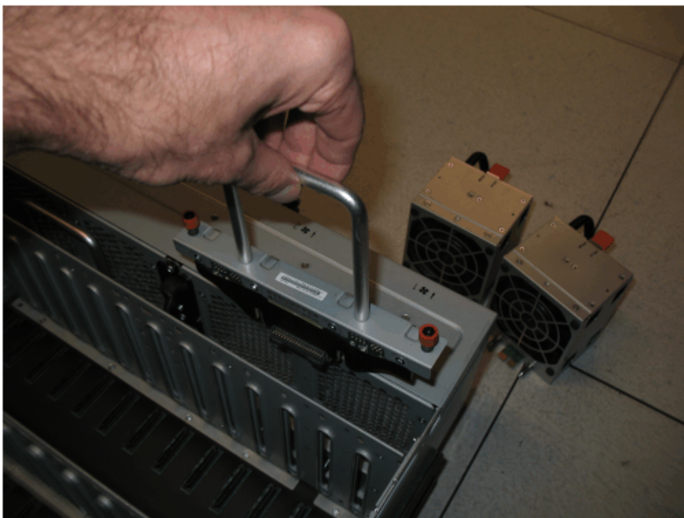
Abbildung 104. Neue Lüfterschnittstellenplatine in Chassis einsetzen
