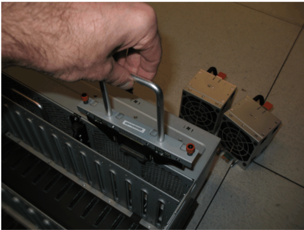
Abbildung 126. Lüfterschnittstellenplatine aus Chassis entfernen
