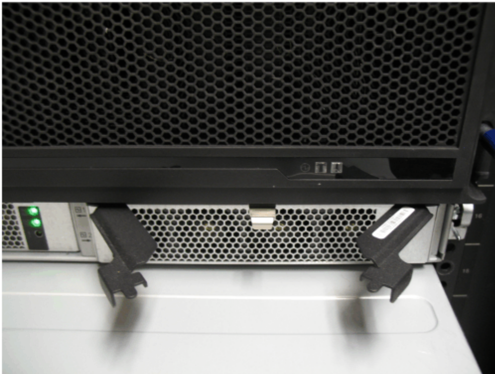
Abbildung 93. Netzteil installieren
