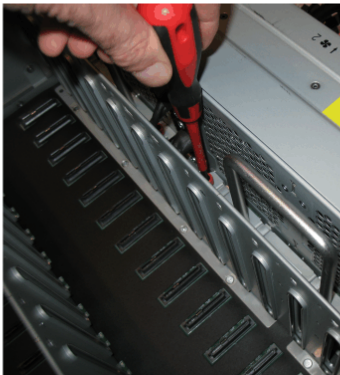
Abbildung 105. Lüfterschnittstellenplatine an Laufwerkplatine befestigen
