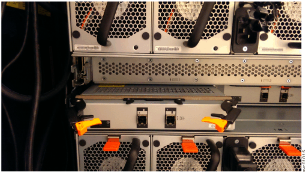
Abbildung 119. Erweiterungseinschub entfernen
