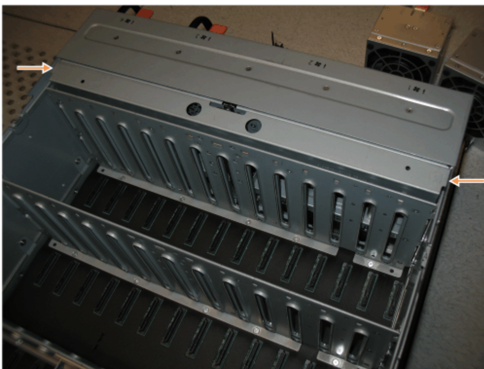
Figure 124. Emplacement du capot de la carte d'interface de ventilateur
