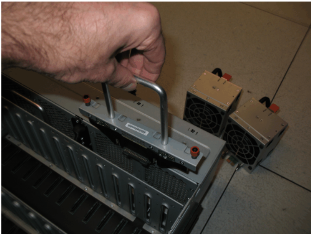
Figure 126. Retrait de la carte d'interface de ventilateur du châssis
