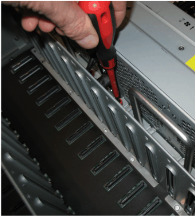
Figure 125. Dévissage des vis de la carte d'interface de ventilateur
