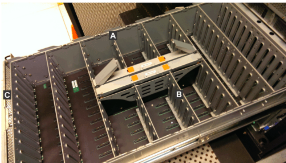
Figure 86. Emplacement des modules d'extension secondaires
