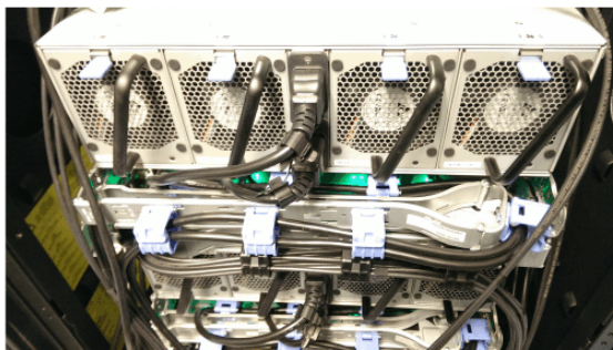
Figure 140. Raccordement des câbles d'alimentation et SAS à l'arrière du boîtier
