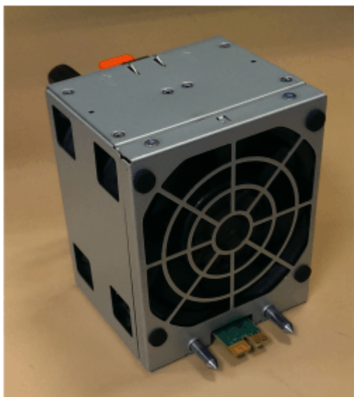
Figure 101. Orientation du module de ventilation
