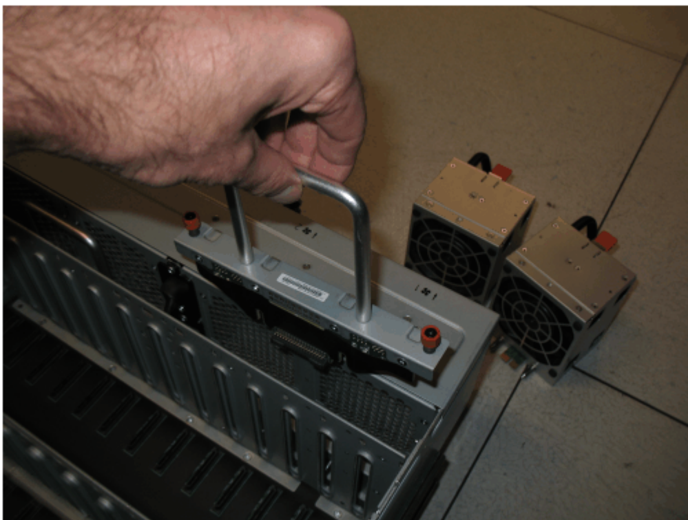
Figure 104. Insérer la nouvelle carte d'interface de ventilateur dans le châssis
