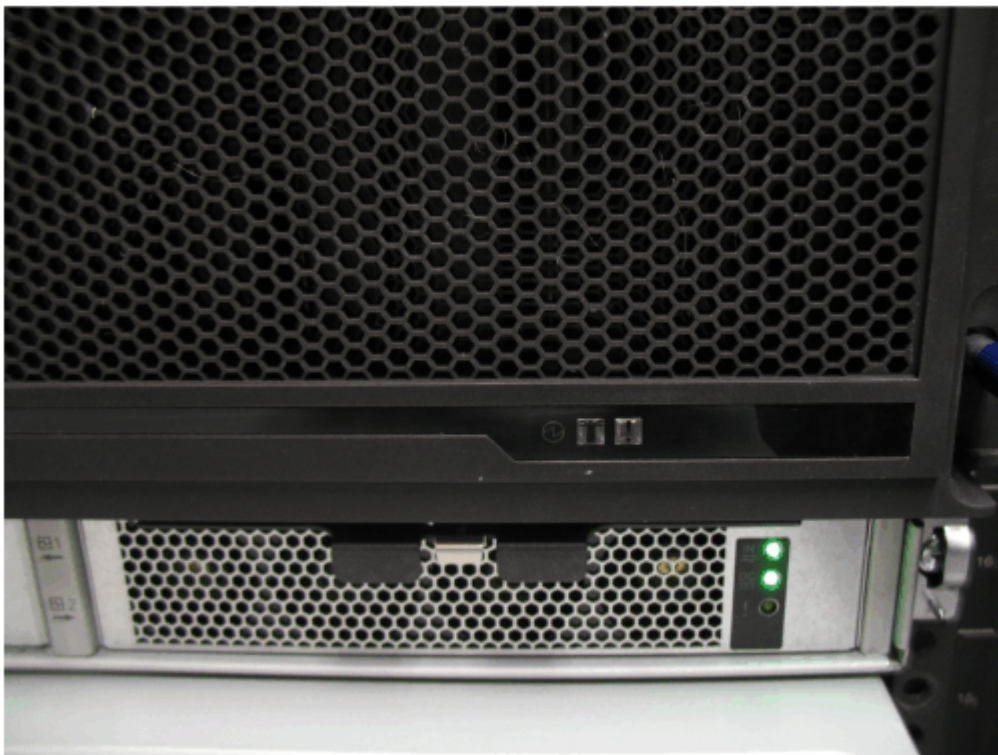
Figure 94. Voyants de l'unité d'alimentation électrique
