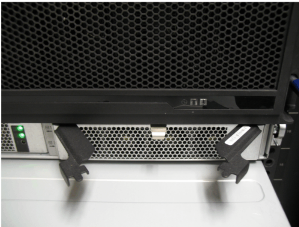
Рисунок 93. Установка блока питания
