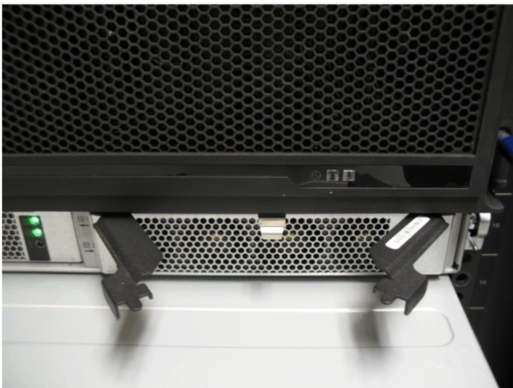
Рисунок 108. Освобождение ручек блока питания
