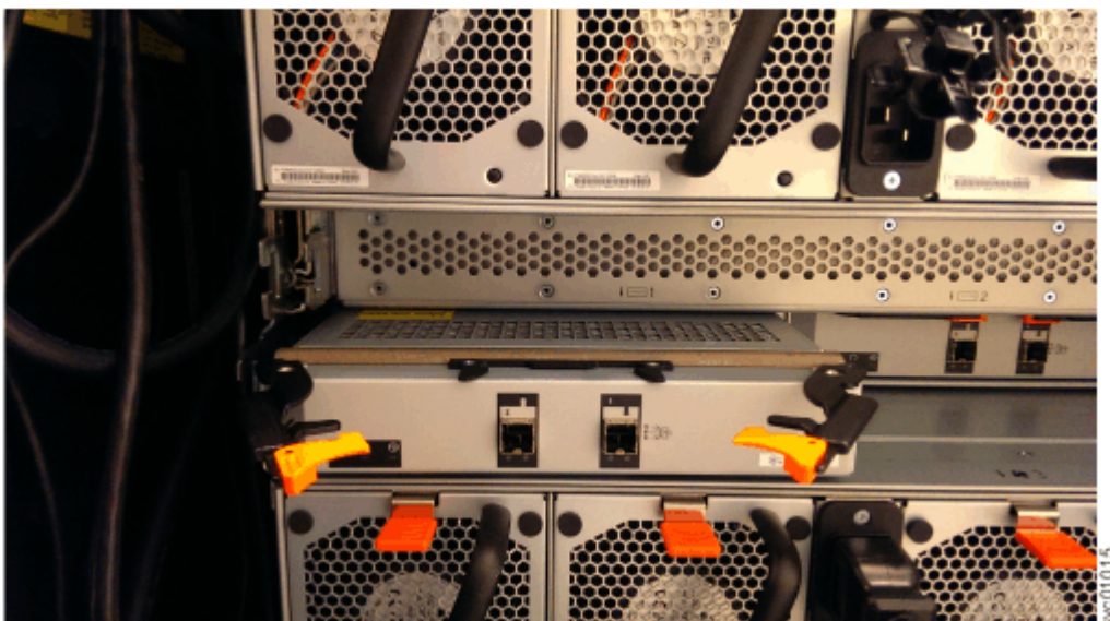
Рисунок 119. Удаление кейса расширения
