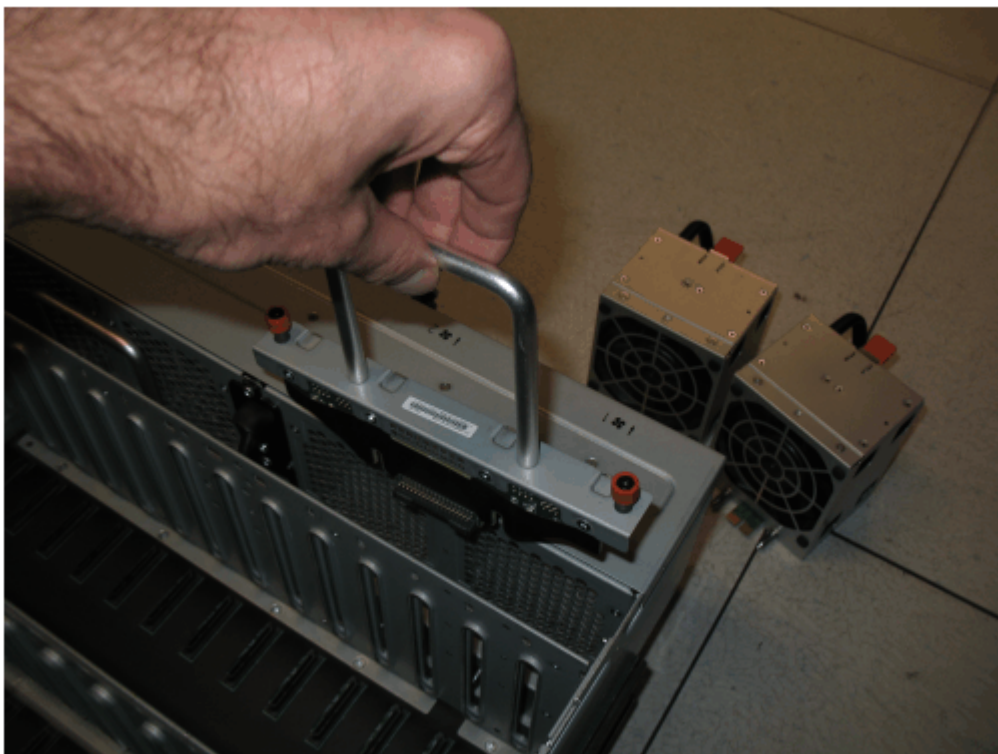
Рисунок 126. Удаление платы интерфейса вентиляции из шасси
