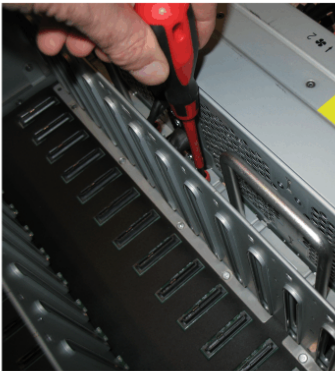
Рисунок 125. Ослабление винтов платы интерфейса вентиляции
