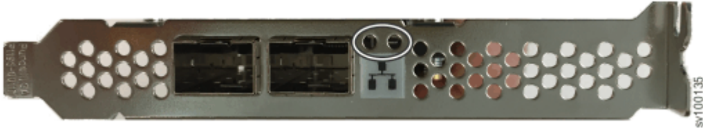
Şekil 12. 25 Gb/sn Ethernet anasistem arabirim bağdaştırıcısı kapıları ve ışıkları (iWARP)
