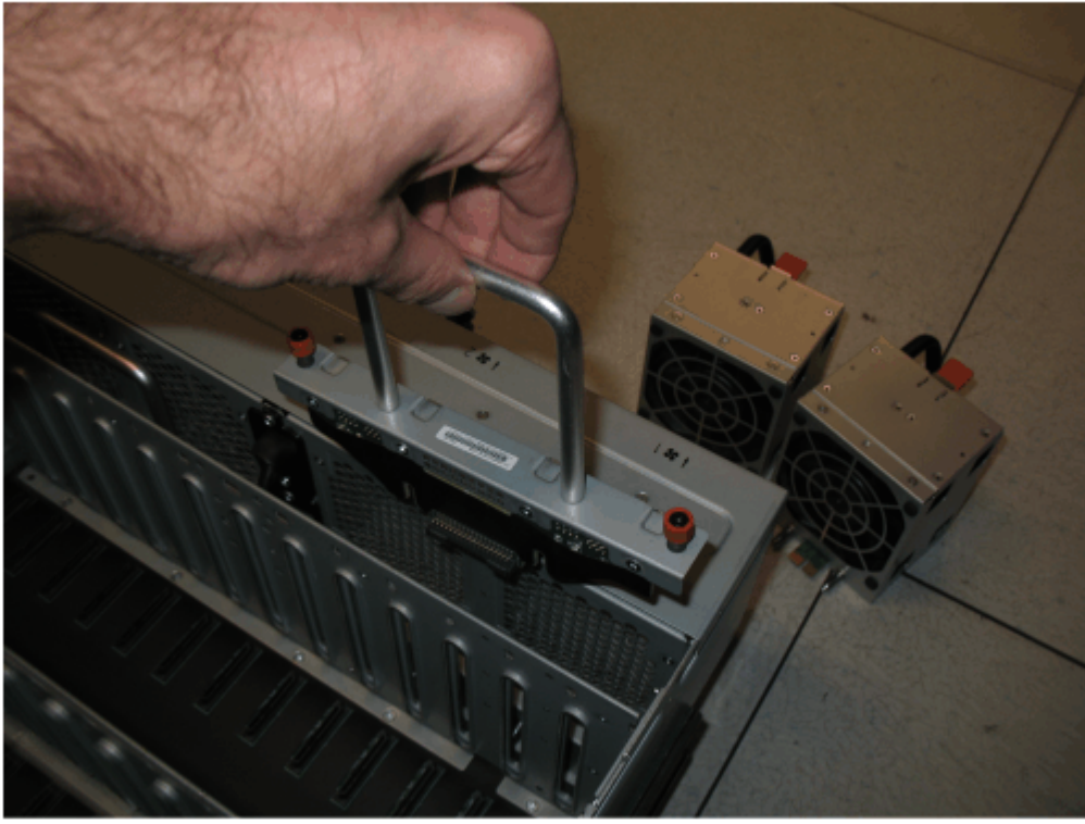
Şekil 104. Yeni FIB'yi gövdeye yerleştirme
