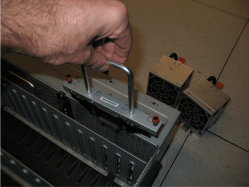
Şekil 126. FIB'yi gövdeden çıkarma
