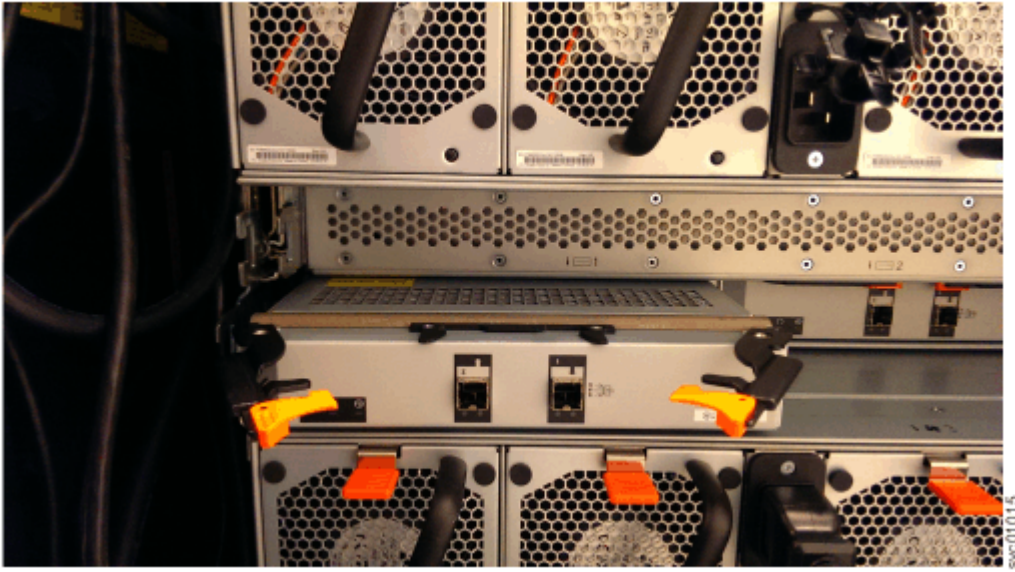
Şekil 119. Genişletme bölmesini çıkarma
