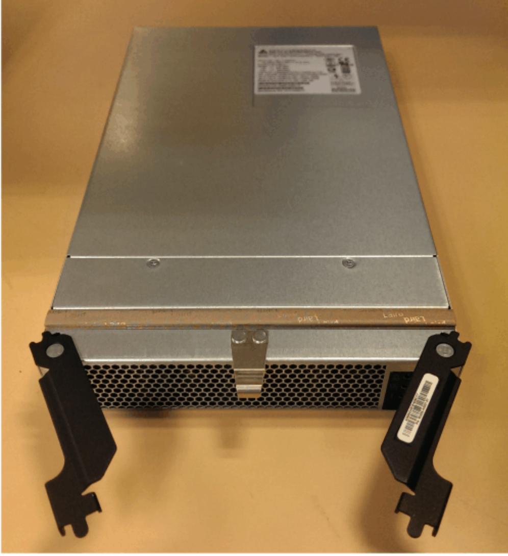
Şekil 109. Çıkarılmış güç kaynağı
