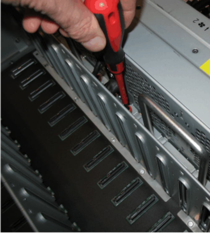
Şekil 125. FIB vidalarını gevşetme
