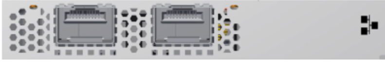
Şekil 11. 25 Gb/sn Ethernet anasistem arabirim bağdaştırıcısı kapıları ve ışıkları (RoCE)
