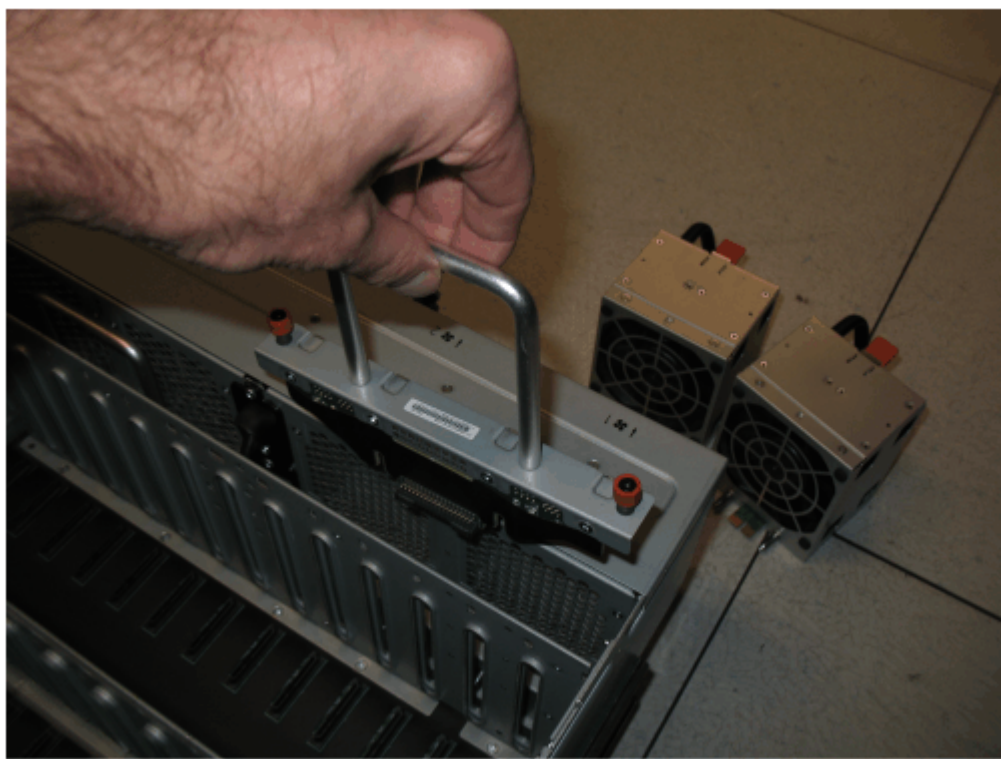
图 104. 在机箱中插入新的 FIB
