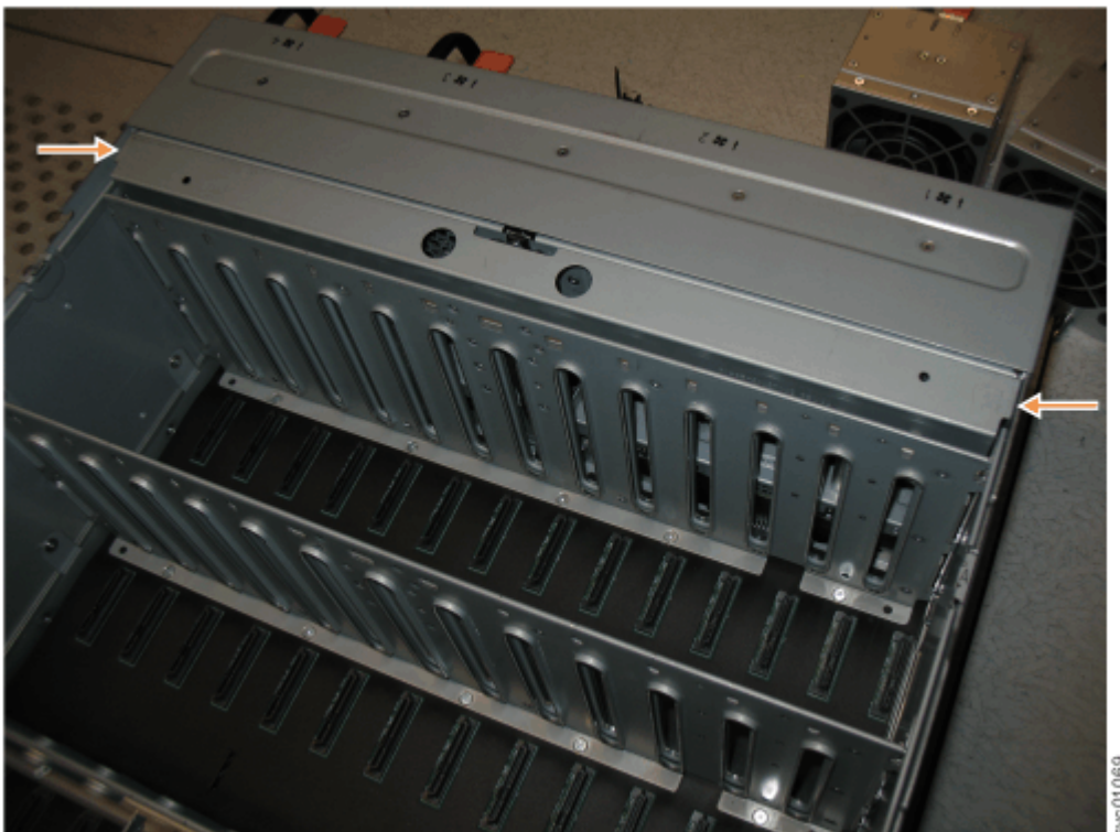
图 106. 重新安装 FIB 外盖
