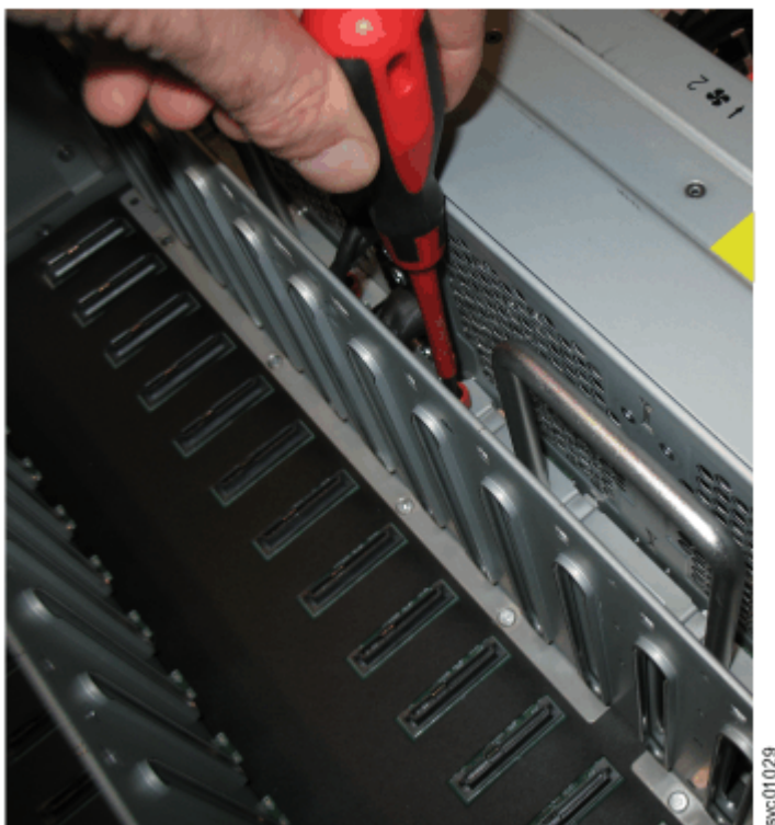
图 125. 拧松 FIB 螺钉
