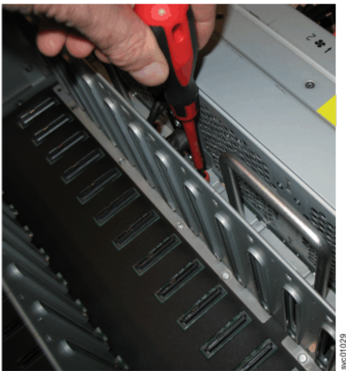
图 105. 将 FIB 固定到驱动器板上
