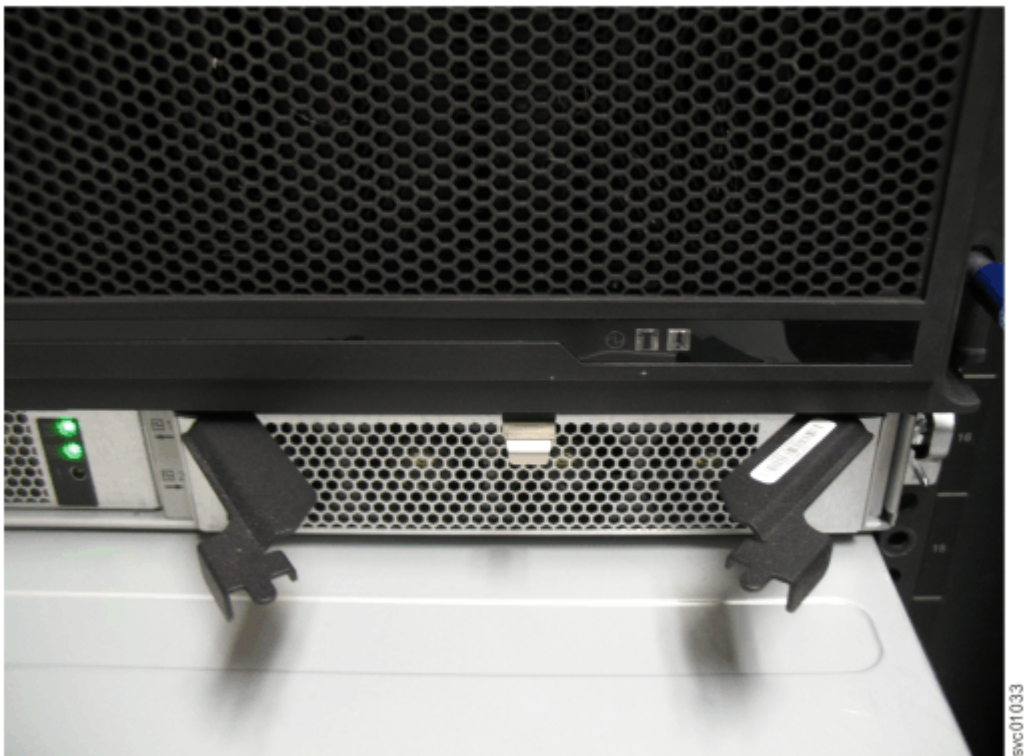
图 93. 安装电源
