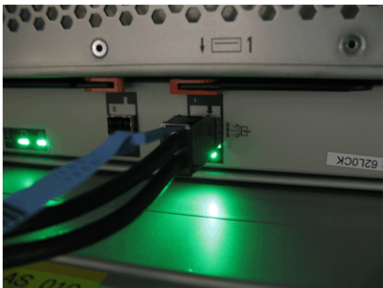
图 100. SAS 电缆已正确插入到 SAS 端口中
