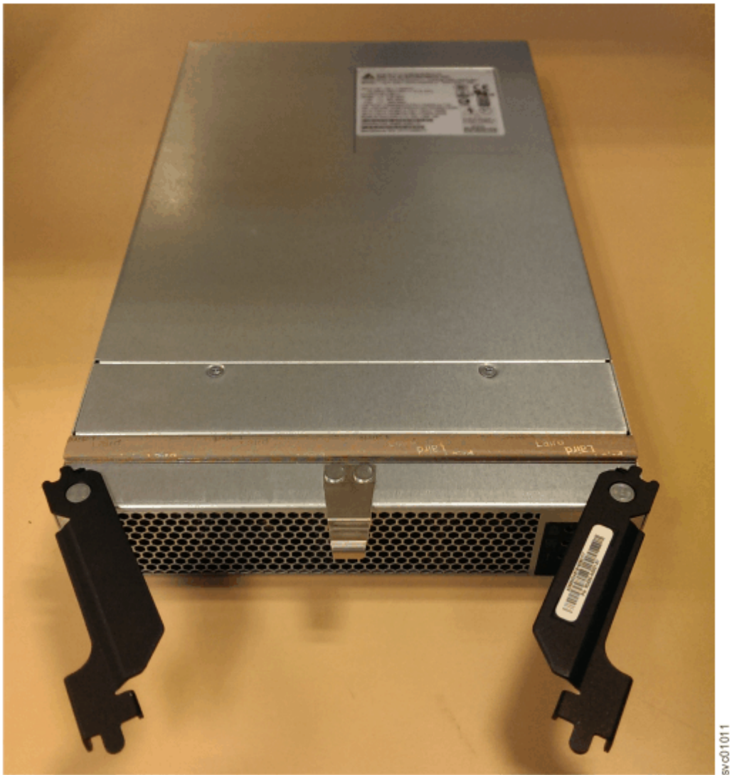
图 92. 准备安装电源
