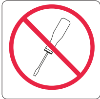
그림 11. 무정전 전원 공급 장치의 사용자 액세스 레이블 없음
