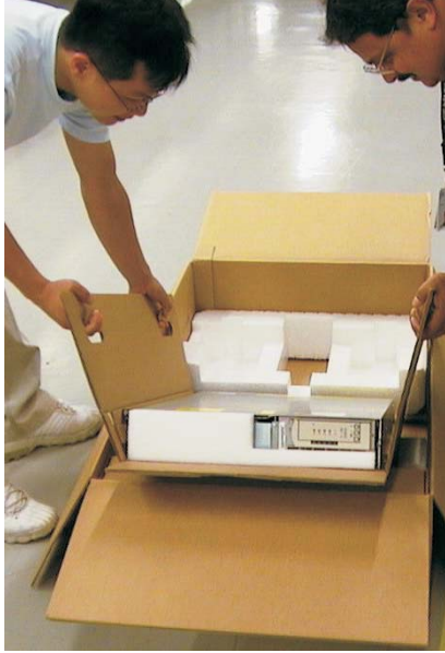
그림 21. 상자 끝쪽으로 무정전 전원 공급 장치 내리기
