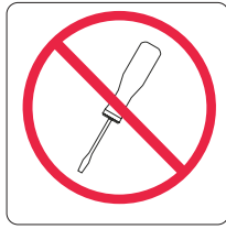
그림 4. SAN Volume Controller의 사용자 액세스 레이블 없음
