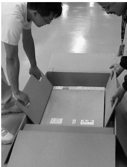
図 73. 2 人で無停電電源装置 5125 を箱から取り出す
