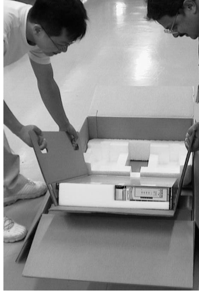
図 74. 無停電電源装置 5125 を箱の端までスライドする
