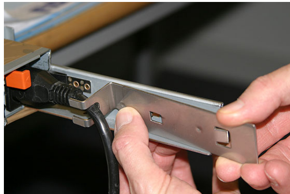
図 18. SAN ボリューム・コントローラー 2145-8F4 電源ケーブルへのケーブル保持ブラケットの取り付け
