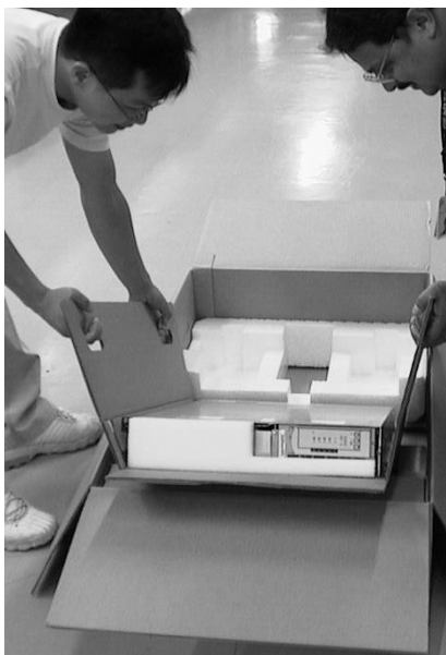
図 30. 2145 UPSをカートンの端へスライドする
