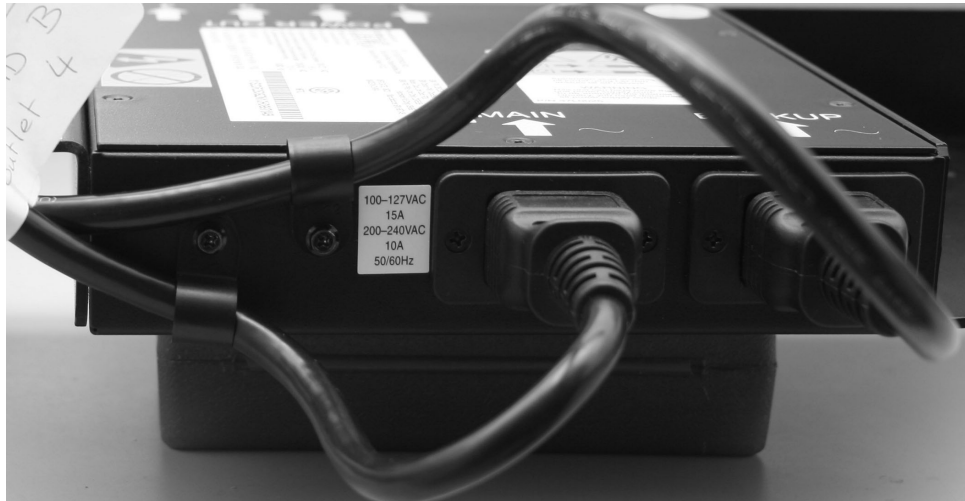
図 15. 電源ケーブル・クリップ
