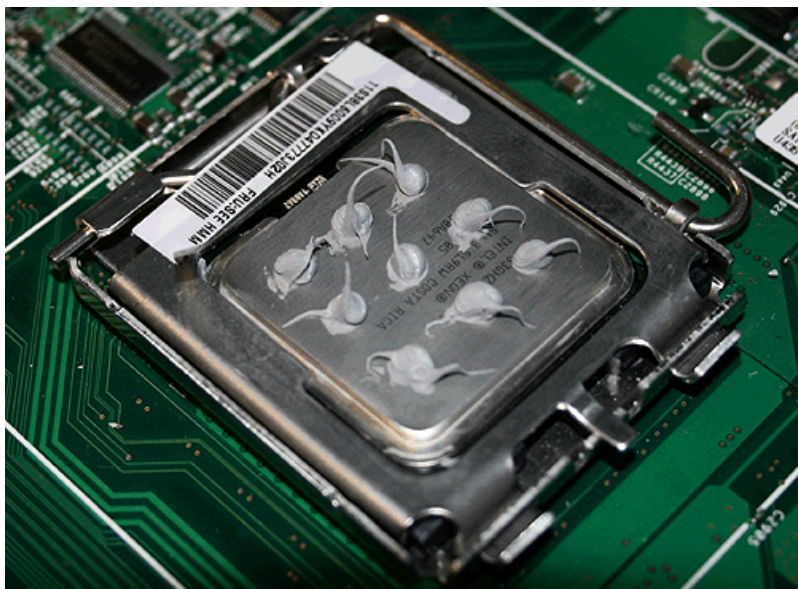
図 288. マイクロプロセッサ上の 9 個の熱伝導グリース・ドットの全セット
