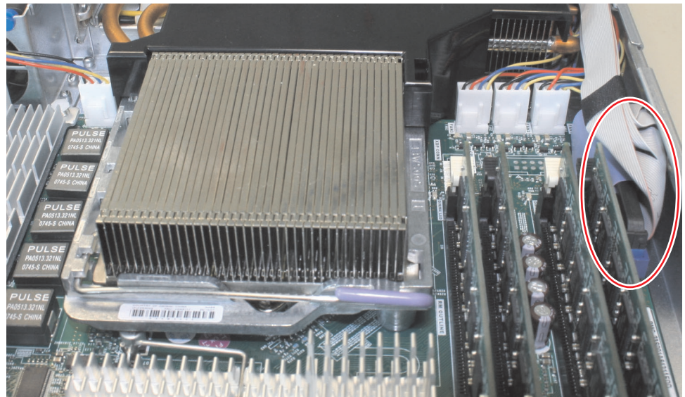
図 268. SAN ポリユーム・コントローラー 2145-8A4 システム・ボードの IDE コネクタ
