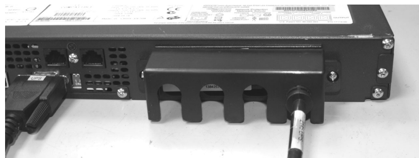
図 309. 2145 UPS-1U に接続された 2145 UPS-1U のケーブル保持ブラケット
