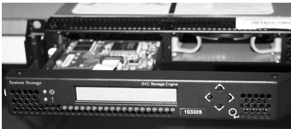
図 90. SAN ポリリューム・コントローラー 2145-8G4 サービス・コントローラー
