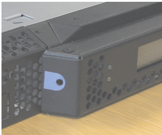
図 82. SAN ボリューム・コントローラー 2145-8A4 サービス・コントローラー解放ボタン
