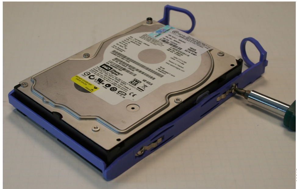
図 112. レール・アセンブリーの SAN ボリューム・コントローラー 2145-8A4 および SAN ボリューム・コントローラー 2145-8G4 用の SATA ディスク・ドライブへの取り付け
