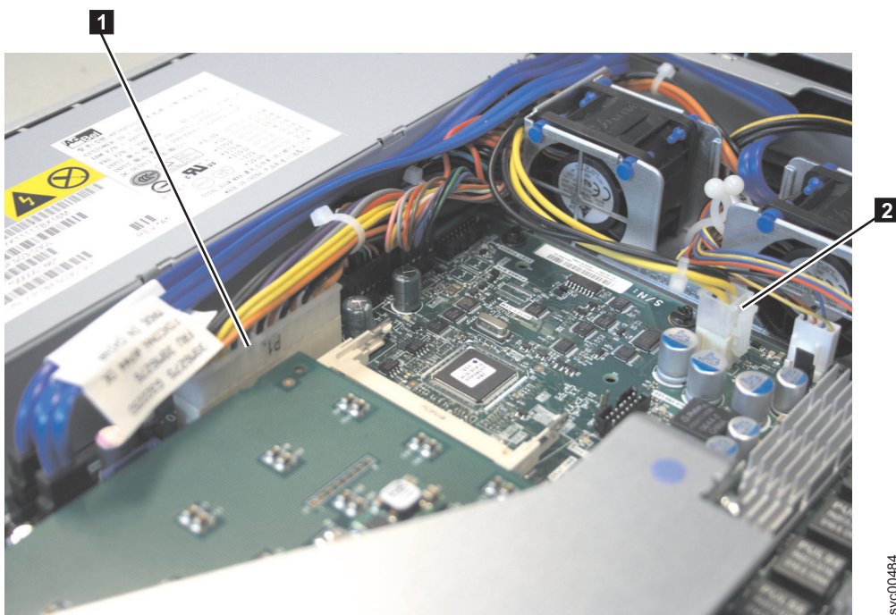
図 160. SAN ボリューム・コントローラー 2145-8A4 システム・ボード上の SATA コネクター
