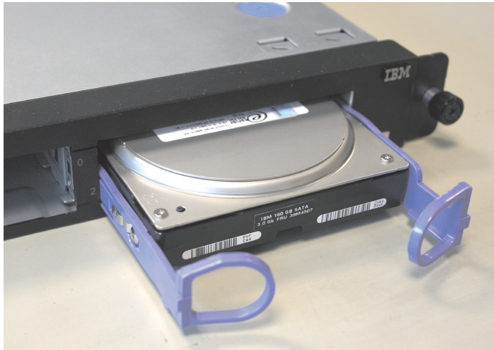
図 108. SAN ボリューム・コントローラー 2145-8A4 SATA ディスク・ドライブ
