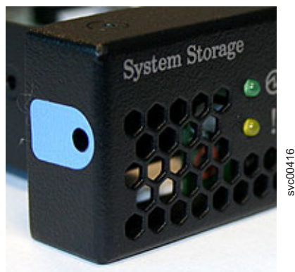
図 83. SAN ボリューム・コントローラー 2145-8G4 サービス・コントローラー解放ボタン
