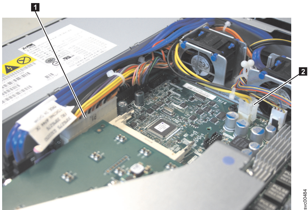
図 151. SAN ボリューム・コントローラー 2145-8A4 システム・ボード上の SATA コネクター
