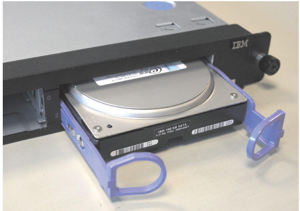
図 101. SAN ボリューム・コントローラー 2145-8A4 SATA ディスク・ドライブ
