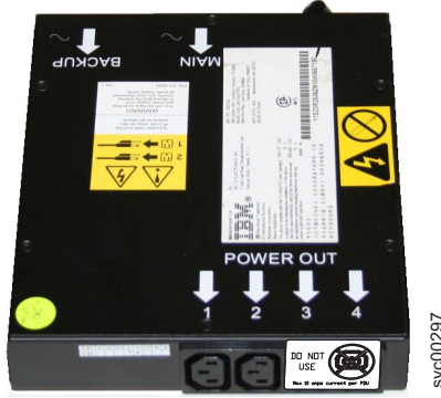
Şekil 1. Yedek AC gücü anahtarının fotoğrafı
