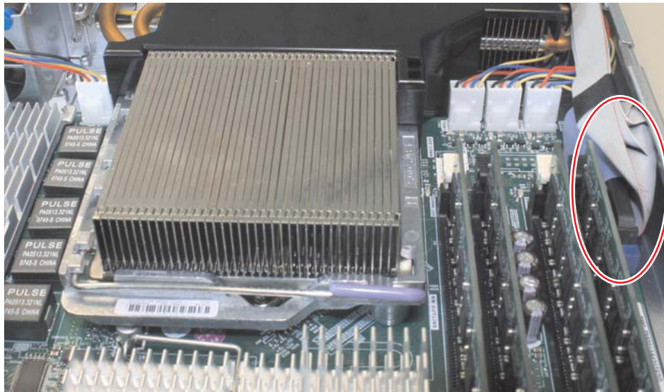
図 278. SAN ボリューム・コントローラー 2145-8A4 システム・ボード上の IDE コネクター
