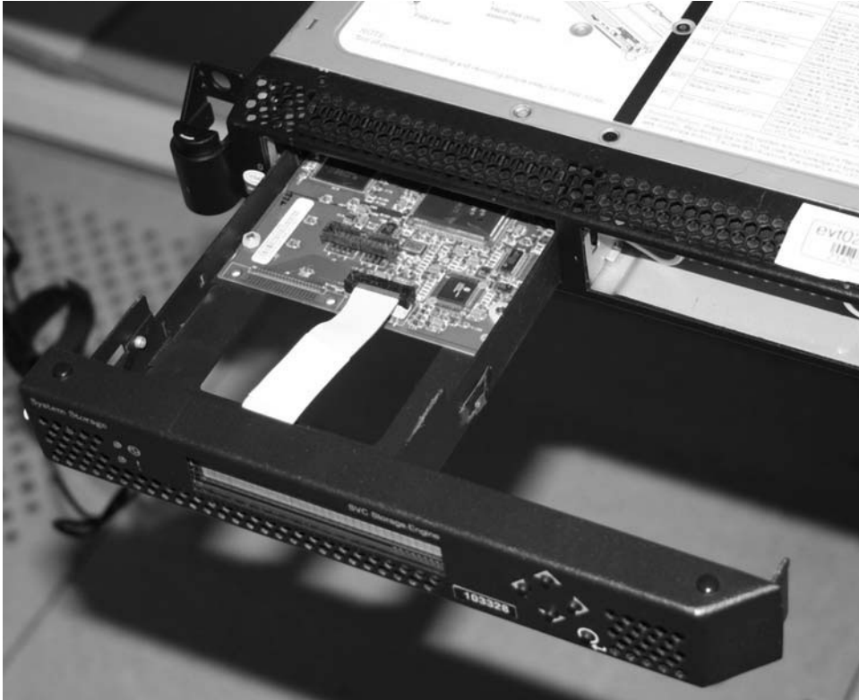
図 81. SAN ボリューム・コントローラー 2145-8G4 からのサービス・コントローラーの取り外し
