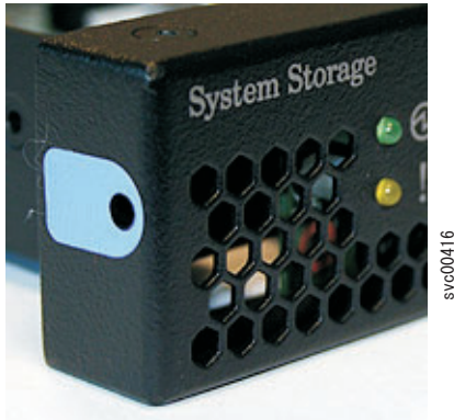
図 80. SAN ボリューム・コントローラー 2145-8G4 サービス・コントローラー解放ボタン
