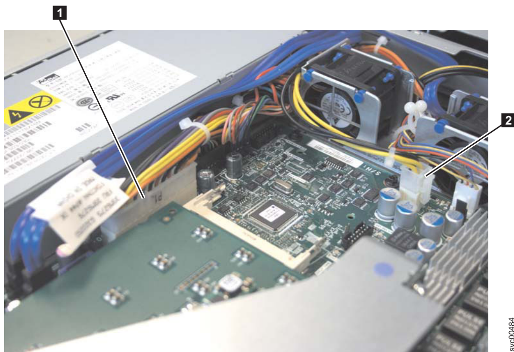
図 149. SAN ボリューム・コントローラー 2145-8A4 システム・ボード上の SATA コネクタ
