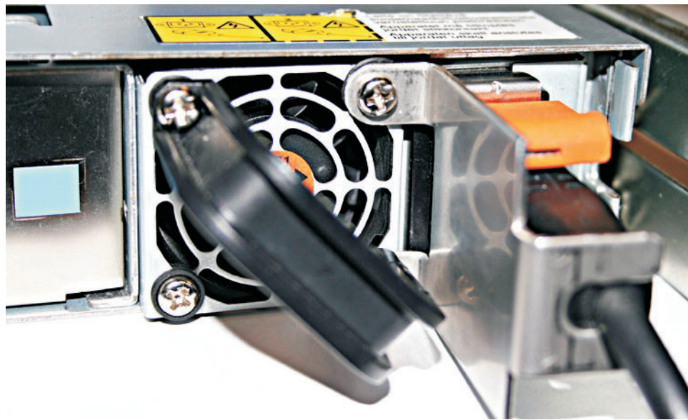
図 22. ケーブル保持ブラケットが取り付けられている SAN ボリューム・コントローラー 2145-8G4
