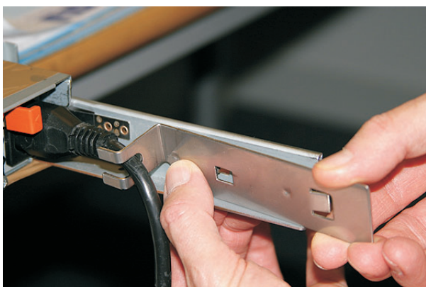
図 32. SAN ボリューム・コントローラー 2145-8F4 電源ケーブルへのケーブル保持ブラケットの取り付け
