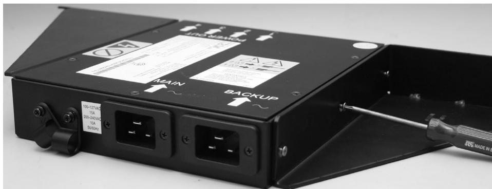
図 304. 取り付けプレートの取り付け
