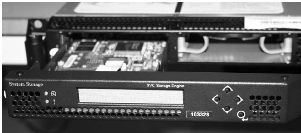
図 87. SAN ポリリューム・コントローラー 2145-8G4 サービス・コントローラー
