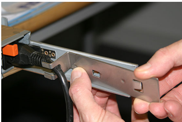
그림 31. 케이블 보존 브래킷을 SAN Volume Controller 2145-8F4 전원 케이블에 연결
