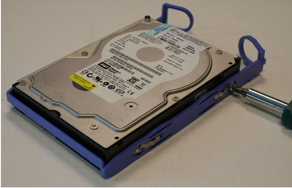
그림 107. SAN Volume Controller 2145-8A4 및 SAN Volume Controller 2145-8G4의 SATA 디스크 드라이브에 레일 조립품 연결
