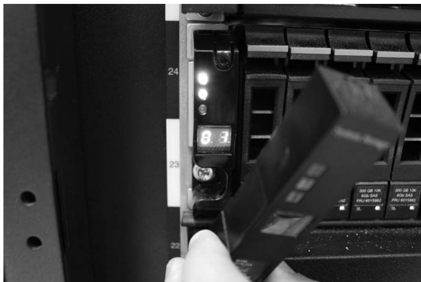
图 10. 卸下机柜端盖
