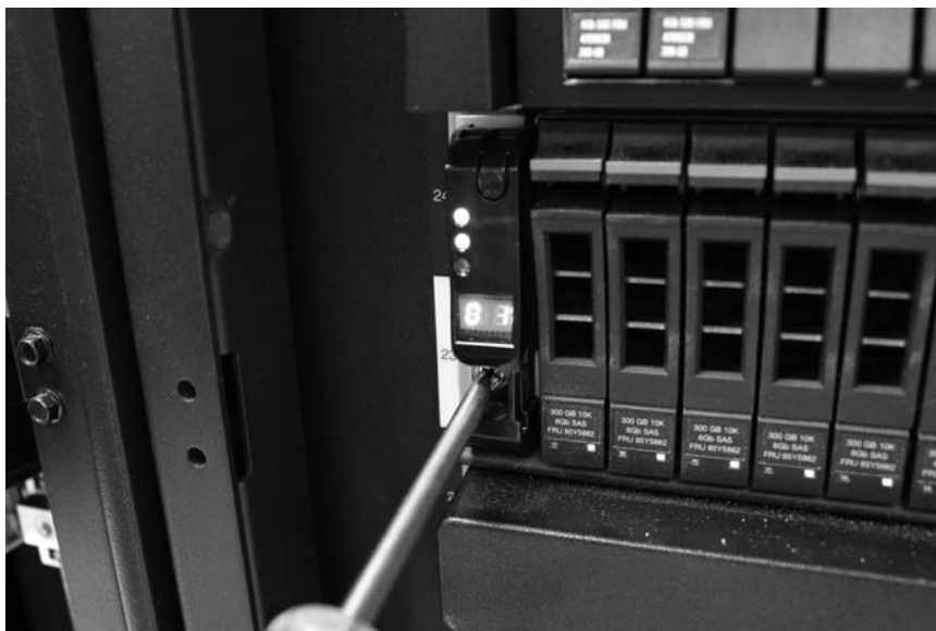
图 11. 将机柜固定到机架式机箱上
