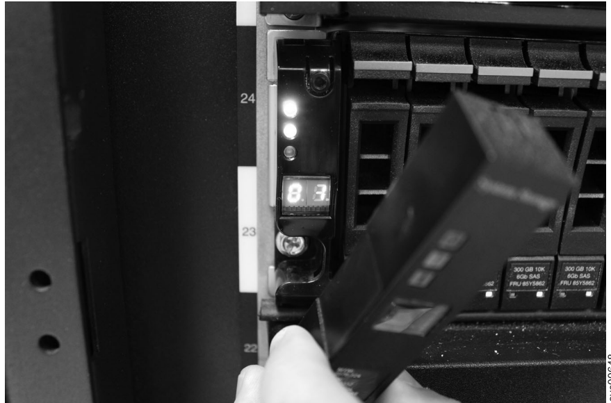
図 10. エンクロージャー・エンド・キャップの取り外し
