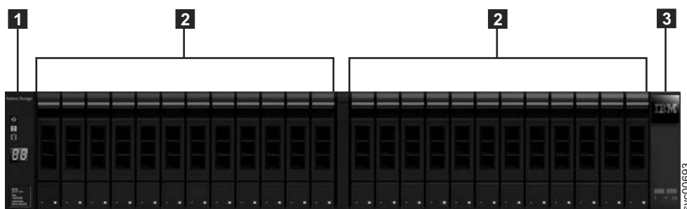
Abbildung 41. 24 Laufwerke und zwei Abschlusskappen
