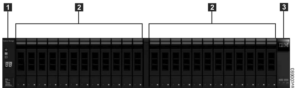
Abbildung 2. Diese Abbildung zeigt 24 Laufwerke und zwei Abschlusskappen (Modell 2076-124).
