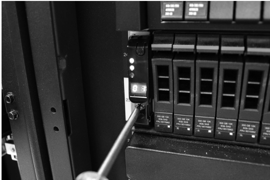
Figure 11. Fixation d'un boîtier à une armoire
