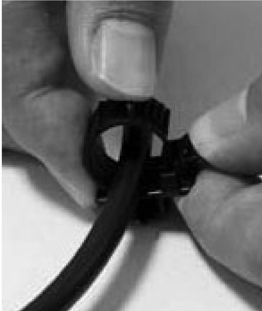
Figure 39. Libération du support de fixation du câble
