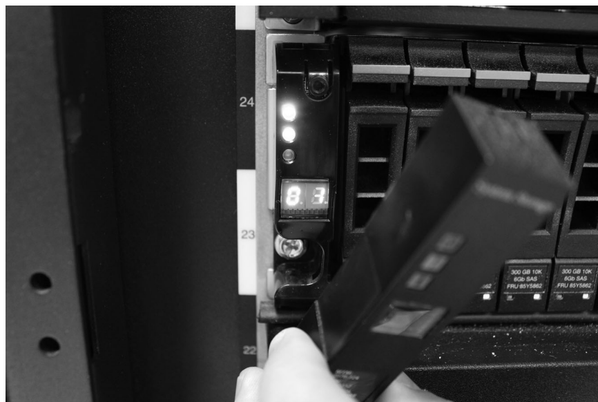
Figure 14. Retrait du cache du boîtier
