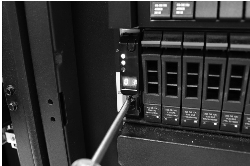
図 14. ラック・キャビネットへのエンクロージャーの固定
