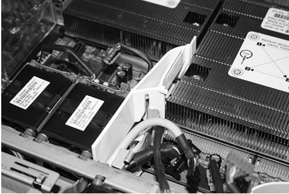
그림 280. SAN Volume Controller 2145-8G4의 왼쪽 에어 배플
