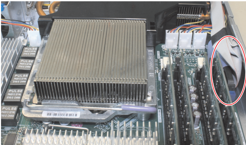
그림 276. SAN Volume Controller 2145-8A4 시스템 보드의 IDE 커넥터
