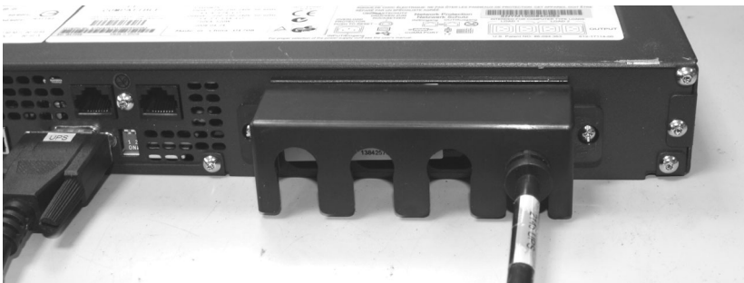
그림 318. 2145 UPS-1U에 연결된 2145 UPS-1U 케이블 고정 브래킷
