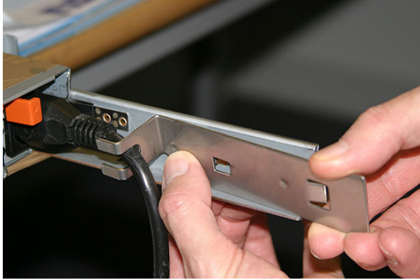
그림 31. 케이블 고정 브래킷을 SAN Volume Controller 2145-8F4 전원 케이블에 연결
