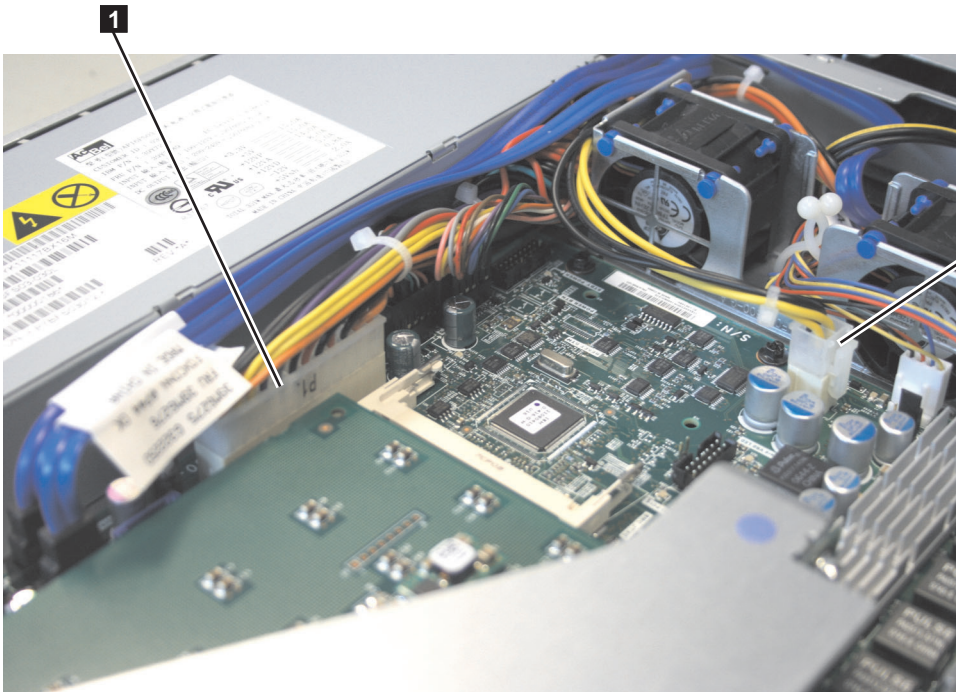
그림 156. SAN Volume Controller 2145-8A4 시스템 보드의 SATA 컨트롤러
