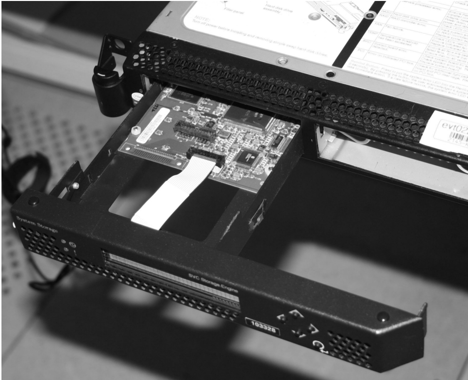
그림 79. SAN Volume Controller 2145-8G4에서 서비스 제어기 제거
