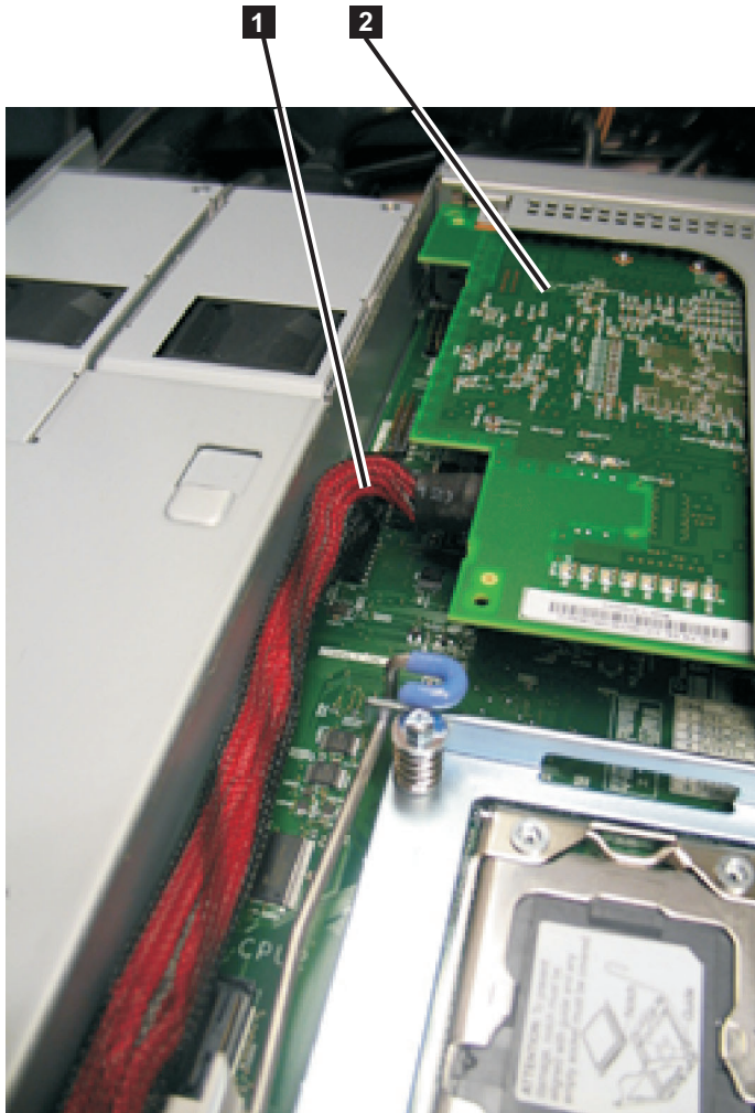
그림 199. SAN Volume Controller 2145-CG8 또는 2145-CF8의 고속 SAS 어댑터 조립품 및 고속 SAS 케이블
