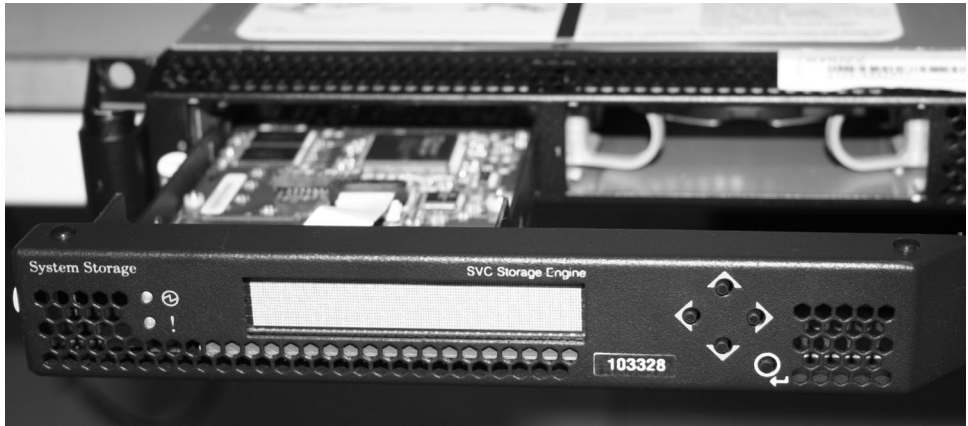
그림 85. SAN Volume Controller 2145-8G4 서비스 제어기
